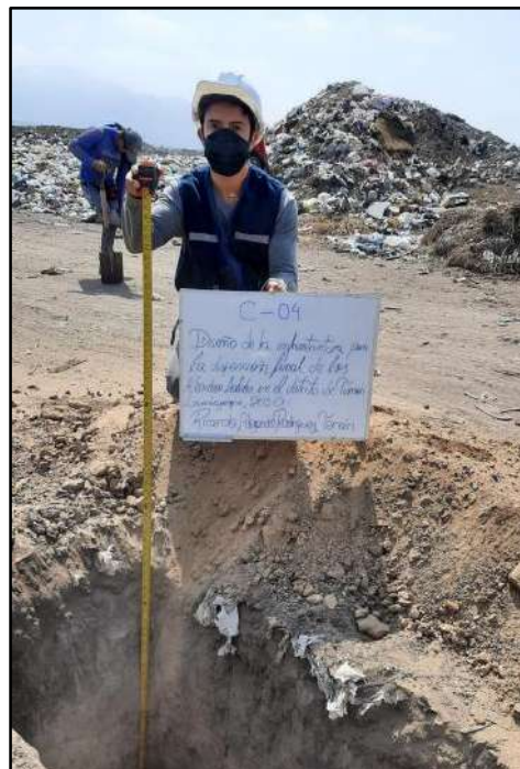
Fotografía N° 16: Excavación de Calicata N° 04
