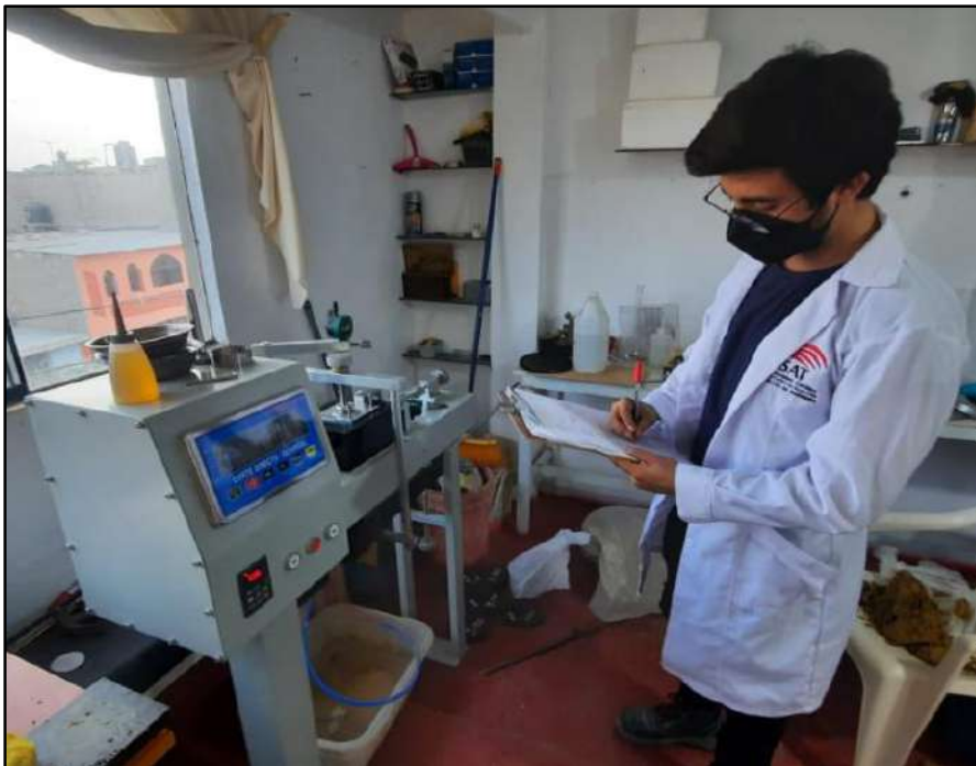
Fotografía N° 30: Realizando la toma de resultados del Ensayo de Corte Directo
