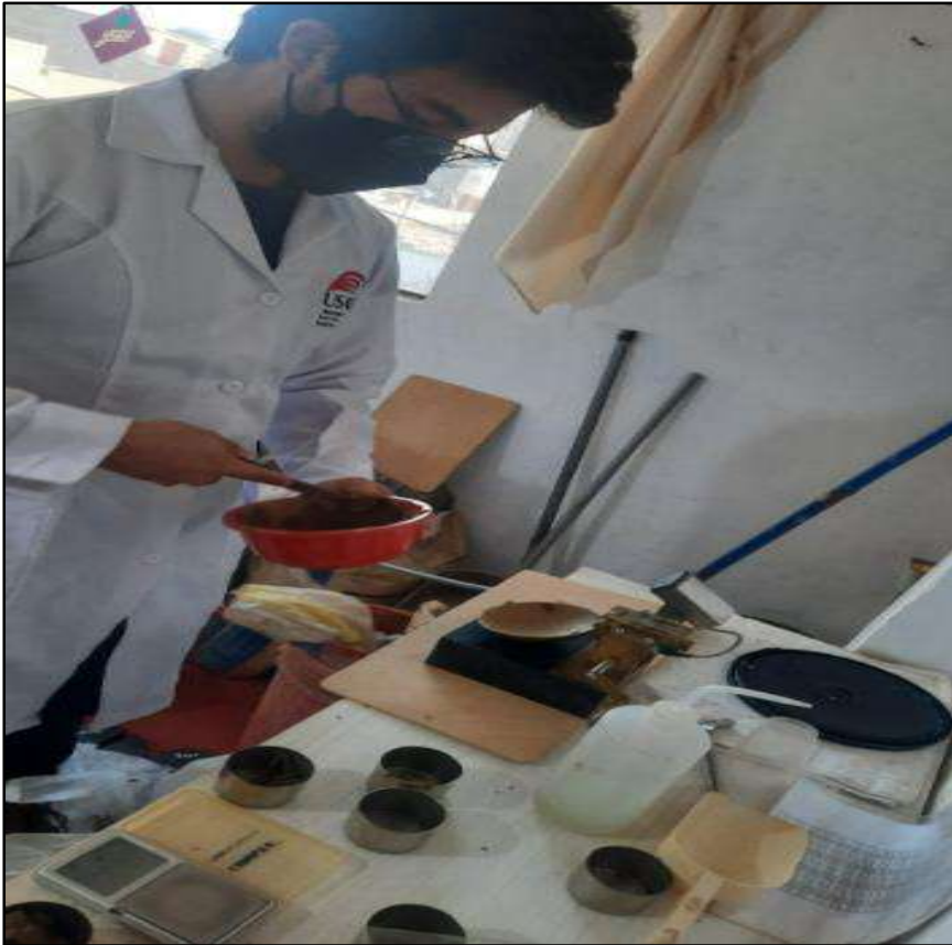
Fotografía N° 29: Realizando el ensayo de Limite Plástico
