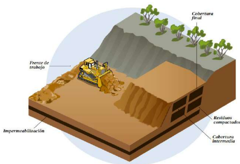
Figura 3: Ilustración de Relleno Sanitario de tipo Mecanizado
