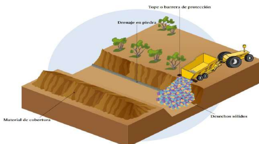
Figura 2: Ilustración de Relleno Sanitario Semi Mecanizado
