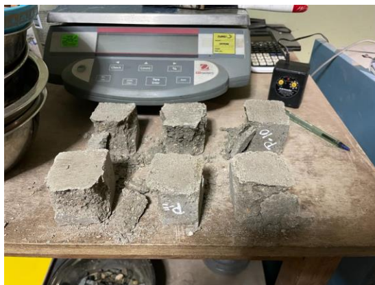
Imagen 27 Rotura a la compresión de los especímenes cúbicos
