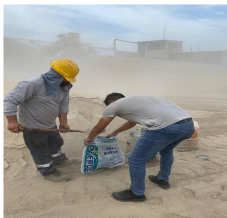
Imagen 9 Obteniendo muestras de agregado fino
