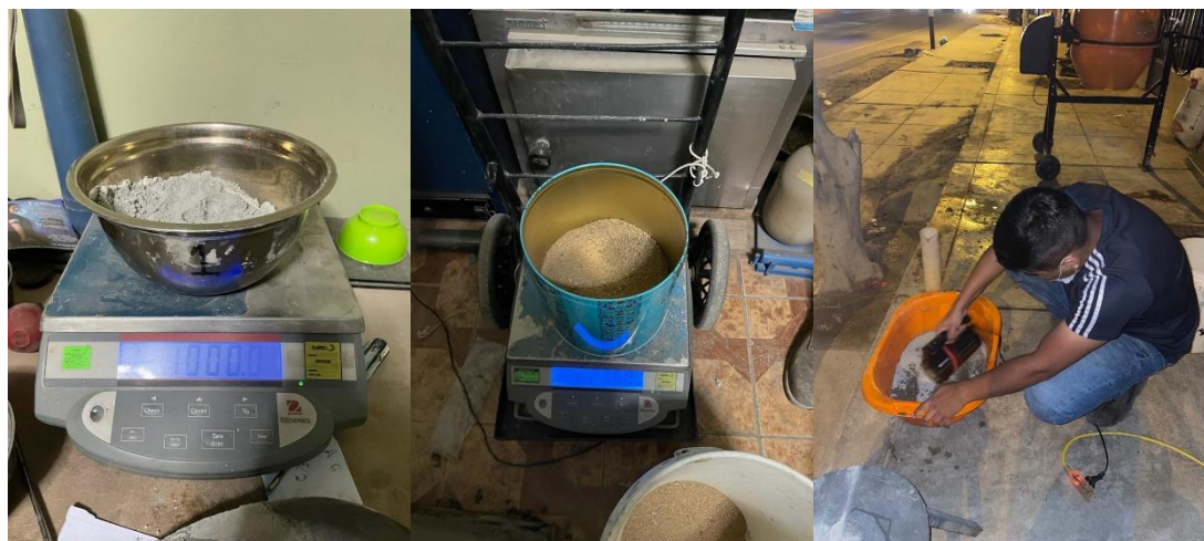
Imagen 20 Elaboración de mortero patrón
