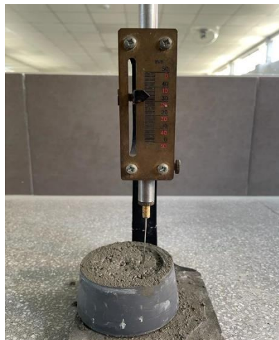
Imagen 24 Procedimiento para el tiempo de fraguado final
