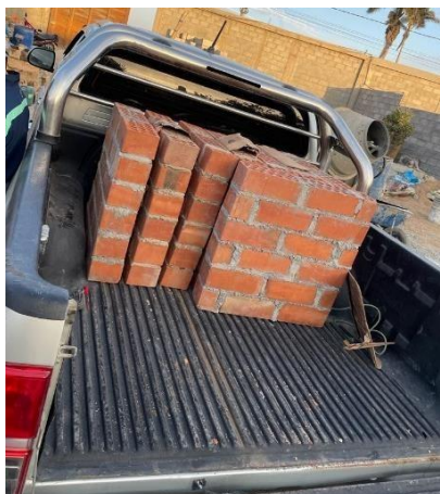
Imagen 53 Transporte de los muretes hacia el ensayo
