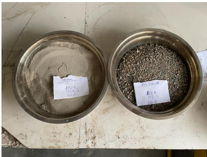
Imagen 10 Resultados obtenidos del contenido de humedad de residuo triturado fino y grueso
