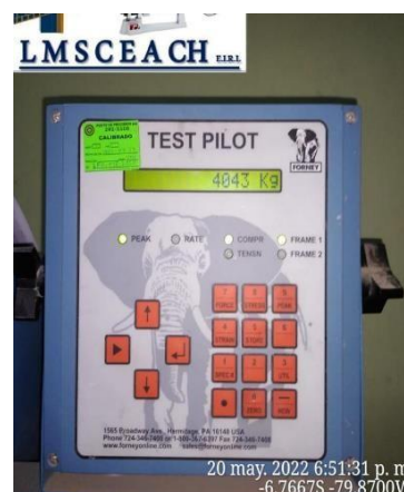
Imagen 43 Carga resistida del MP a la edad de 28 días
