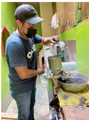
Imagen 7 Molienda a mano de ceniza de bagazo de caña de azúcar
