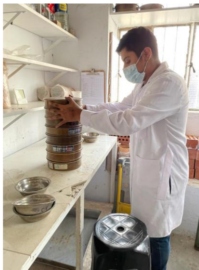
Imagen 12 Tesista realizando el ensayo de granulometría al residuo triturado
