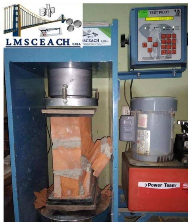
Imagen 60 Pila con MP-5%CBCA alcanzo una f'm=23324 kg
