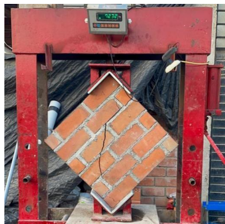
Imagen 56 Murete con MP y %5CBCA alcanzo V'm=7232 kg
