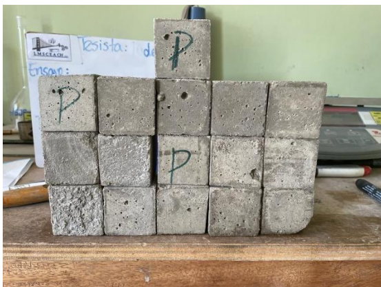
Imagen 26 Especímenes cúbicos del mortero patrón
