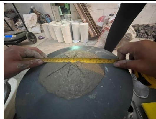
Imagen 35 Tesista realizando la medida del diámetro del mortero para hallar el porcentaje de fluidez
