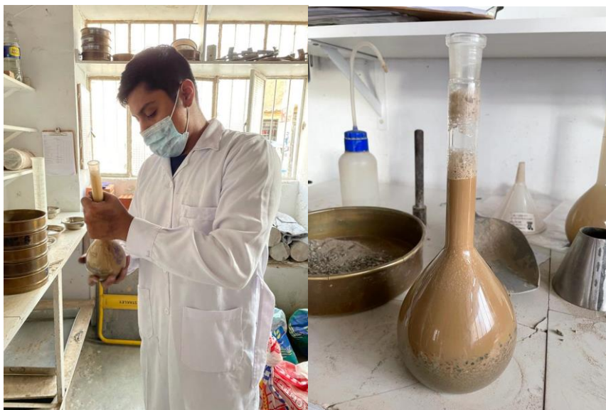
Imagen 13 Procedimiento para quitar el excedente de vacíos de la muestra residuo triturado grueso
