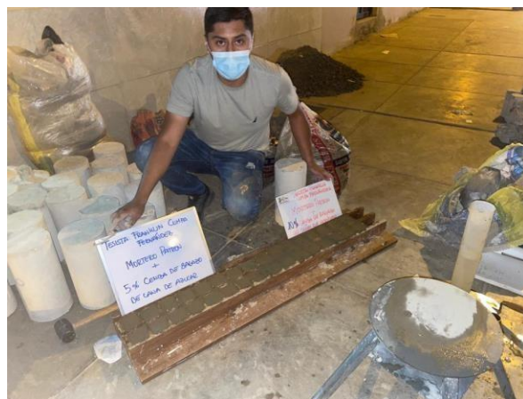
Imagen 39 Tesista con los especímenes cúbicos de MP con 5 y 10%CBCA
