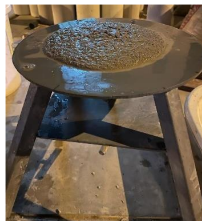
Imagen 33 Mortero ensayado en la mesa de fluidez
