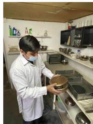
Imagen 6 Procedimiento del tamizado por la malla N°200
