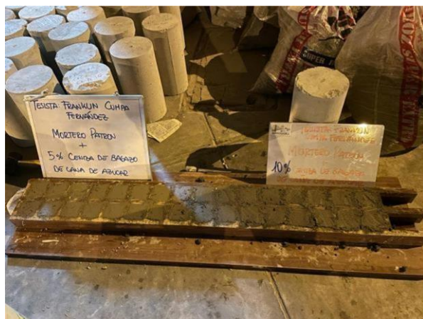
Imagen 39 Tesista con especímenes cúbicos de Mortero con RTPC y con los porcentajes del 5, 10, 15 y 20%CBCA
