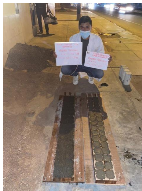
Imagen 41 Tesista con especímenes cúbicos de Mortero con RTPC y con los porcentajes del 5, 10, 15 y 20%CBCA
