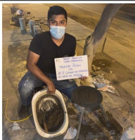
Imagen 34 Tesista realizando el ensayo de fluidez
