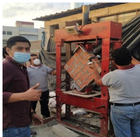
Imagen 54 Tesista a punto de realizar el ensayo a la compresión diagonal del murete
