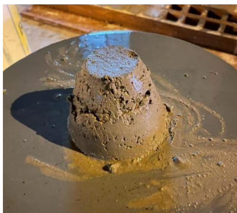
Imagen 32 Mortero para realizar el ensayo de fluidez
