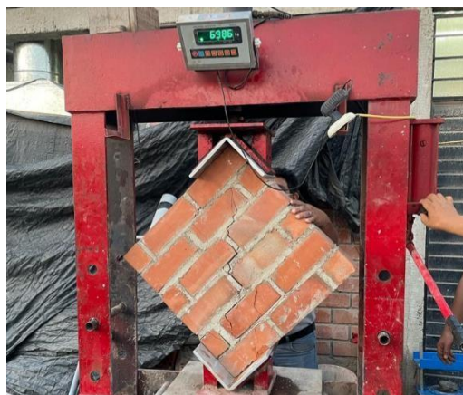
Imagen 55 Murete con MP alcanzo V'm=6986 kg
