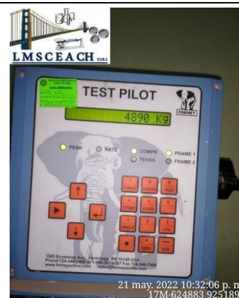
Imagen 45 Carga resistida del MP-5%CBCA a la edad de 28 días
