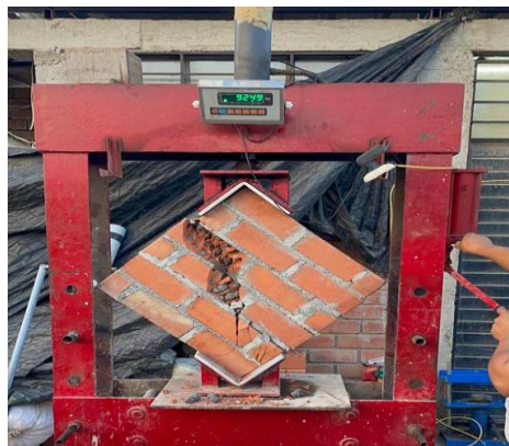
Imagen 31 Ensayo de resistencia a la compresión diagonal de murete de albañilería
