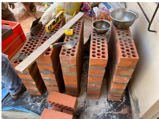
Imagen 30 Muestras de murete de albañilería
