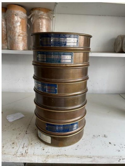
Imagen 11 Tamices normalizados para agregado fino
