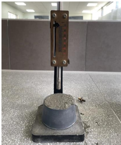
Imagen 25 Procedimiento para el tiempo de fraguado inicial
