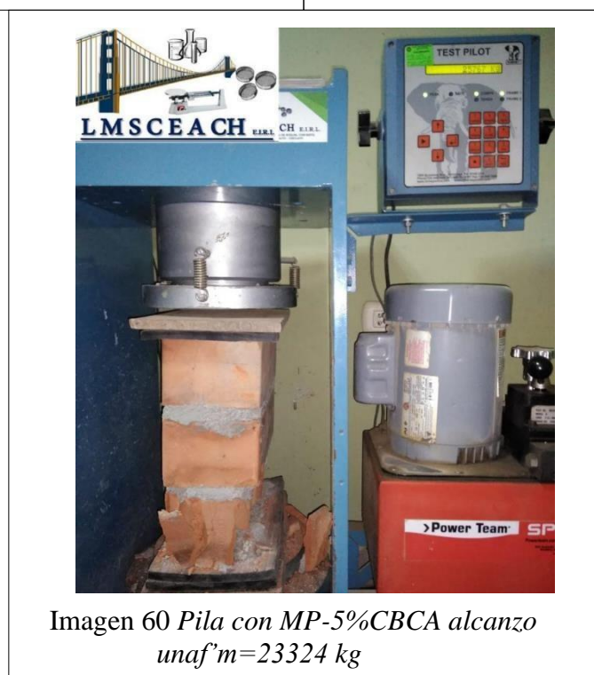
Imagen 60 Pila con MP-5%CBCA alcanzo una f'm=23324 kg
