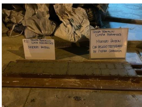
Imagen 37 Especímenes cúbicos de MP y Mortero RTPC
