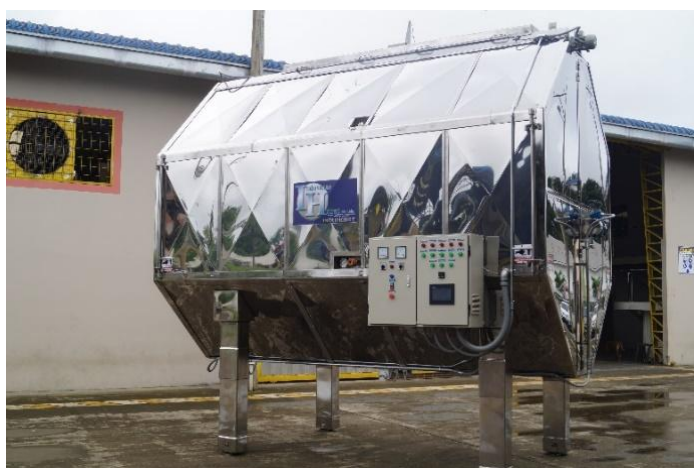
Ilustración 2: Añejadora de arroz con horno eléctrico
