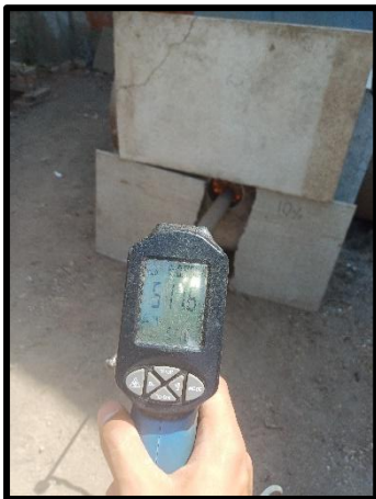
Anexo 25: Muretes de 60x60cm de mortero patrón sometidos a 500°C y 750°C
