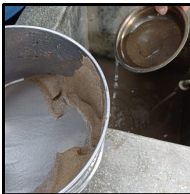
Figura 4: Lavado por la malla N°200
