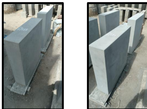
Figura 28: Muretes para micro fisuras mortero patrón
