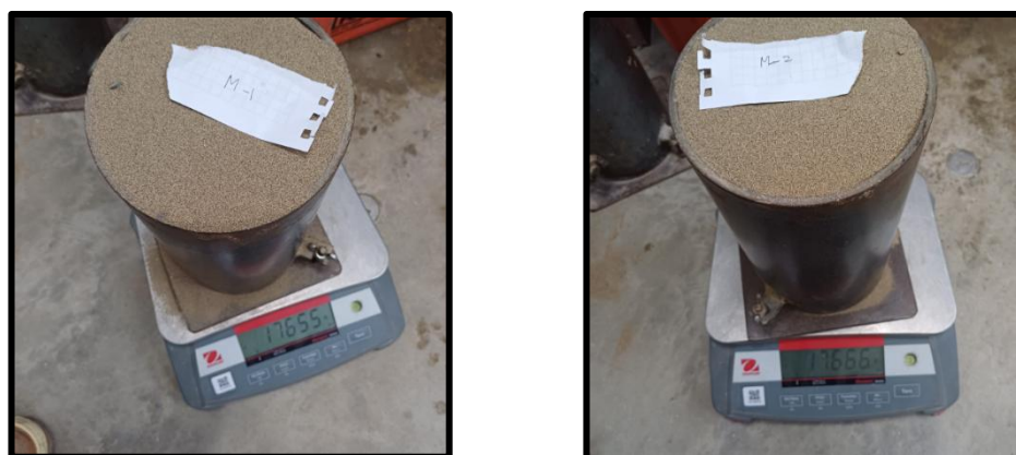
Figura 8: Peso de agregado fino para ensayo de peso unitario suelto seco
