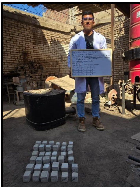
Anexo 19: Especímenes para ensayo de resistencia a compresión expuestos al fuego en un horno artesanal a diferentes rangos de temperatura
