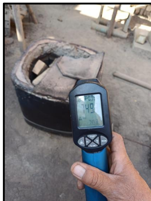
Anexo 16: Temperatura de 750°C alcanzada en los especímenes de resistencia a compresión a los 10 minutos
