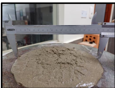
Figura 32: Mezcla y colocación de mortero en mesa de fluidez
