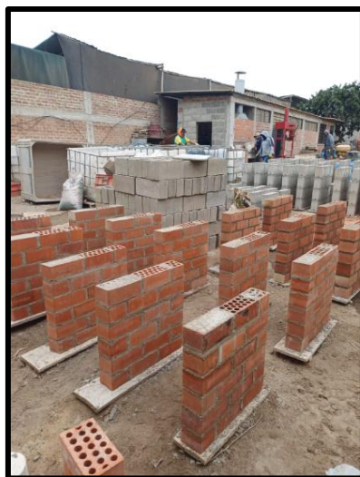
Figura 45: Muretes asentados antes de tarrajear con mortero patrón y con adición de vermiculita expandida
