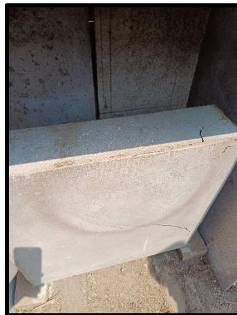
Anexo 25: Muretes de 60x60cm de mortero patrón sometidos a 500°C y 750°C
