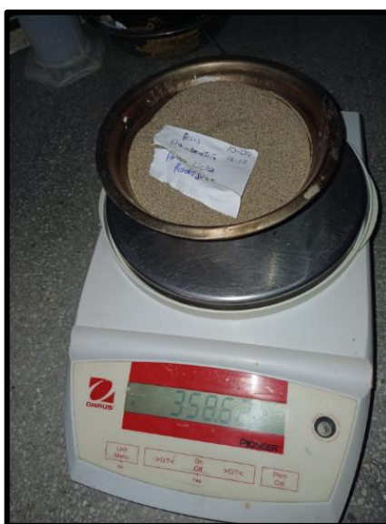
Figura 6: Muestra seca puesta en balanza
