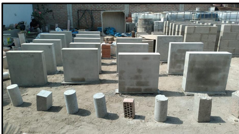
Figura 46: Muretes con recubrimiento de mortero patrón y con adición de vermiculita expandida
