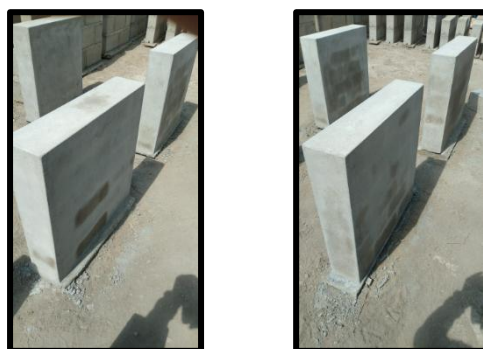
Figura 31: Muretes para micro fisuras con adición de 7.5%
