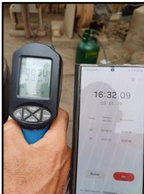
Anexo 17: Temperatura de 1000°C alcanzada en los especímenes de resistencia a compresión a los 18 minutos
