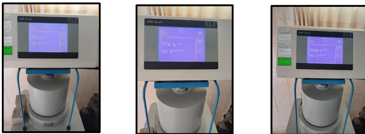
Figura 18: Muestra N°01, N°02 y N°03 mortero con 2.5% de adición a 3 días
