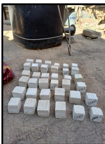
Figura 27: Especímenes de 0%, 2.5%, 5% y 7.5% antes de ser sometidos en un horno artesanal a diferentes rangos de temperatura (500°C y 750°C y 1000°C)
