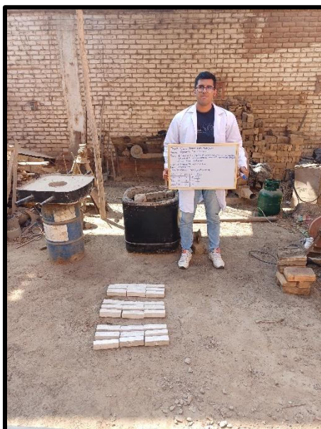
Anexo 20: Exposición al fuego de especímenes de 4x4x16cm para posterior ensayo de resistencia a la flexión a diferentes rangos de temperatura
