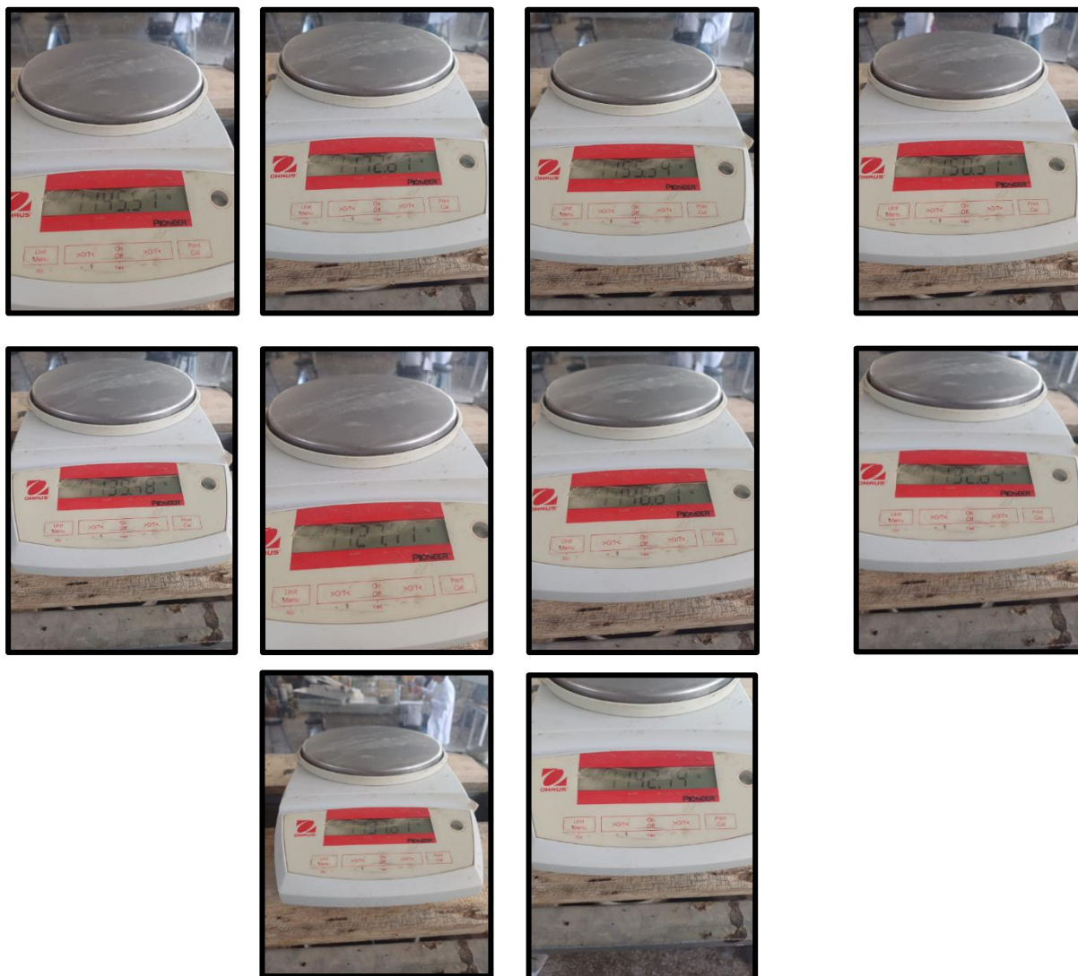
Figura 36: Peso de muestras sumergidas al agua de mortero con 2.5% de adición (A)
