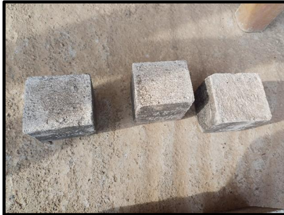
Anexo 36: Panel fotográfico del ensayo de durabilidad aplicando fenolftaleína a los especímenes de mortero sometidos a 750°C
