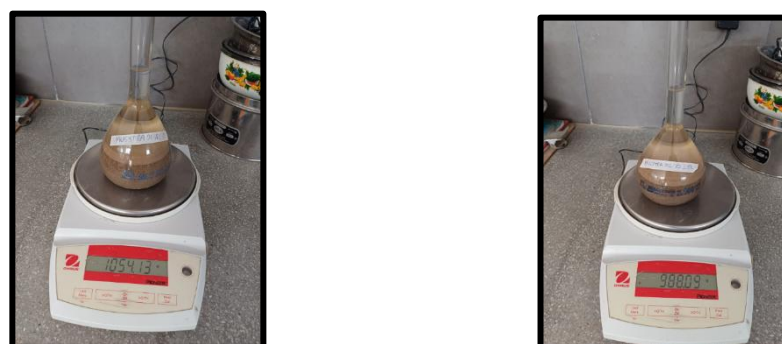
Figura 13: Peso de muestra saturada, agua y frasco
