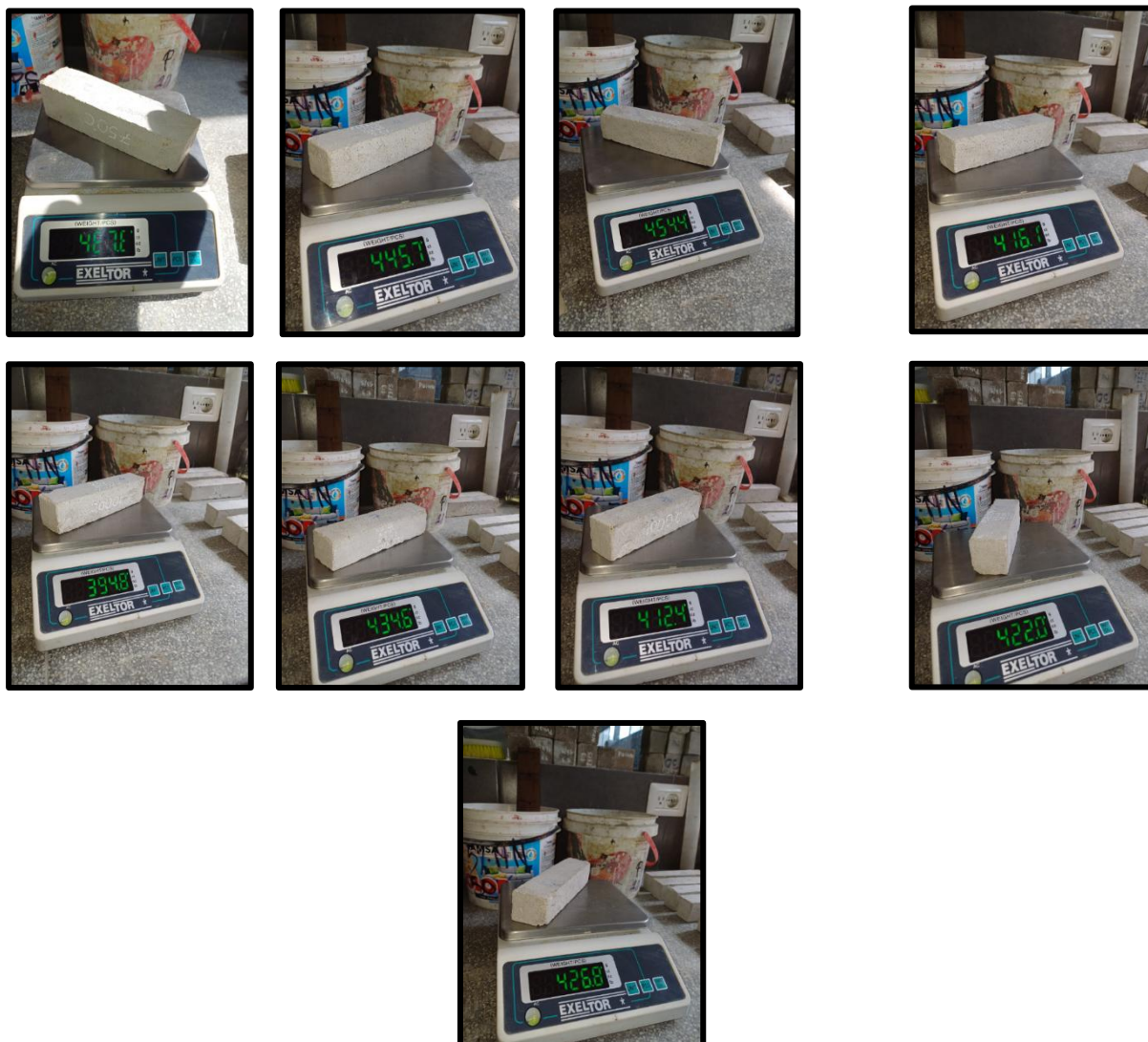
Figura 38: Peso de muestras secadas al horno con 2.5% de adición
