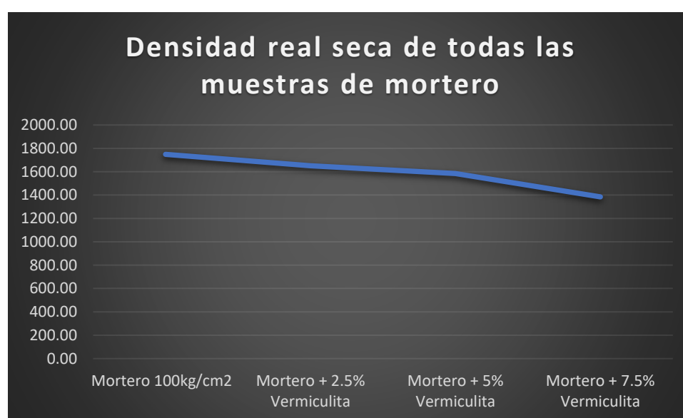
Figura 51: Gráfica de densidad real seca de todas las muestras de mortero
