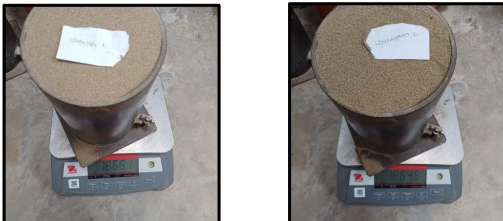
Figura 9: Peso de agregado fino para ensayo de PUSC
