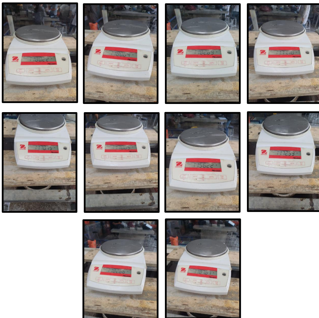
Figura 33: Peso de muestras sumergidas al agua mortero patrón (A)
