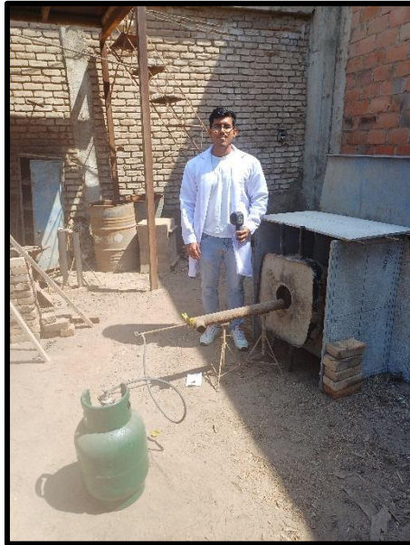
Anexo 24: Exposición al fuego de muretes de 60x60cm a diferentes rangos de temperatura para evaluar micro fisuras y coloración del mortero
