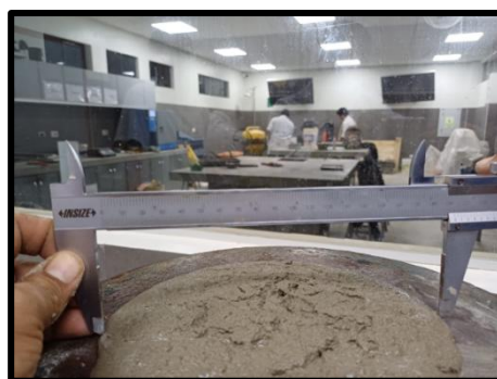
Figura 32: Mezcla y colocación de mortero en mesa de fluidez
