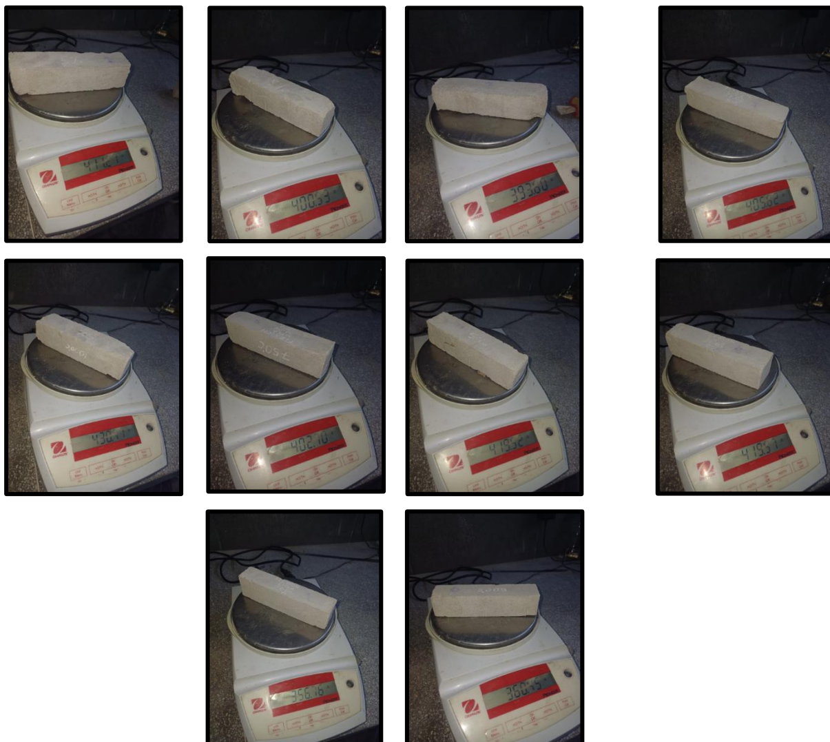
Figura 41: Peso de muestras secadas al horno con 5% de adición
