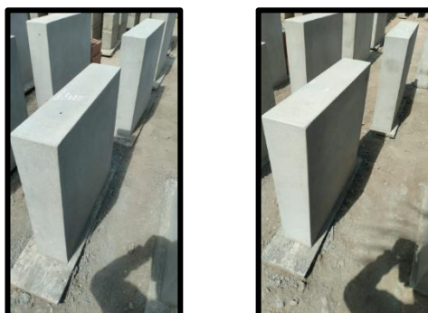
Figura 29: Muretes para micro fisuras con adición de 2.5%
