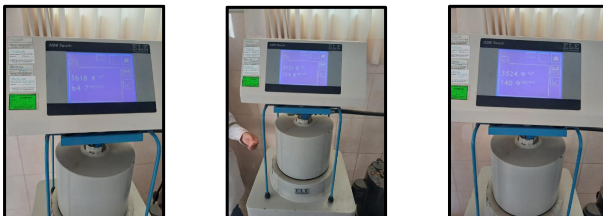
Figura 17: Muestra N°01, N°02 y N°03 mortero patrón a 28 días
