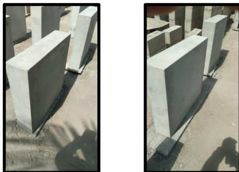
Figura 30: Muretes para micro fisuras con adición de 5%
