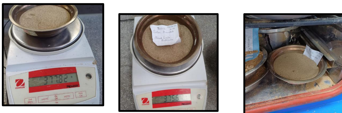
Figura 10: Ensayo de contenido de humedad
