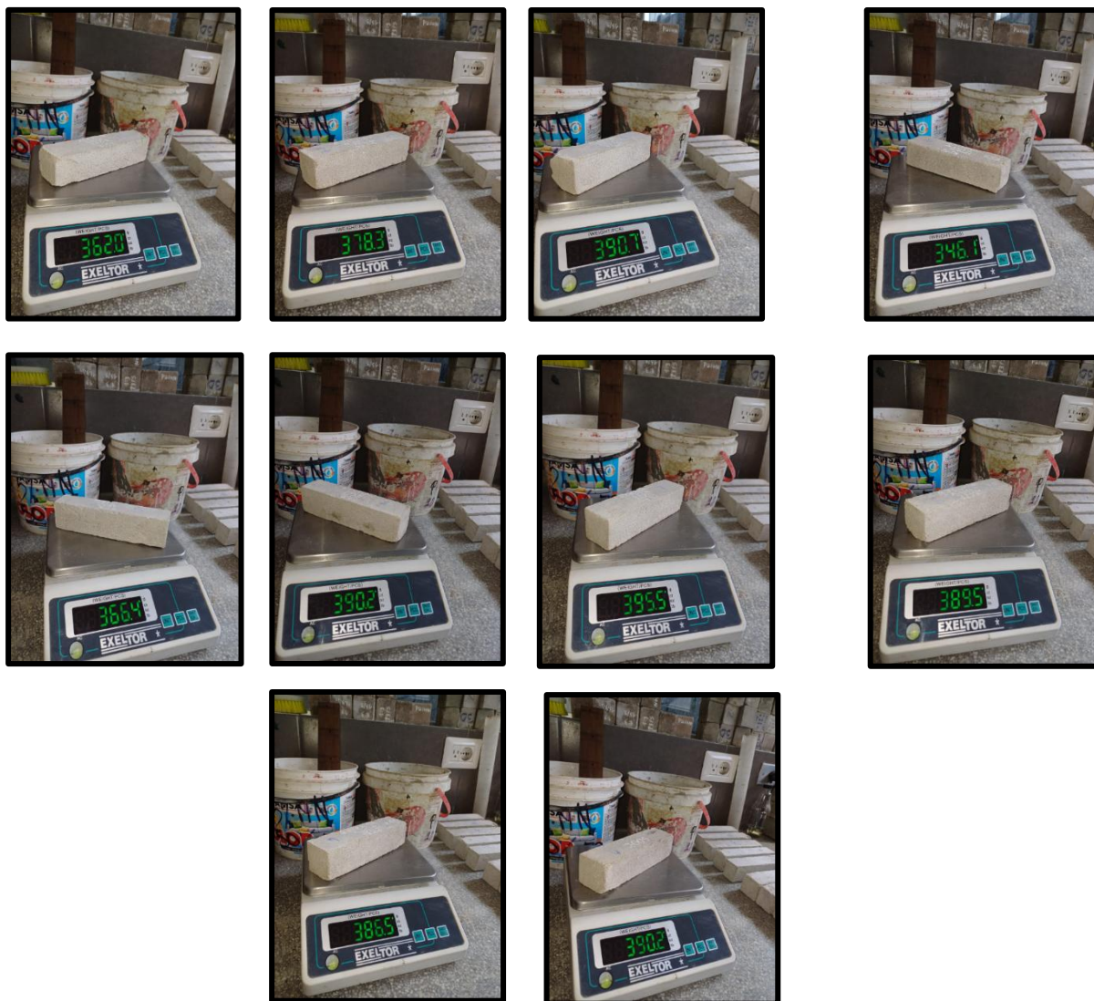
Figura 44: Peso de muestras secadas al horno con una adición de 7.5%
