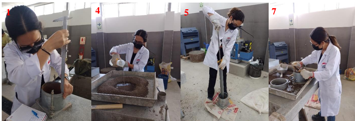
Ilustración 17. Mezclado, compactación y enrasado para ensayo de Proctor Modificado. Fuente: propia.
