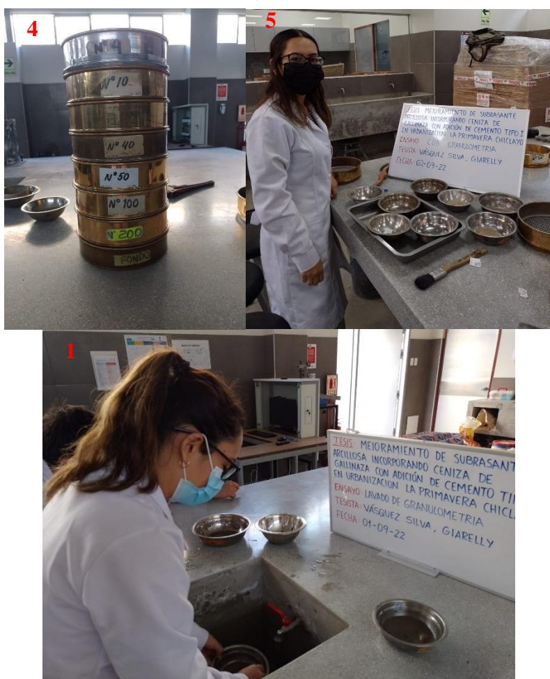
Ilustración 10. Procedimiento de granulometría por tamizado. Fuente: propia.
