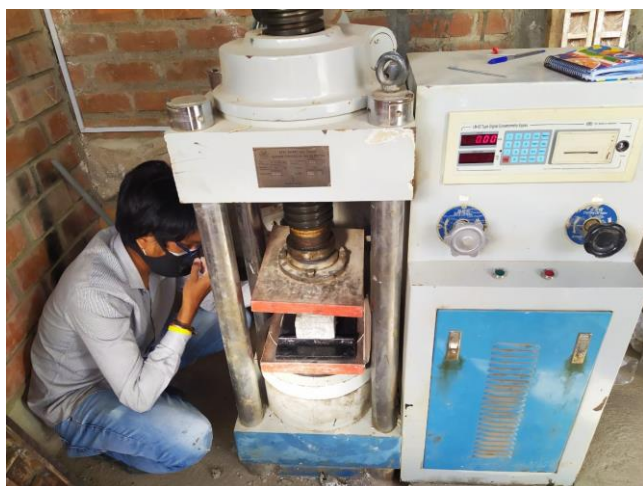
Figura n° 9. 63. Ensayo de compresión
