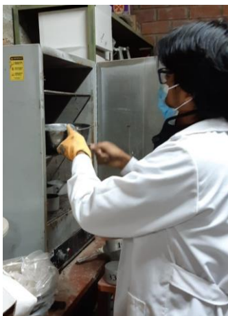
Figura n° 3. 5. Colocación de muestra en el horno a temperatura constante
