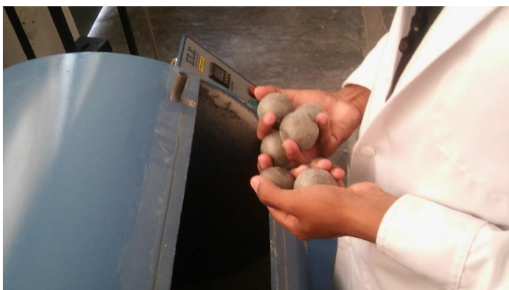
Figura n° 3. 11. Cargas a utilizar para el ensayo
