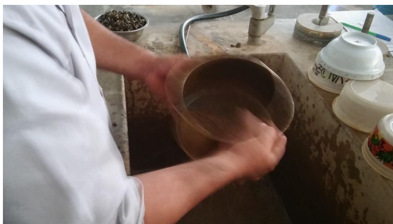
Figura n° 3. 6. Lavado del agregado grueso
