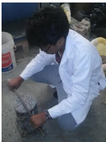
Figura n° 3. 21. Enrase de la superficie mediante la varilla de apisonado
