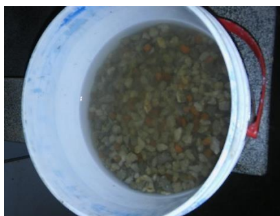
Figura n° 3. 17. Agregado grueso reciclado sumergido en agua durante 24 horas
