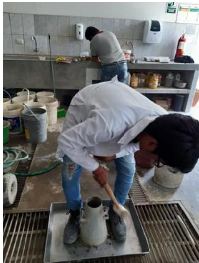
Figura n° 9. 51. Ensayo de revenimiento
