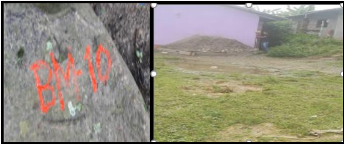
Fotografía N°: 4 Bm colocados en el levantamiento topográfico
