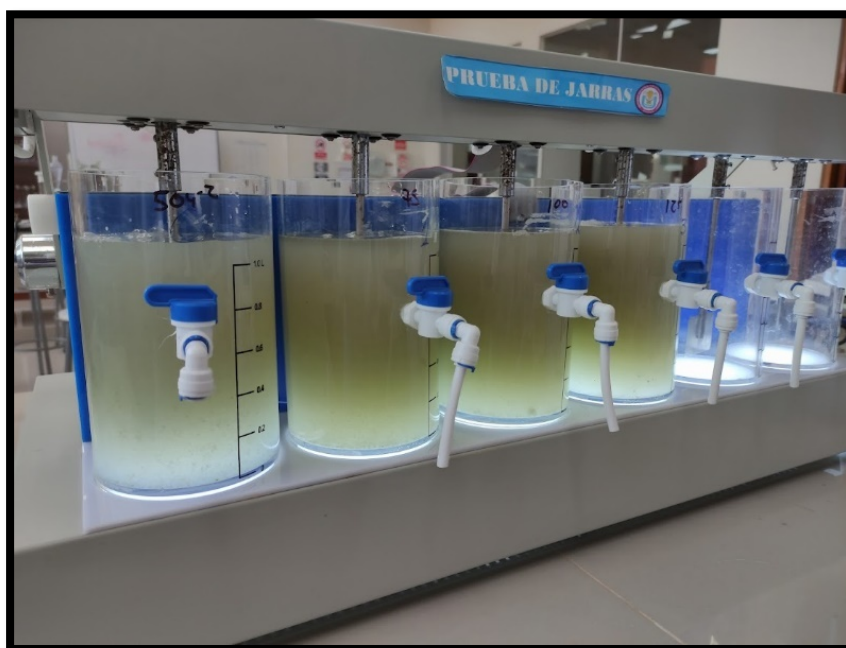
Ilustración 52 Prueba de test de jarras con las dosificaciones de los coagulantes
