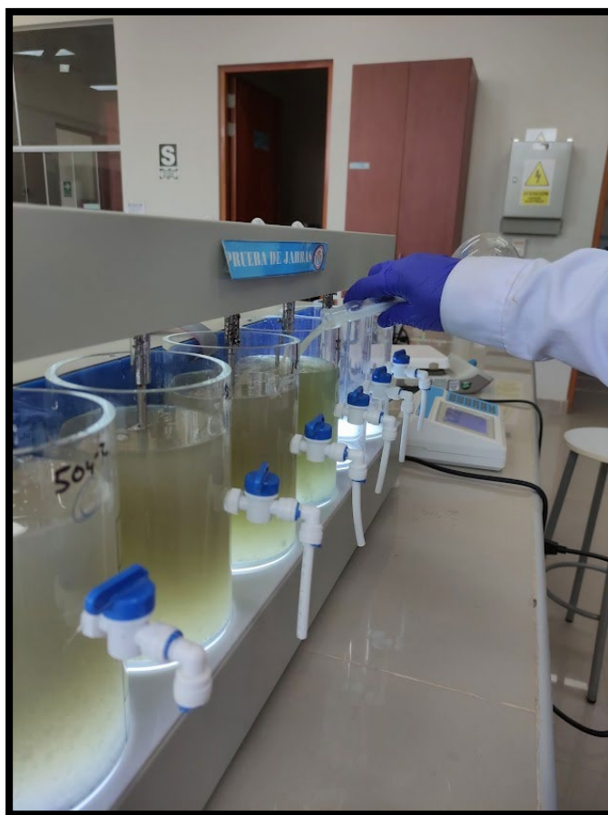
Ilustración 51 Aplicación de 3ra dosificación de semilla de MO 2500ppm (125ml)
