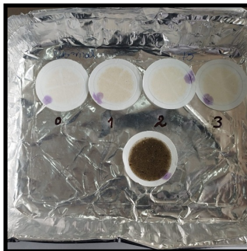
Ilustración 78 Resultado final de discos de filtro de fibra de vidrio para sólidos suspendidos totales
