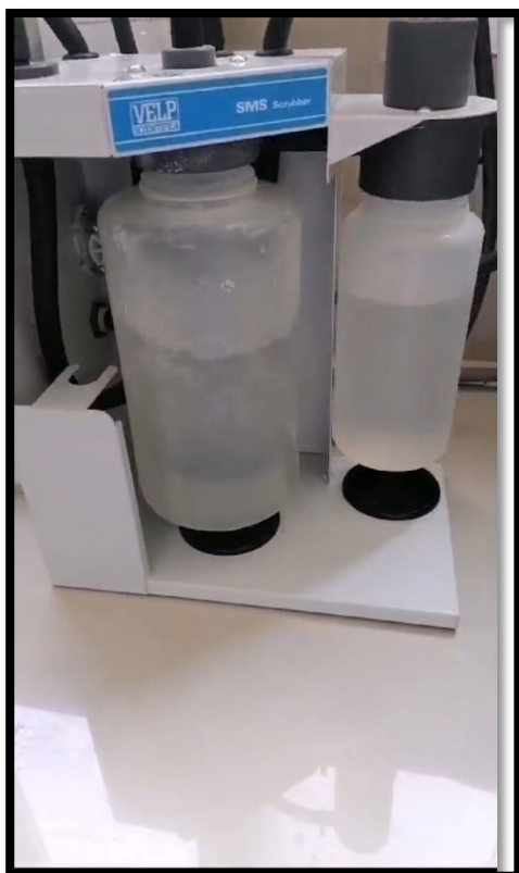
Ilustración 19 Aparato de scrubber
