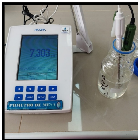
Ilustración 64 Toma de lectura de PH de muestra con 1ra dosificación de semilla de moringa
