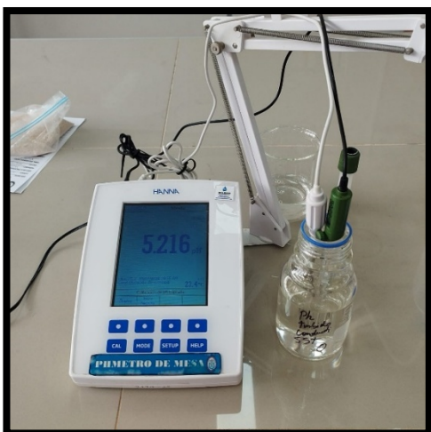
Ilustración 63 Toma de lectura de PH de muestra de agua con dosificación de sulfato de aluminio
