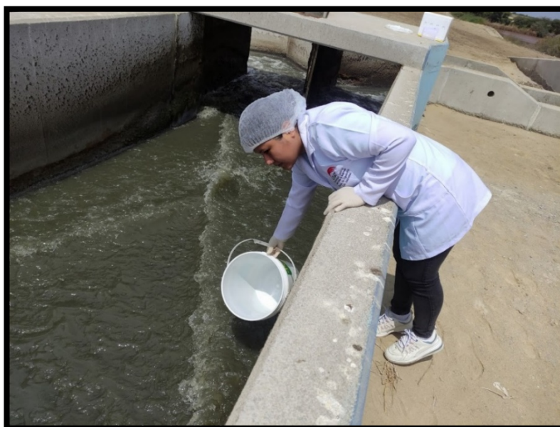
Ilustración 32 Se introduce el balde para recolectar el agua residual
