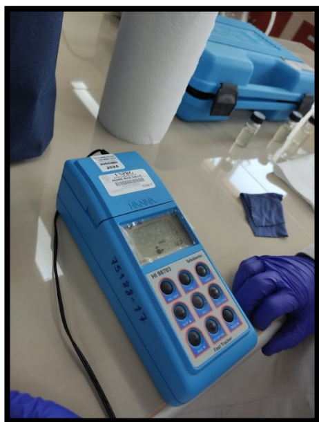
Ilustración 57 Calibración del turbidímetro
