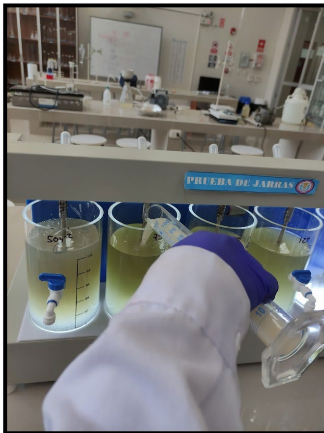
Ilustración 49 Aplicación de 1ra dosificación de semilla de MO 1500ppm (75ml)
