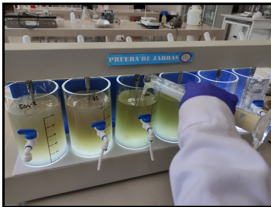
Ilustración 50 Aplicación de 2da dosificación de semilla de MO 2000ppm (100ml)
