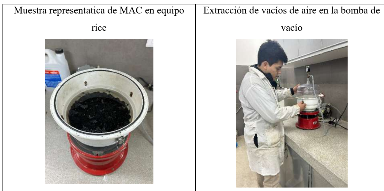
Ilustración 28: Ensayo Gravedad Específica Rice
