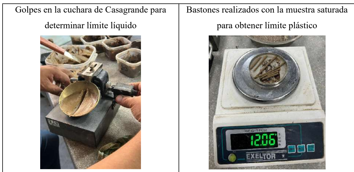
Ilustración 16: Ensayo Determinación del Límite Plástico de los Suelos e Índice de Plasticidad
