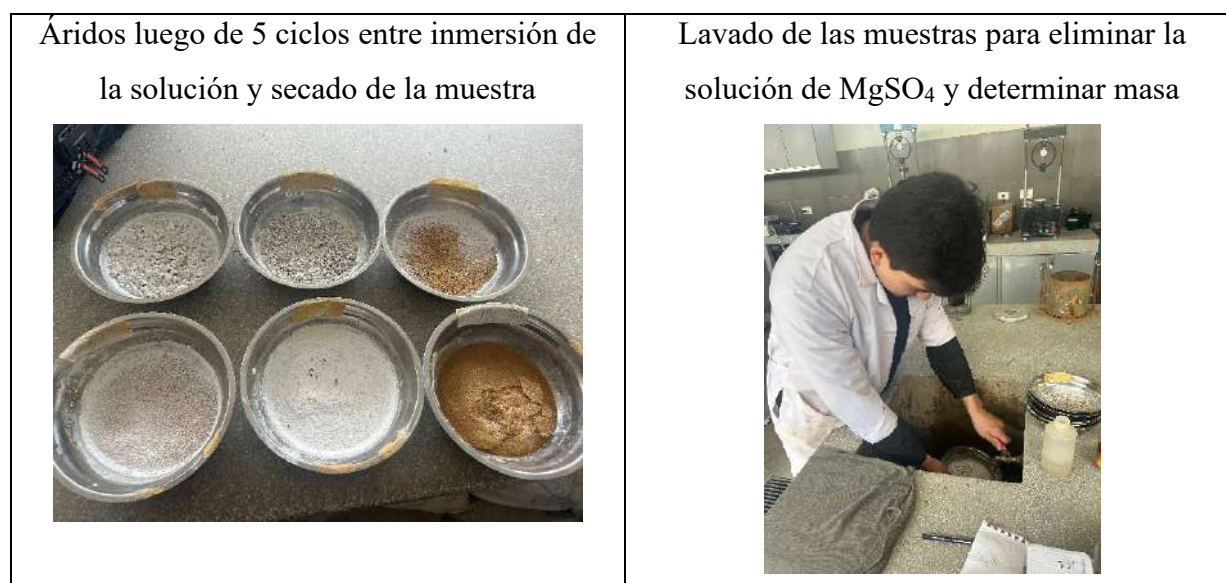
Ilustración 20: Ensayo Durabilidad al Sulfato de Magnesio
