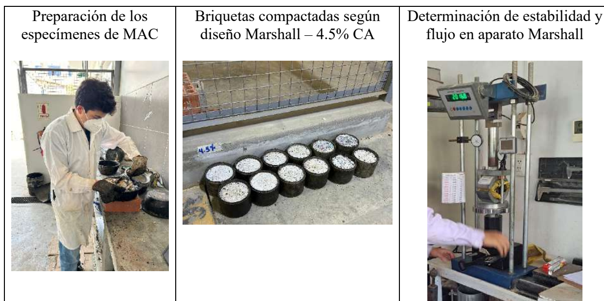
Ilustración 27: Ensayo Resistencia de Mezclas Bituminosas Empleando el Aparato Marshall
