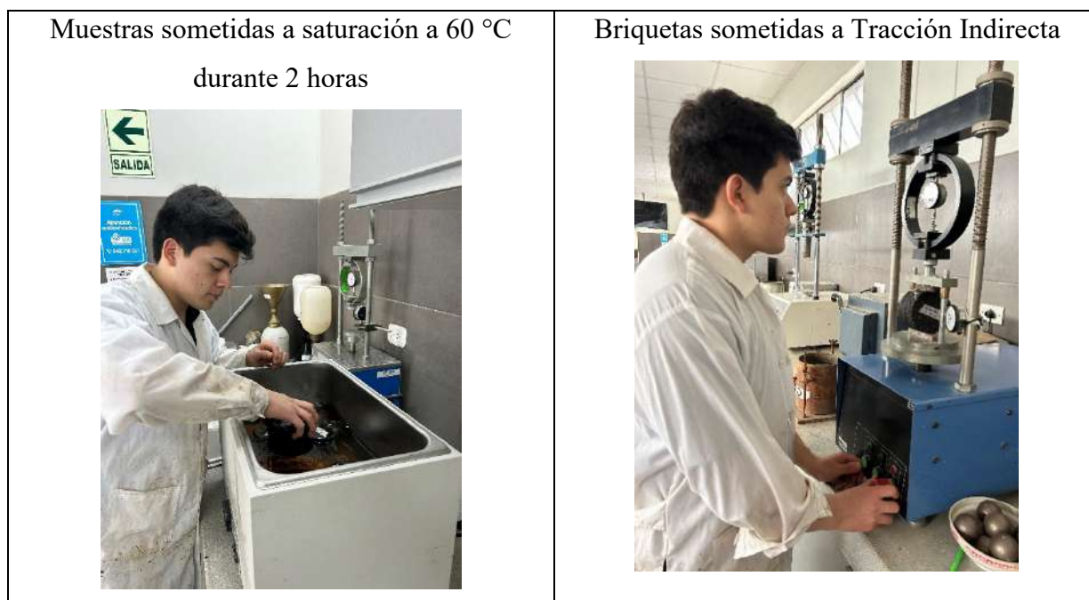
Ilustración 30: Test de Lottman Modificado
