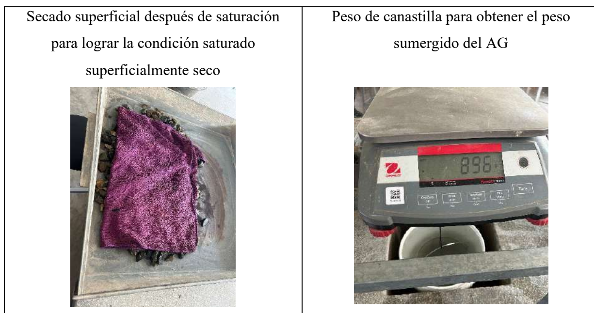
Ilustración 17: Ensayo Peso Específico y Absorción de Agregados Gruesos
