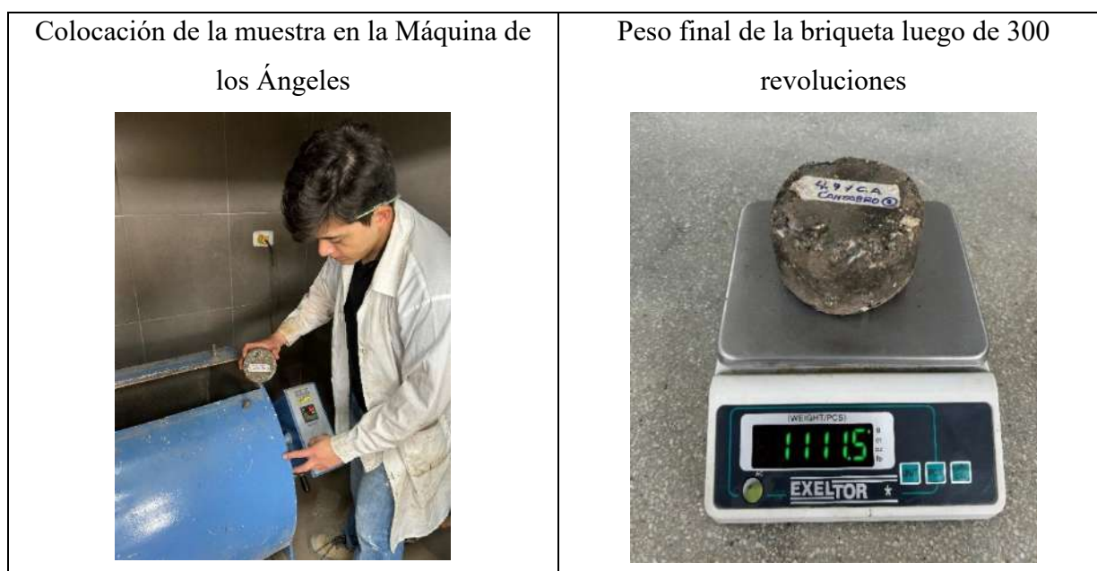
Ilustración 29: Ensayo Cántabro de Pérdida por Desgaste
