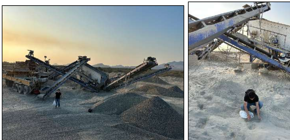
Ilustración 12: Obtención de polvo residual de piedra chancada
