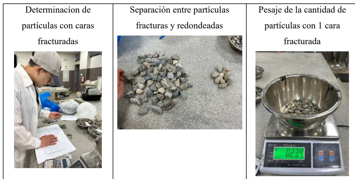
Ilustración 21: Ensayo para la Determinación del Porcentaje de Partículas Fracturadas en el Agregado Grueso
