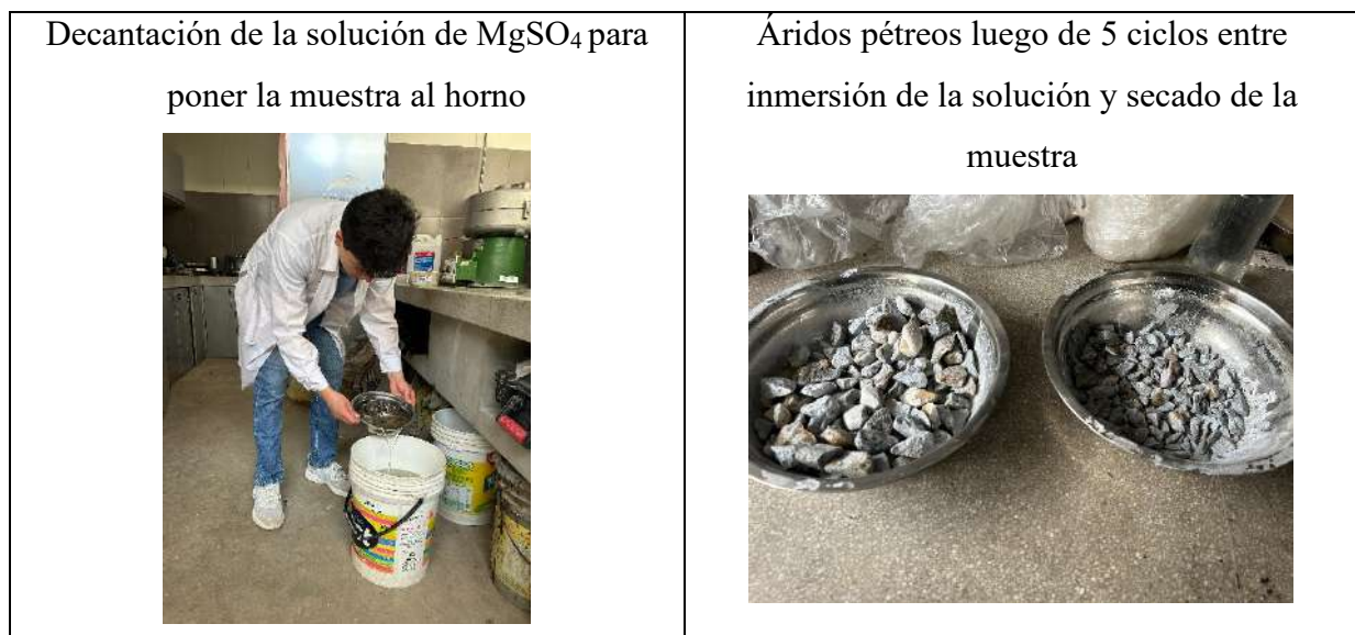
Ilustración 19: Ensayo Durabilidad al MgSO_4
