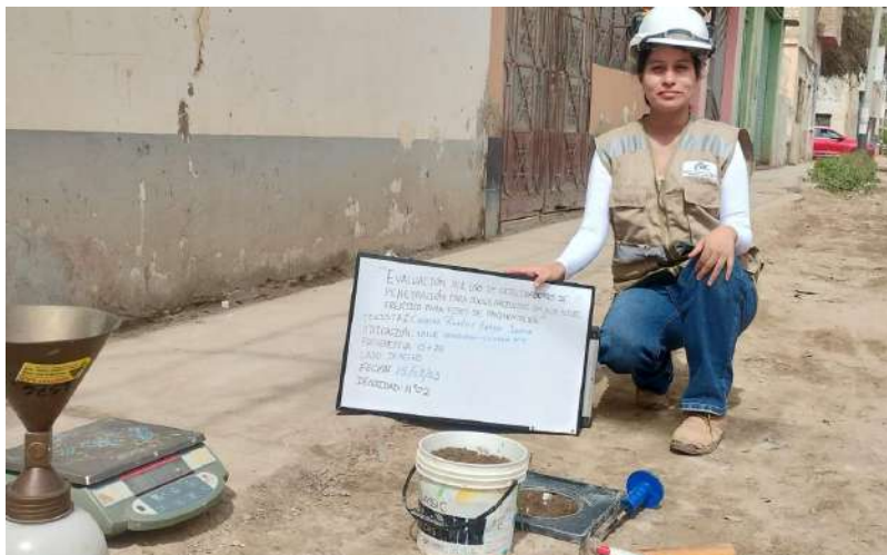
Figura 57. Medición de la MDS del segundo punto experimental con cono de arena.
