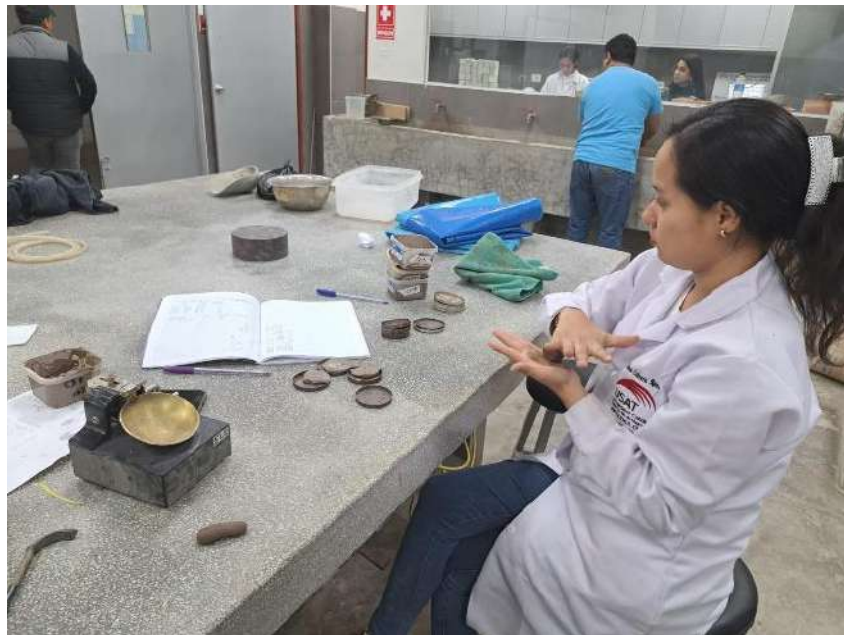
Figura 21. Preparación de muestras en moldes para límites de consistencia.
