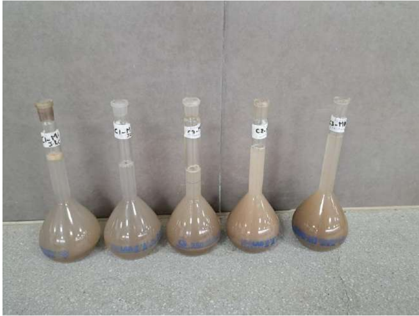
Figura 26. Muestras saturadas con agua destilada para gravedad específica.
