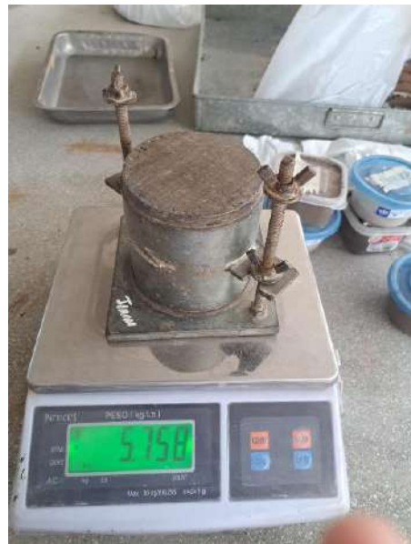
Figura 43. Peso de muestra para proctor modificado experimental 2 da adición.
