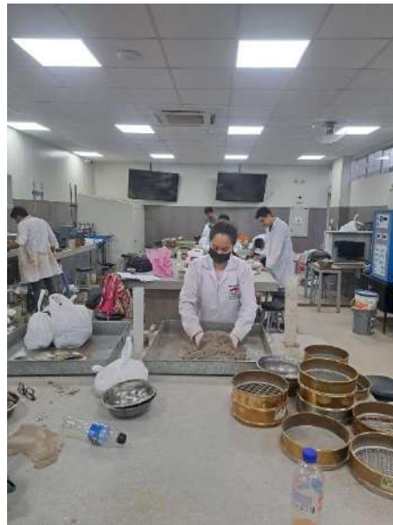
Figura 45. Preparación de muestras para ensayos de CBR.
