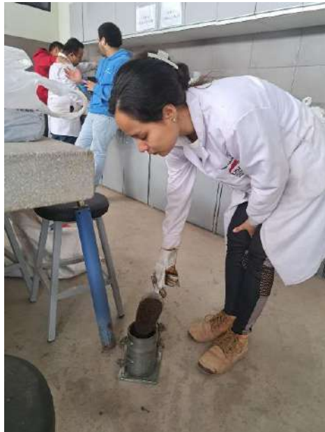
Figura 35. Llenado de moldes mediante 5 capas con 25 golpes para proctor modificado.
