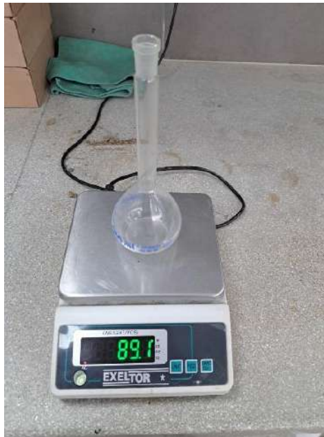
Figura 25. Pesado de fiolas para gravedad específica.
