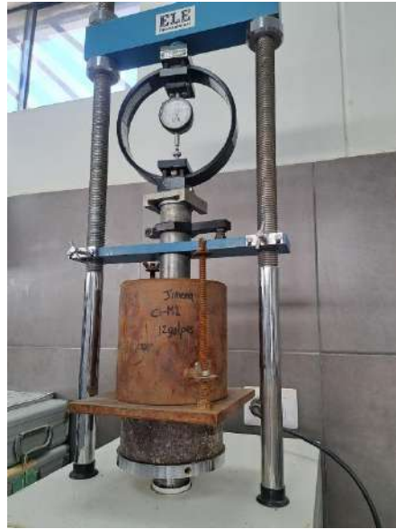
Figura 48. Muestra estabilizada en dial de carga.
