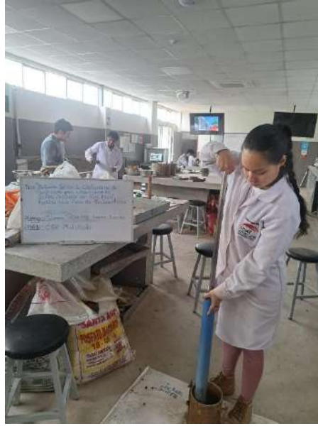
Figura 46. Compactación de muestra estabilizada en molde.
