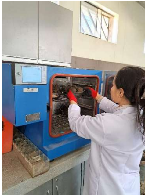
Figura 15. Colocación de muestras húmedas en el horno para contenido de humedad.
