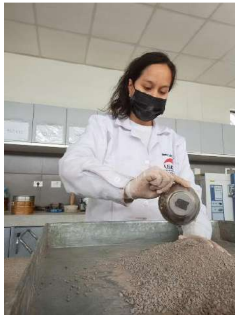
Figura 39. Preparación de muestras para proctor modificado experimental 1 era adición.
