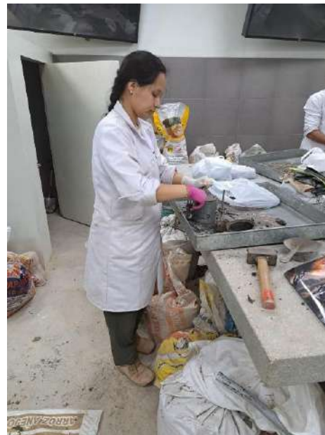
Figura 37. Enrasado de moldes con muestras para proctor modificado.
