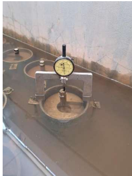
Figura 47. Muestra estabilizada sumergida en agua.
