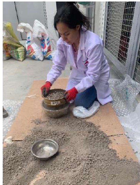
Figura 33. Trituración y tamizado de muestras por la malla N° 4 para proctor modificado.
