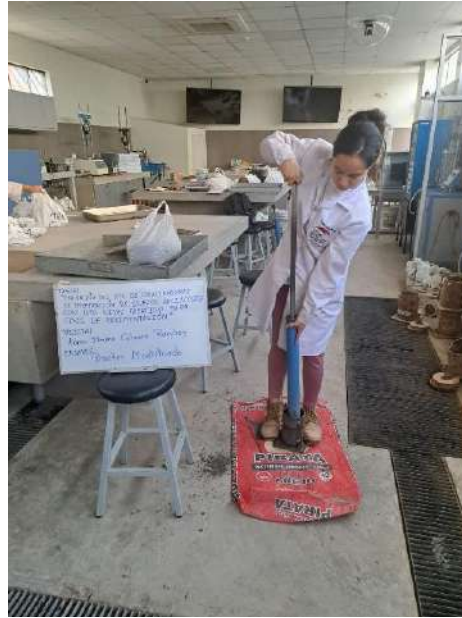
Figura 36. Compactación sobre los moldes con muestras para proctor modificado.
