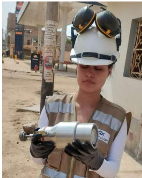
Figura 59. Medición de OCH del segundo punto experimental con speedy.
