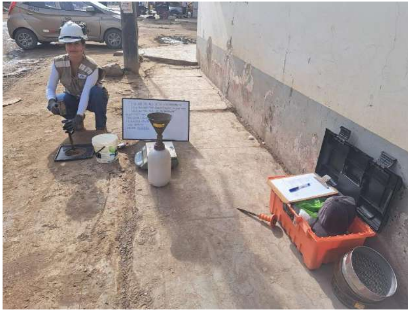
Figura 56. Medición de la MDS del primer punto experimental con cono de arena.
