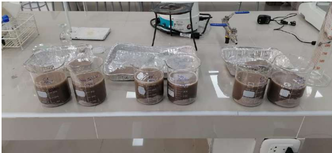
Figura 11. Muestras para ensayos químicos (cloruros, sulfatos y sales solubles).
