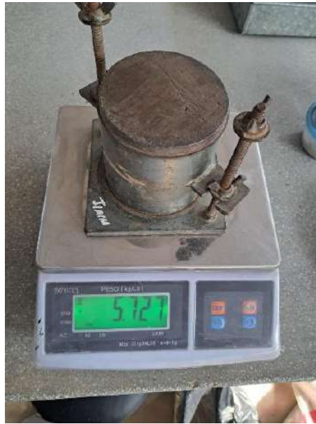
Figura 42. Peso de muestra para proctor modificado experimental 1 ra adición.
