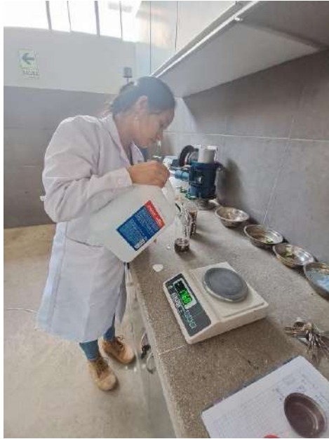
Figura 30. Colocación de agua destilado en muestras para hidrometría.
