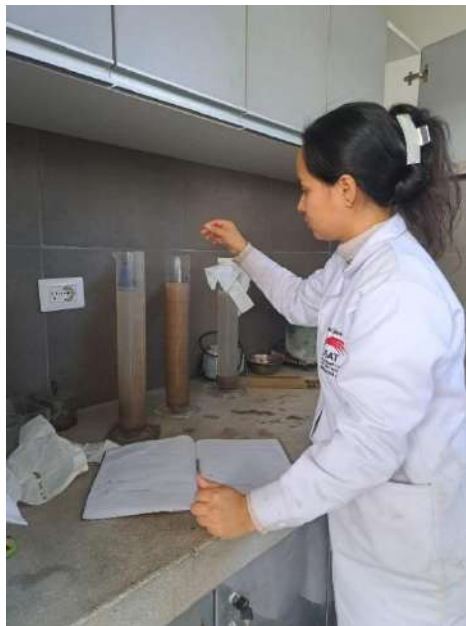
Figura 31. Medición del asentamiento de las muestras para hidrometría en función del tiempo.
