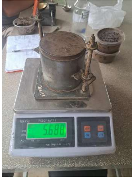
Figura 44. Peso de muestra para proctor modificado experimental 3 era adición.
