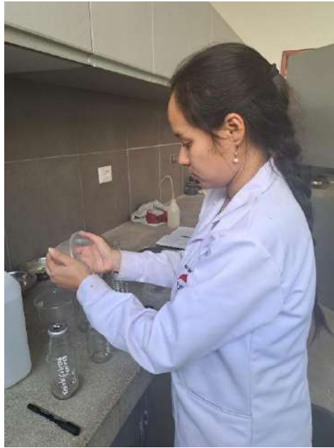
Figura 28. Preparación de muestras en cada base para hidrometría.
