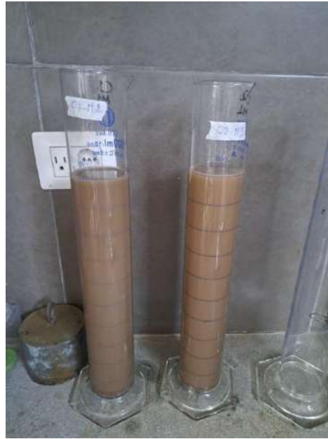
Figura 32. Asentamiento de partículas en las muestras para hidrometría.
