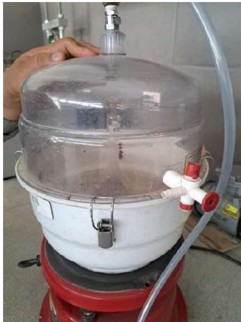
Figura 27. Colocación de muestras en cámara de vacíos para gravedad específica.
