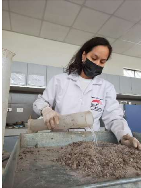
Figura 40. Preparación de muestras para proctor modificado experimental 2 da adición.
