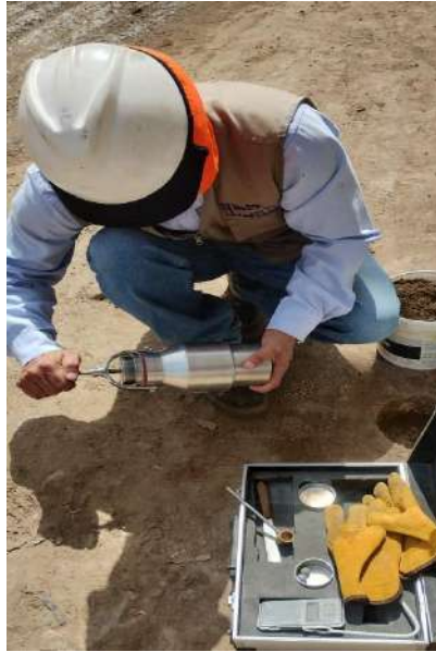
Figura 58. Medición de OCH del primer punto experimental con speedy.
