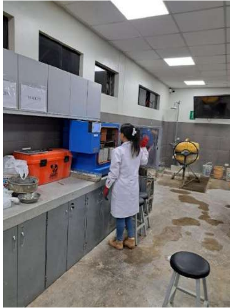
Figura 22. Inserción de muestras en el horno para límites de consistencia.
