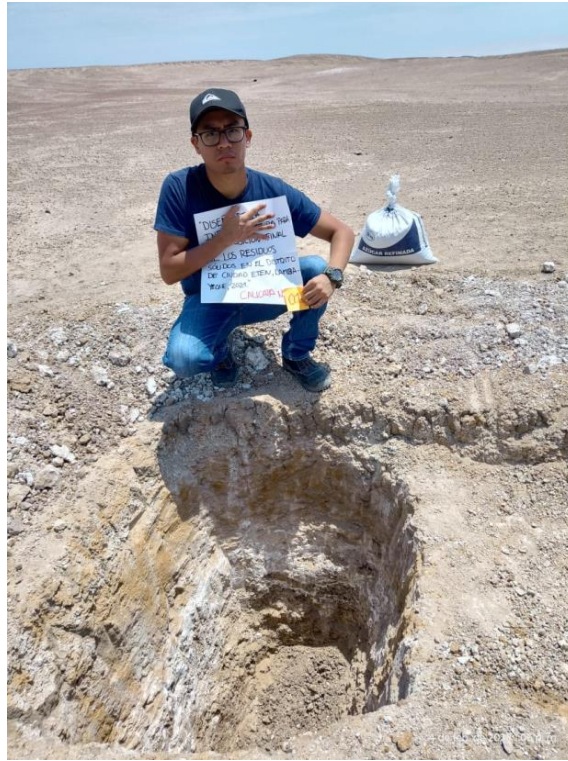
Anexo 1.14. Exploraciones a cielo abierto.
