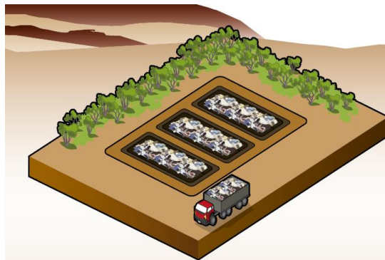
Ilustración 4. Método de trinchera o zanja.
