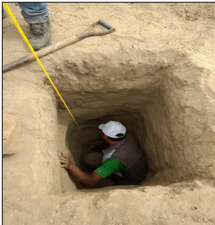
Figura N° 137. Calicata profundidad 1.55 m en el Parque Central Íllimo
