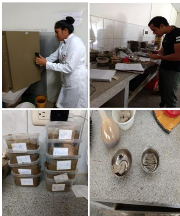
Figura N° 140. Elaboración de Ensayos Granulométricos, Corte Directo. entre otros, Necesarios para el Proyecto.
