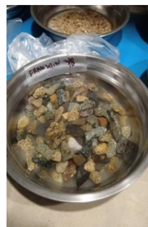
Ilustración 59 Agregado sometido al MgSO_4 \cdot 7H_2O durante 17 h y ser sometida en el horno
