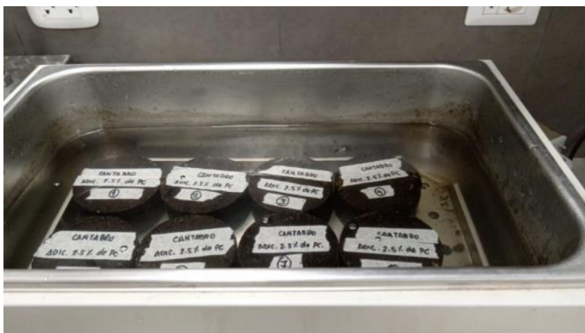
Ilustración 125 Muestra convencional y adición sometidas a 60°C
