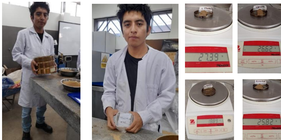
Ilustración 22 Proceso para determinar el índice de plasticidad por la malla #200
