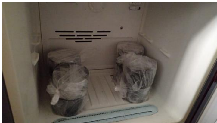
Ilustración 109 Briquetas sometidas a 60°C para ensayo Lottman
