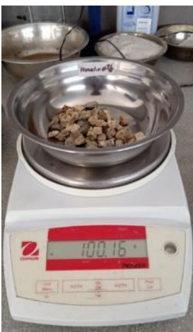
Ilustración 55 Peso del AG y AF
