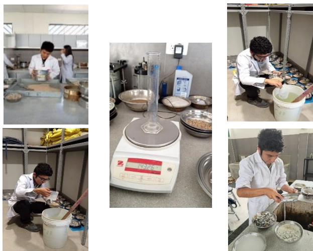
Ilustración 14 Proceso para determinar la resistencia del AG al MgSO_4 \cdot 7H_2O
