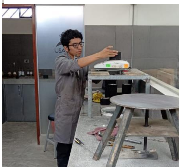
Ilustración 107 Briquetas sumergidas en agua para determinar los vacíos
