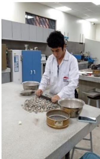
Ilustración 16 Clasificación de AG de acuerdo con las caras fracturadas y su granulometría
