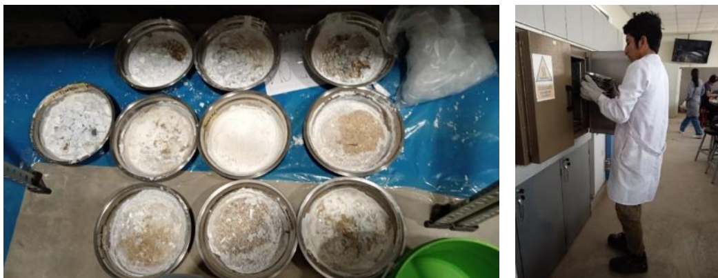
Ilustración 60 Muestra al ser sometida 5 ciclos por MgSO_4 \cdot 7H_2O y luego ser llevada al horno
