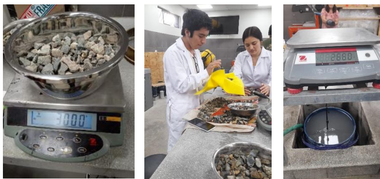
Ilustración 12 Proceso para determinar la absorción del AG
