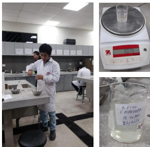
Ilustración 23 Proceso para determinar el porcentaje de sales solubles del AF
