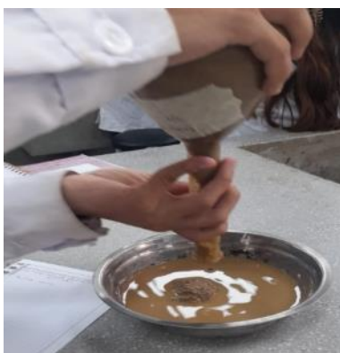
Ilustración 46 Extracción del agregado para luego ser sometido en el horno
