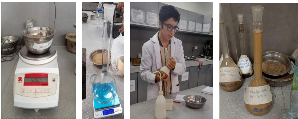
Ilustración 24 Proceso para determinar el porcentaje de absorción del AF
