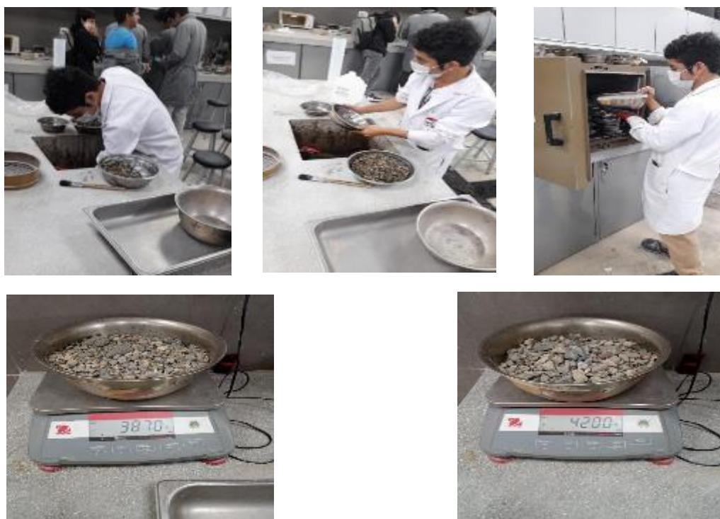
Ilustración 35 Lavado y secado del agregado, para luego ser pesado
