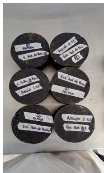
Ilustración 104 Briquetas luego de ser sometida a cargas
