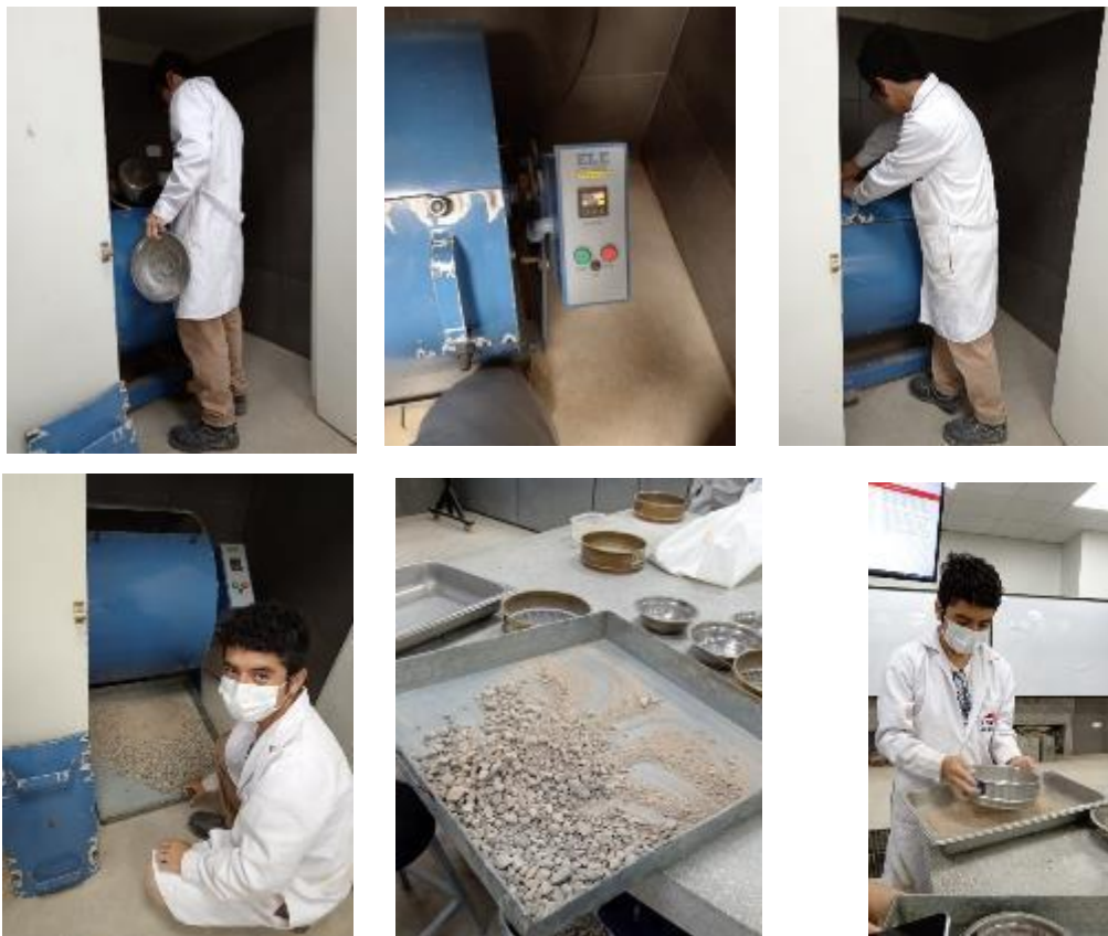
Ilustración 35 Lavado y secado del agregado, para luego ser pesado
