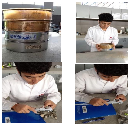
Ilustración 11 Proceso para determinar el porcentaje de partículas chatas y alargadas
