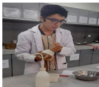
Ilustración 45 Muestra en reposo durante 24 h y peso de tara
