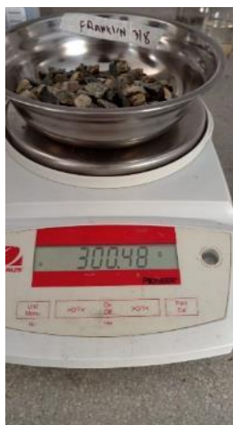
Ilustración 55 Peso del AG y AF
