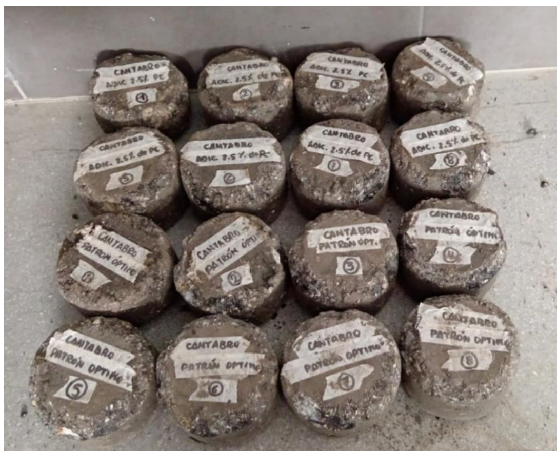
Ilustración 128 Muestra convencional y adicionada en estado húmedo después de ser sometidos a desgaste
