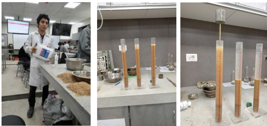
Ilustración 19 Proceso para determinar el equivalente de arena del AF
