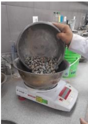
Ilustración 33 Selección de la cantidad de esferas a utilizar
