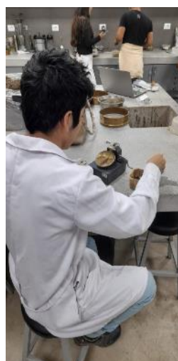
Ilustración 81 Limite plástico con la copa de casa grande para AF de mala #40 y #200
