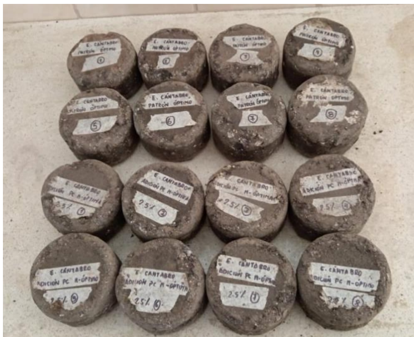
Ilustración 123 Muestras convencional y adición después de ser sometidas al desgaste
