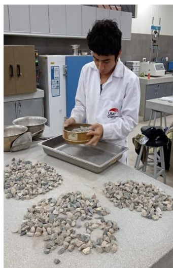
Ilustración 16 Clasificación de AG de acuerdo con las caras fracturadas y su granulometría
