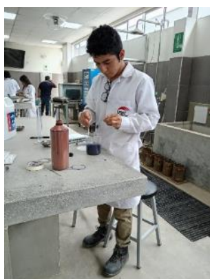
Ilustración 78 Determinación por goteo cada 2 ml de azul de metileno
