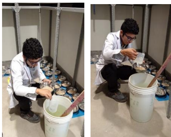
Ilustración 59 Agregado sometido al MgSO_4 \cdot 7H_2O durante 17 h y ser sometida en el horno
