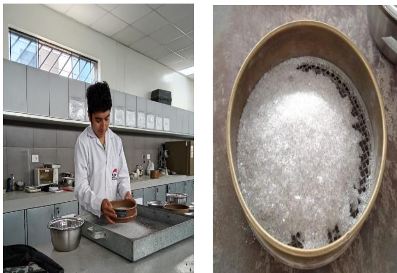
Ilustración 8 Proceso para determinar la granulometría del PC
