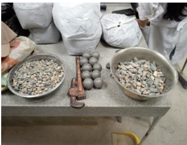
Ilustración 33 Selección de la cantidad de esferas a utilizar
