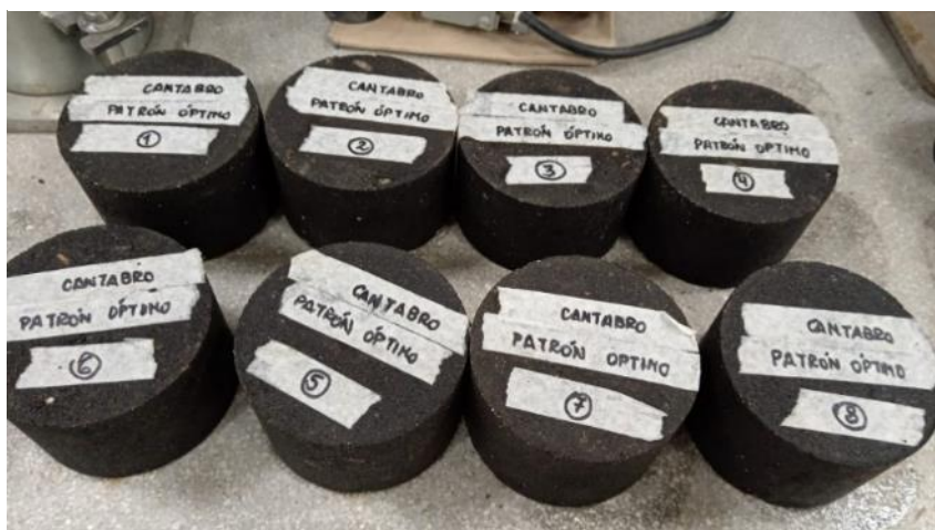
Ilustración 126 Muestra convencional luego de ser sometida a temperatura de 60°C
