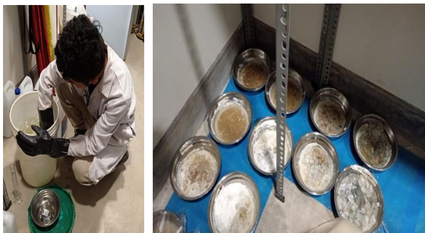
Ilustración 18 Proceso para determinar el desgaste del AF al ser sometido a MgSO_4 \cdot 7H_2O
