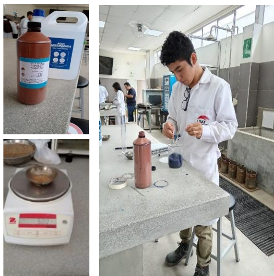
Ilustración 20 Proceso para determinar el porcentaje de partículas nocivas del AF por medio de azul de metileno
