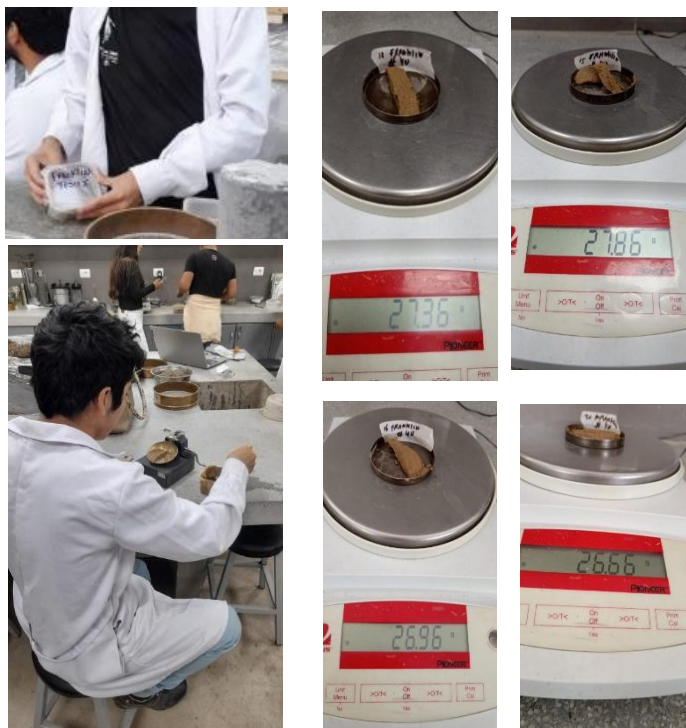
Ilustración 21 Proceso para determinar el índice de plasticidad por la malla #40
