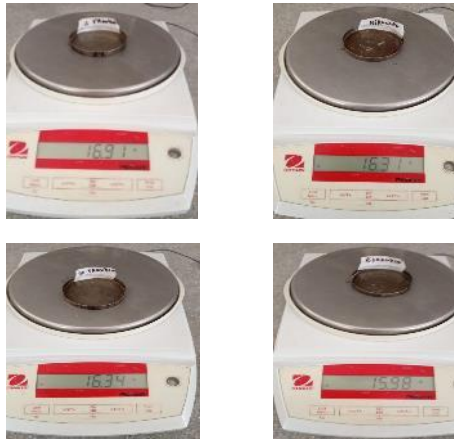
Ilustración 86 Peso suelo húmedo malla #200
