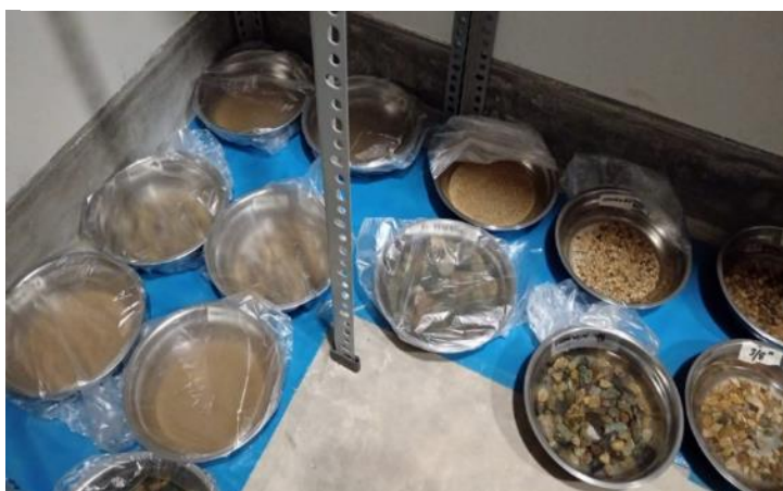
Ilustración 59 Agregado sometido al MgSO_4 \cdot 7H_2O durante 17 h y ser sometida en el horno
