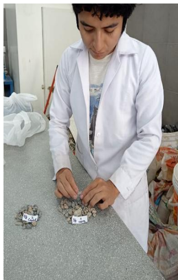
Ilustración 16 Clasificación de AG de acuerdo con las caras fracturadas y su granulometría
