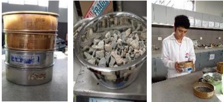
Ilustración 37 Proceso para determinar partículas chatas y alargadas con relación 1:3
