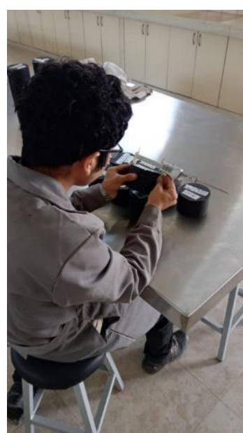
Ilustración 110 Medida de briqueta para determinar el hinchamiento
