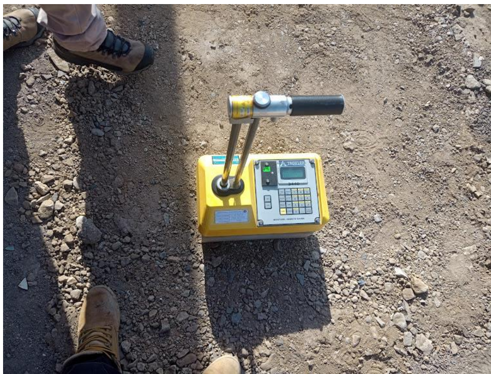
Figura 26. Lectura con densímetro nuclear.
