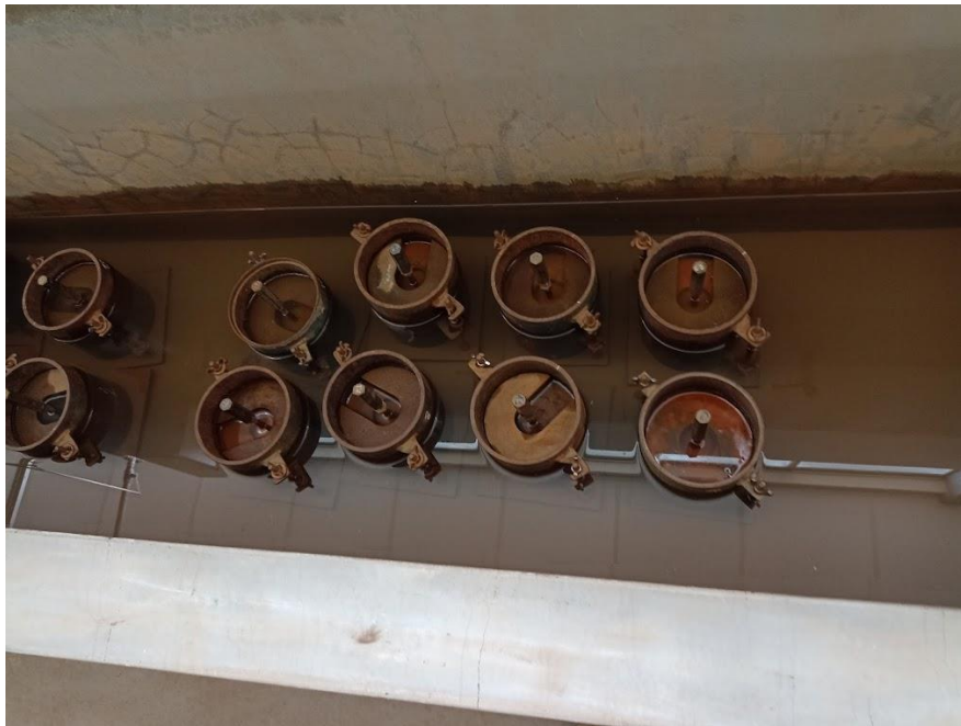
Figura 16. Muestras estabilizadas sumergidas en agua.
