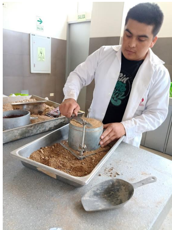
Figura 14. Enrasado de muestras estabilizadas.
