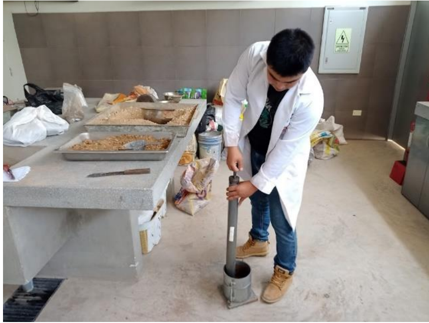
Figura 13. Compactación por capas de muestras estabilizadas.
