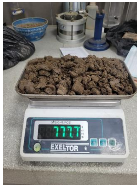
Peso de la muestra de la C-01 para determinar el contenido de humedad
