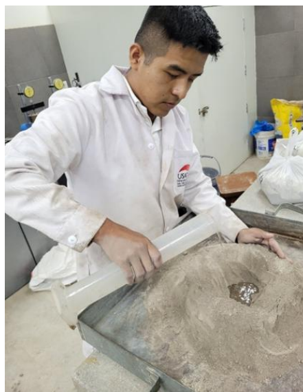
Proceso de mezclado uniforme entre el material y la humedad establecida para ejecutar la prueba de Proctor Modificado
