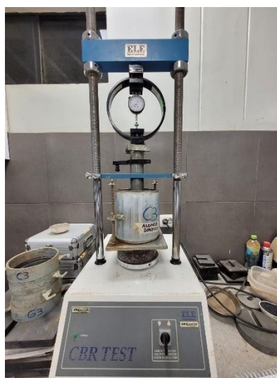
Ejecución de la prueba de penetración como procedimiento final para cuantificar el valor CBR del material
