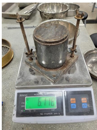
Pesado de moldes después del proceso de compactación y enrasado.
