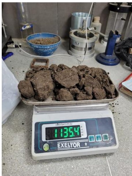
Peso de la muestra de la C-02 para determinar el contenido de humedad
