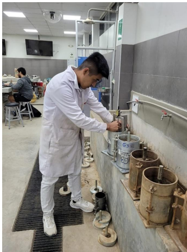
Fotografía 13: Material acondicionado para la fase de saturación
