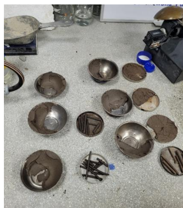
Especímenes correspondientes a límite líquido y límite plástico que serán llevados al horno para su posterior secado
