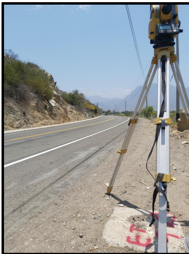
Imagen 39: Levantamiento topográfico de sectores críticos (Estación 9 – Sector III)
