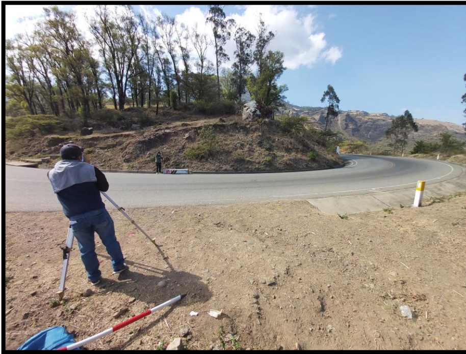
Imagen 45: Levantamiento topográfico de sectores críticos (Estación 1 – Sector IX)
