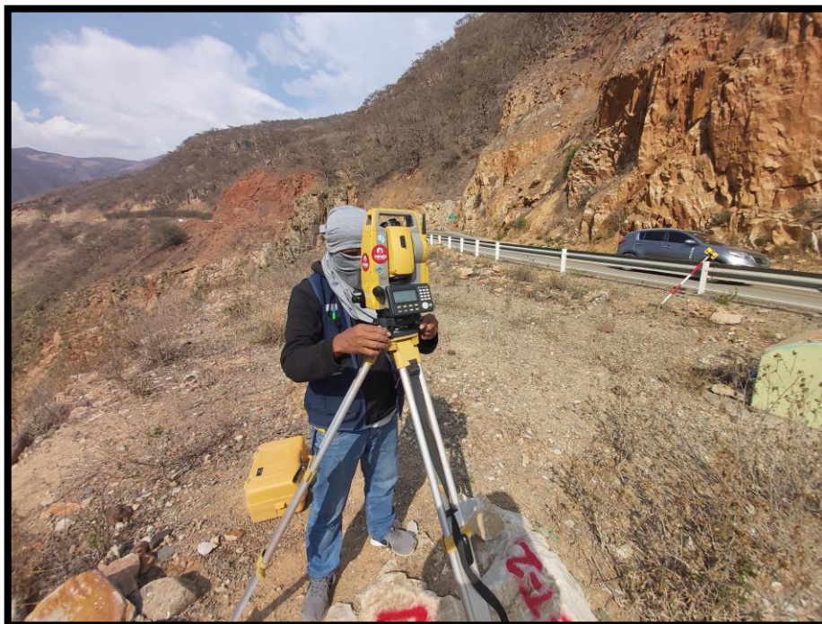
Imagen 48: Levantamiento topográfico de sectores críticos (Estación 2 – Sector VII)
