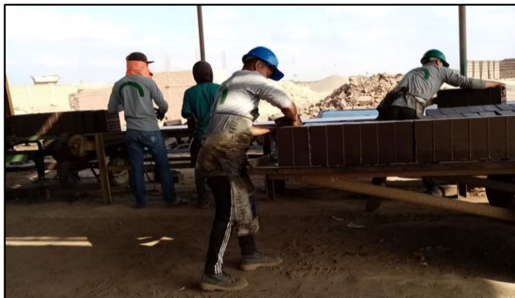
Figura 32. Ausencia de equipos de protección de ruido
