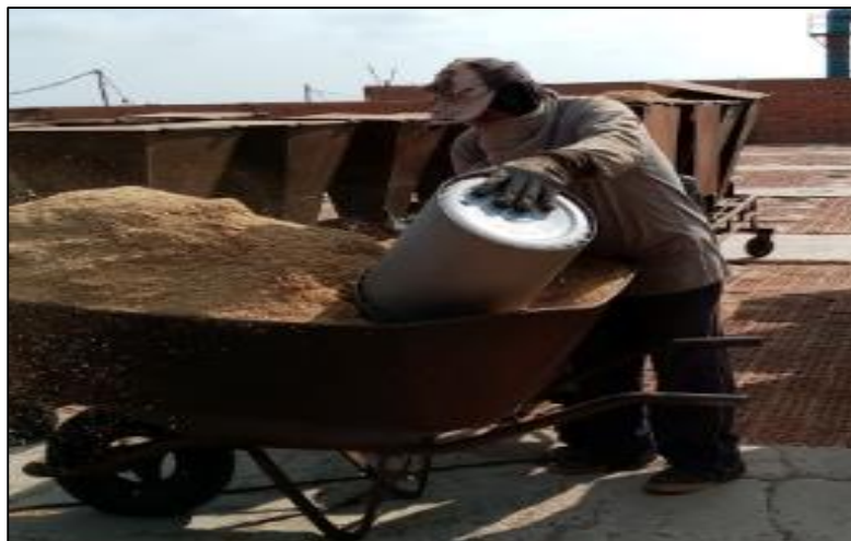
Figura 33. Ausencia de equipos de protección de partículas
