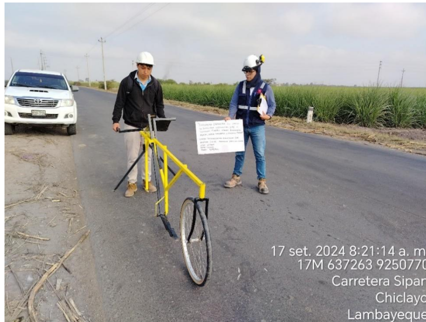
Fig. 25. Inicio del ensayo y toma de datos con el equipo de Merlín
