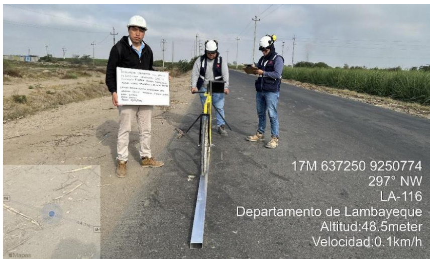
Fig. 23. Calibración del rugosímetro Merlín
