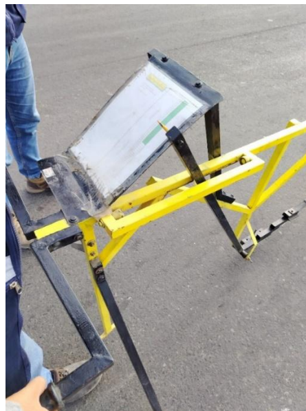
Fig. 26. Tablero con las escalas del equipo de Merlín
