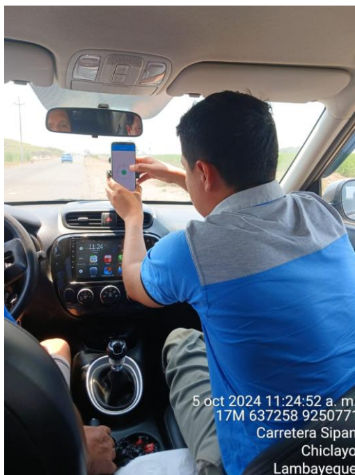
Fig. 41. Nivelación del smartphone en el vehículo.
