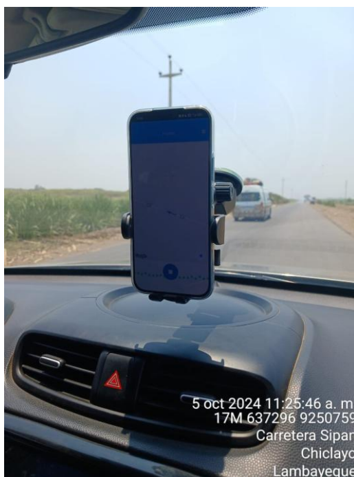
Fig. 43. Aplicativo TotalPave registrando los datos de la carretera.
