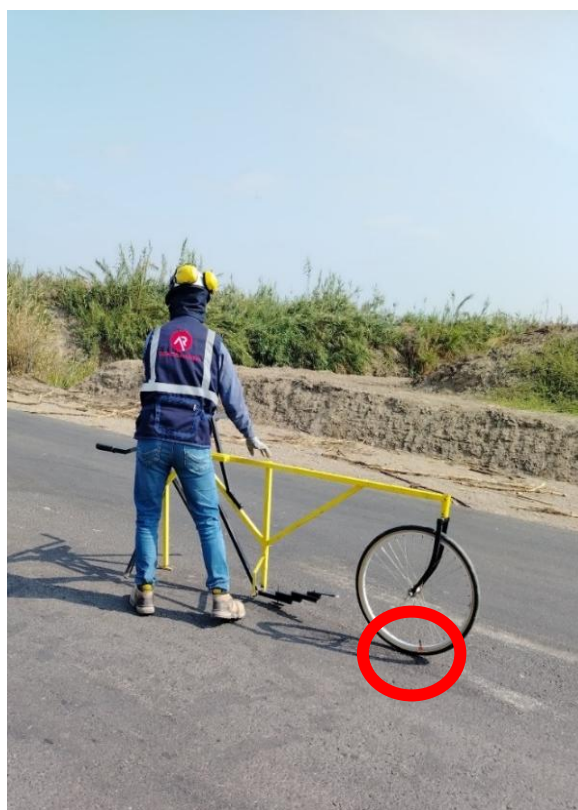
Fig. 24. Marca de la rueda para la toma de muestras
