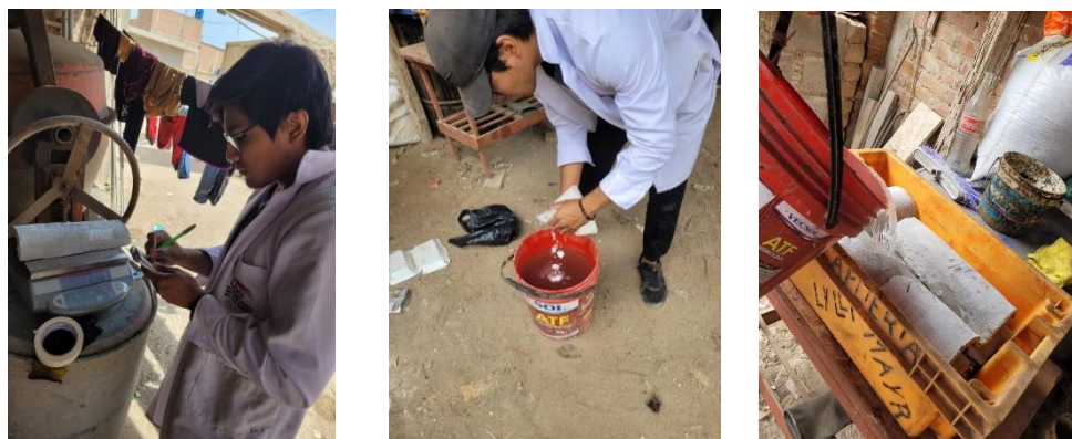
Ilustración 79. Ensayo de Durabilidad a las tejas de microconcreto
