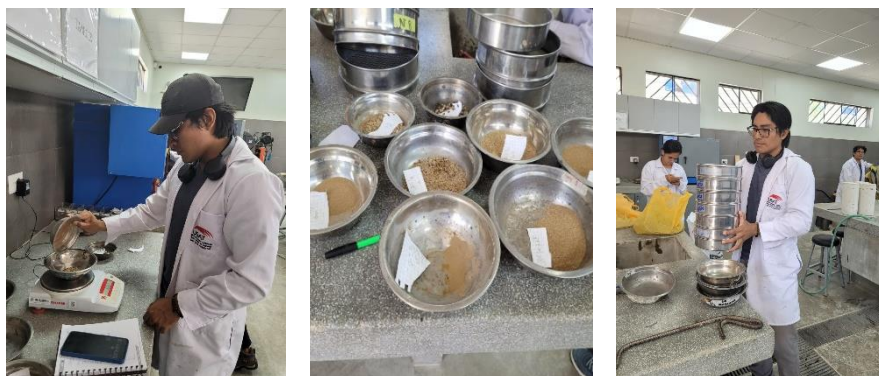
Ilustración 31. Análisis Granulométrico del agregado fino
