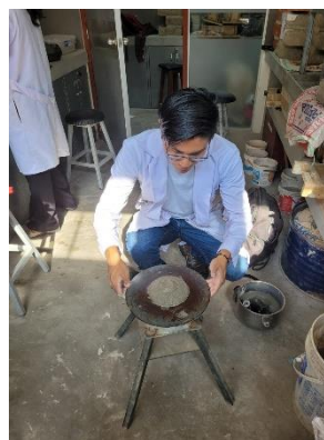
Ilustración 46. Ensayo de Fluidez para mortero convencional
