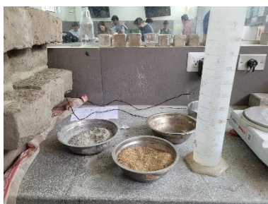
Ilustración 46. Ensayo de Fluidez para mortero convencional
