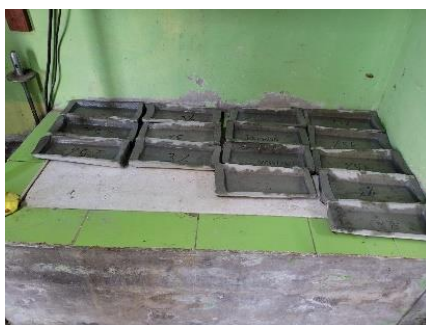
Ilustración 82. Ensayo de Impermeabilidad a las tejas de microconcreto
