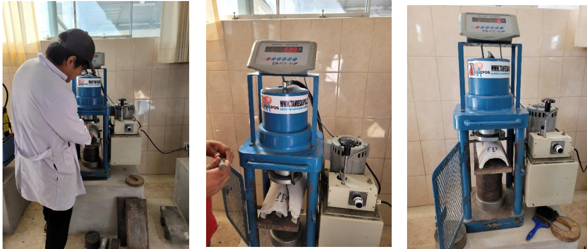
Ilustración 85. Ensayo de Resistencia a la Flexión a los 28 días a las tejas de microconcreto
