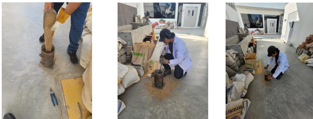
Ilustración 34. Peso Unitario Suelto y Compactado del agregado fino
