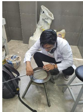
Ilustración 52. Ensayo de Fluidez para mortero con adiciones de Nanosílice
