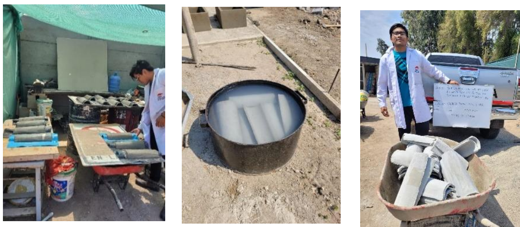
Ilustración 67. Secado, curado y traslado de las tejas de microconcreto
