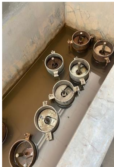
Imagen 24. Ensayo de Soporte de California
