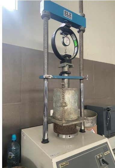
Imagen 25. Ensayo de Soporte de California
