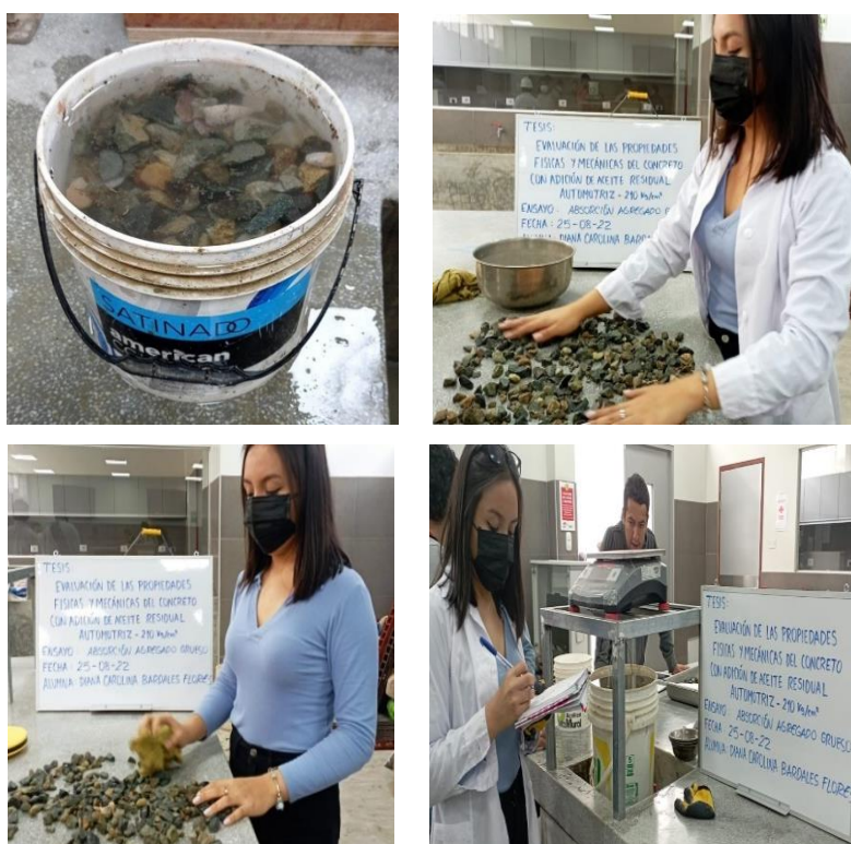
Ilustración 9 Secado de muestra saturada para ensayo de peso específico de agregado grueso
