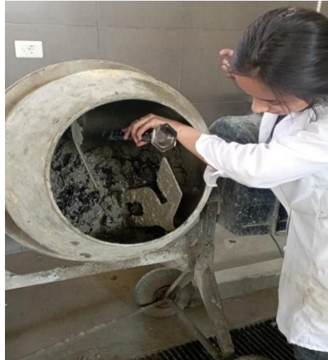
Ilustración 13 Técnica inadecuada de incorporación de ARA
