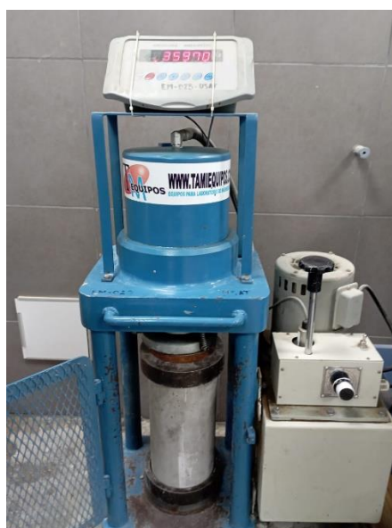
Ilustración 22 Rotura de espécimen de concreto en prensa de compresión
