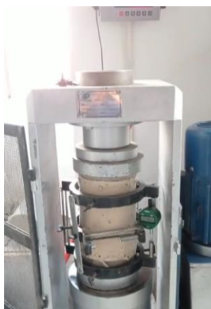
Ilustración 23 Ensayo de módulo de elasticidad
