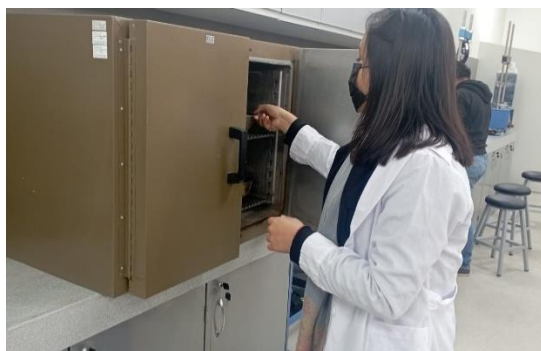
Ilustración 6 Secado y pesaje de muestra para granulometría de finos
