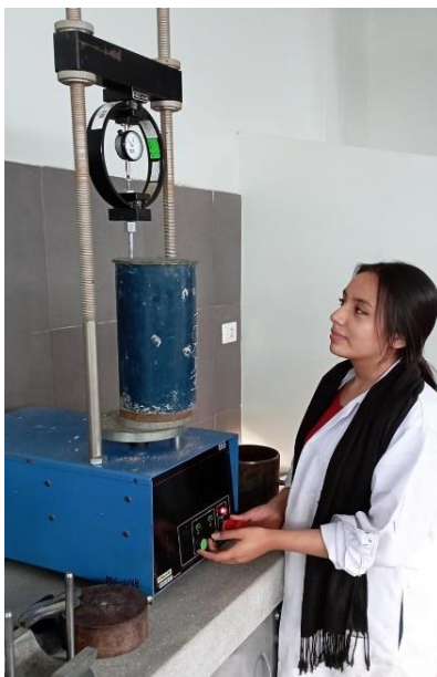
Ilustración 18 Penetraciones con máquina Marshall
