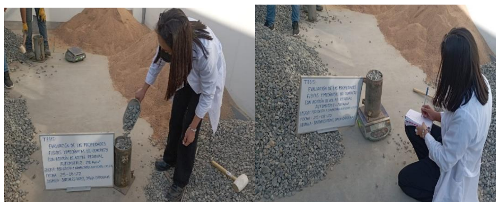
Ilustración 11 Ensayo de peso volumétrico de los agregados
