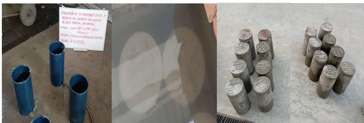
Ilustración 21 Preparación de especímenes de concreto para ensayo de resistencia
