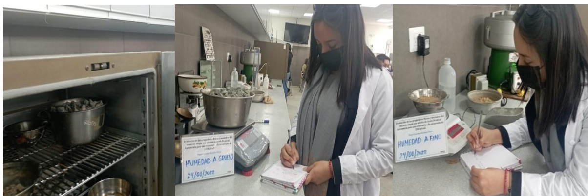
Ilustración 8 Pesaje de muestra seca para ensayo de humedad
