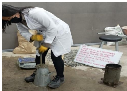
Ilustración 14 Varillado de concreto para ensayo de Asentamiento
