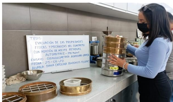
Ilustración 7 Tamizado de agregados y pesaje de muestra retenida
