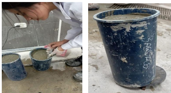
Ilustración 15 Toma de agua exudada en la superficie
