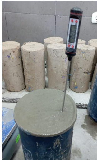
Ilustración 20 Toma de temperatura a probeta de concreto en estado fresco
