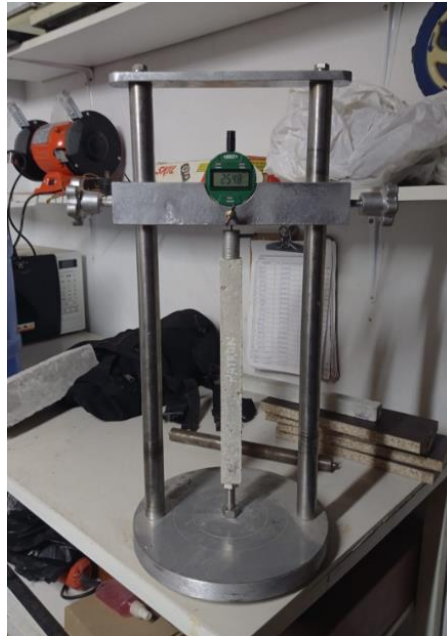
Ilustración 25 Máquina medidora de cambios de longitud
