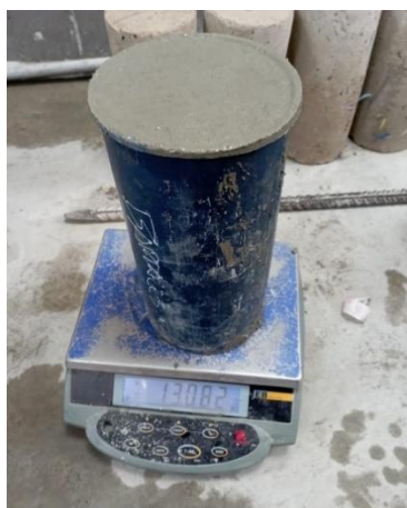
Ilustración 19 Pesaje de probeta de concreto para ensayo de peso unitario
