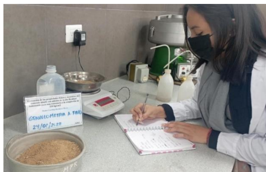
Ilustración 6 Secado y pesaje de muestra para granulometría de finos
