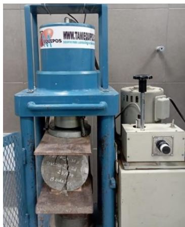
Ilustración 24 Ensayo de tracción indirecta por compresión diametral
