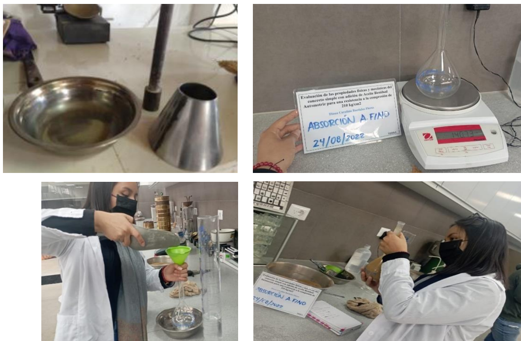
Ilustración 10 Ensayo de peso específico del agregado fino
