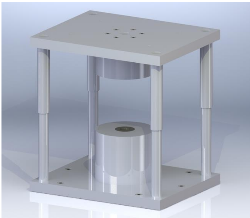
Figura 31. Propuesta de matriz de bocina con pestaña realizada en SolidWorks
