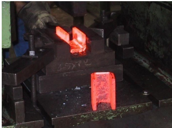
Figura 48. Imagen referencial para forjado en caliente
