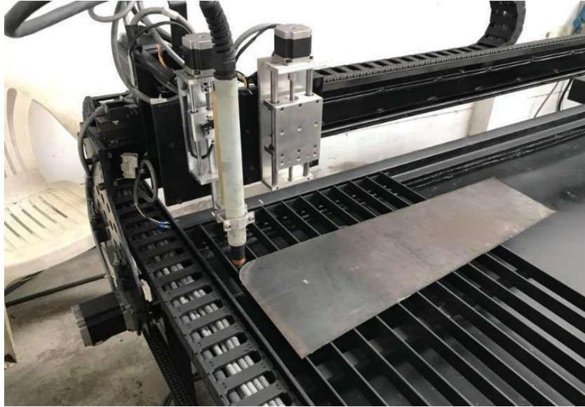
Figura 10. Máquina de corte por plasma CNC de alta precisión
