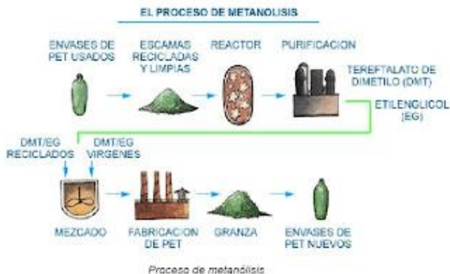
Ilustración 6: Proceso de Metanolisis Fuente: Tecnología de los plásticos
