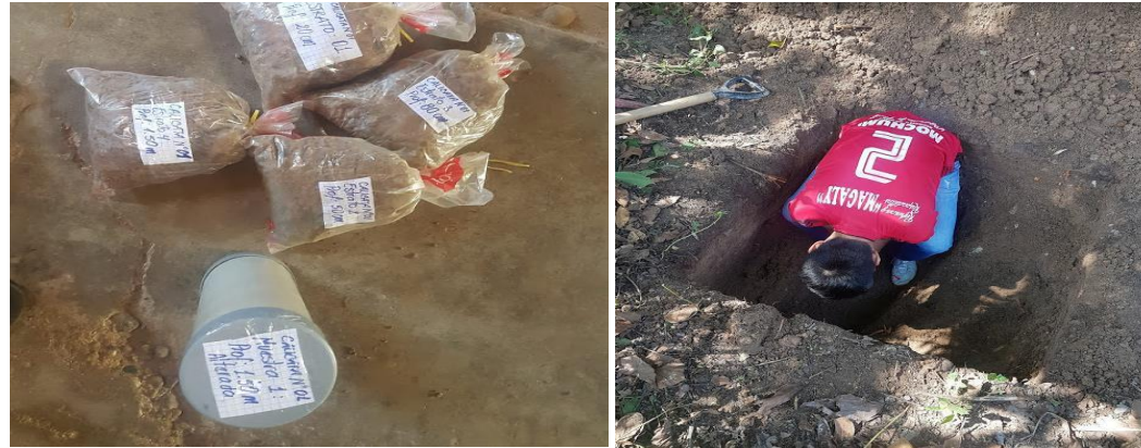
Figura 44 Empaquetado de muestras alteradas e inalteradas para ser sometidas a los ensayos de mecánica de suelos respectivos.
