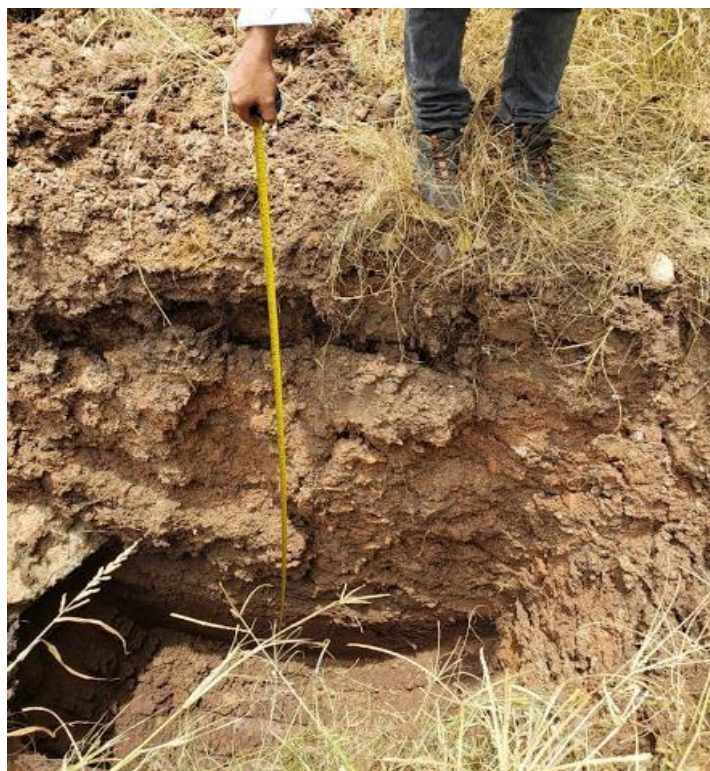
Figura 43 Vista de calicata C-03, predomina material arcilloso.
