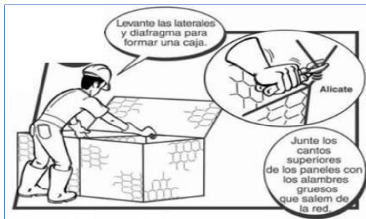
Figura 23 Formación de la caja metálica
