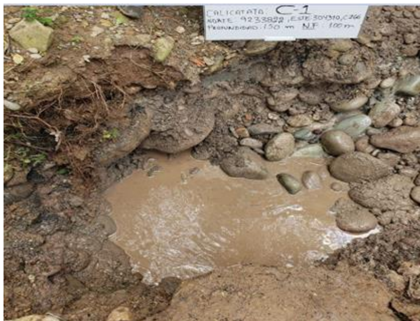
Figura 39 Vista de calicata C-01, predomina material granular gravosos y arenoso.
