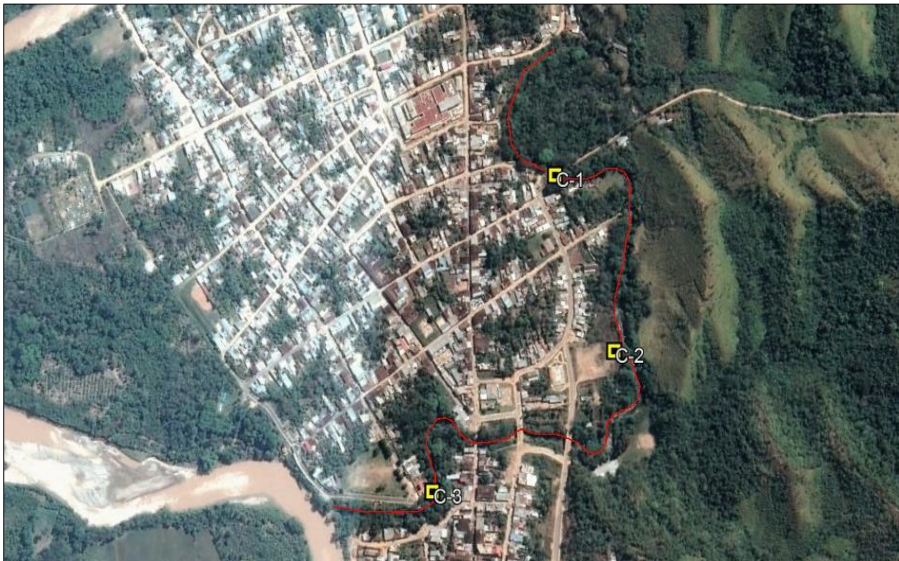
Figura 45 Ubicación de calicatas excavadas.
