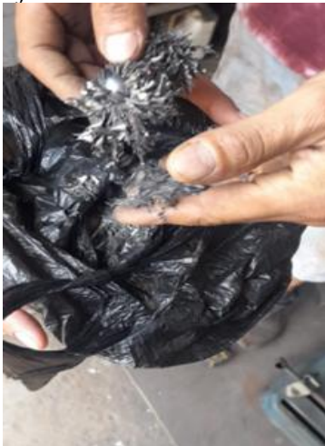
Ilustración 12 Selección del material ferroso mediante un imán
