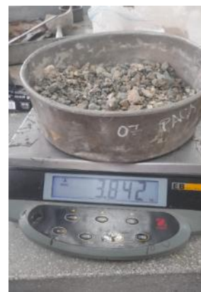
Ilustración 25 Pesaje a las 500 revoluciones
