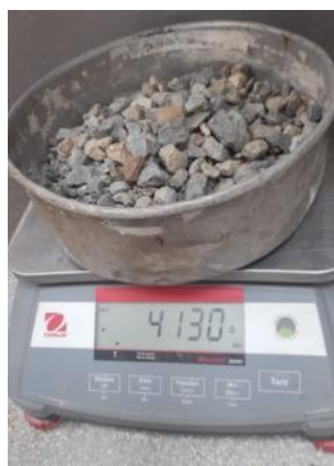
Ilustración 26 Pesaje a las 200 revoluciones
