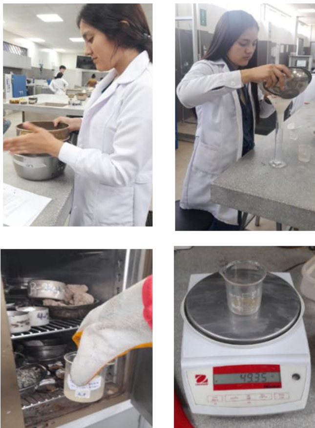
Ilustración 22 Ensayo sales solubles totales
