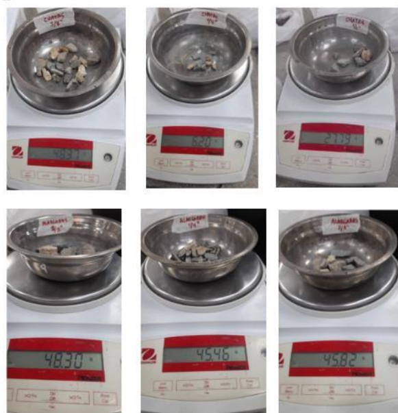
Ilustración 28 Peso de las partículas chatas y alargadas de 1/2", 1/4" y 3/8"
