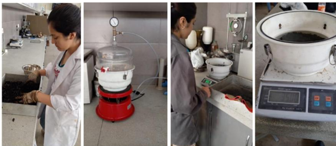
Ilustración 61 Proceso para determinar gravedad específica
