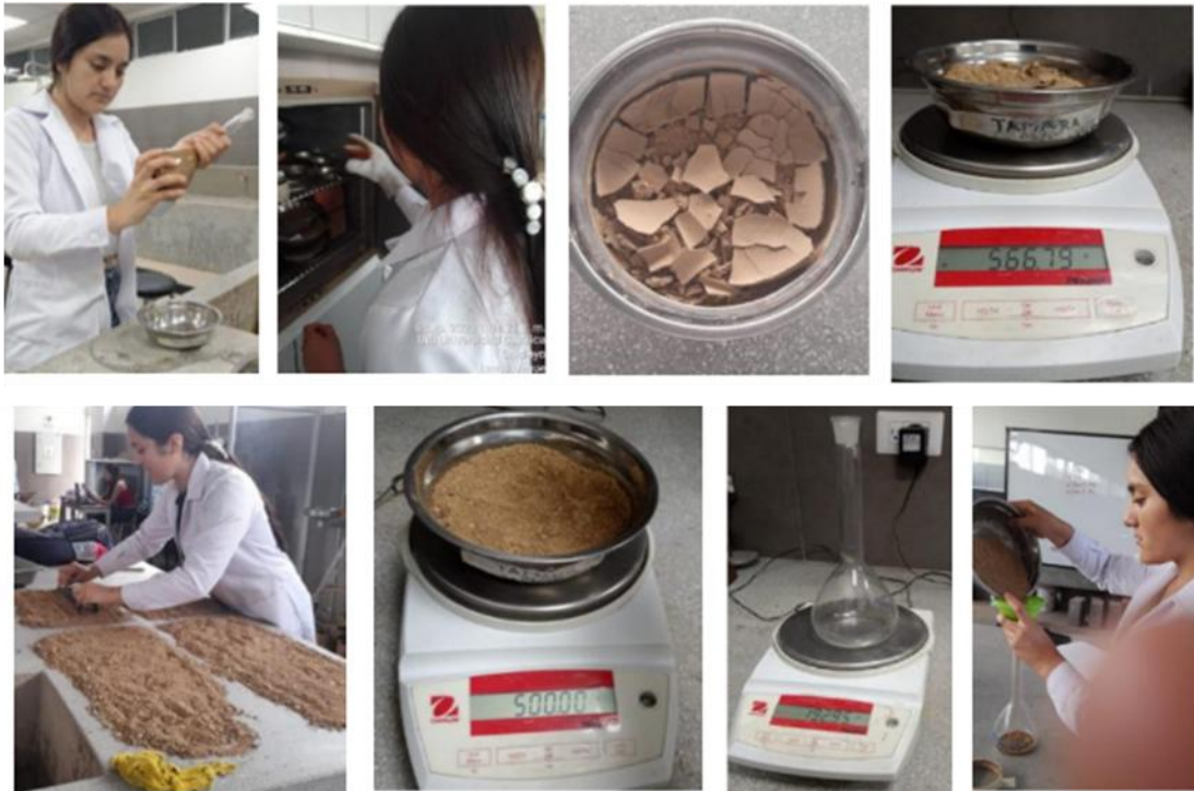
Ilustración 51 Proceso para determinar el ensayo de absorción de agregado fino
