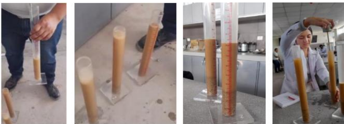
Ilustración 46 Lectura del nivel en el que la arena se asienta con ayuda del pizón
