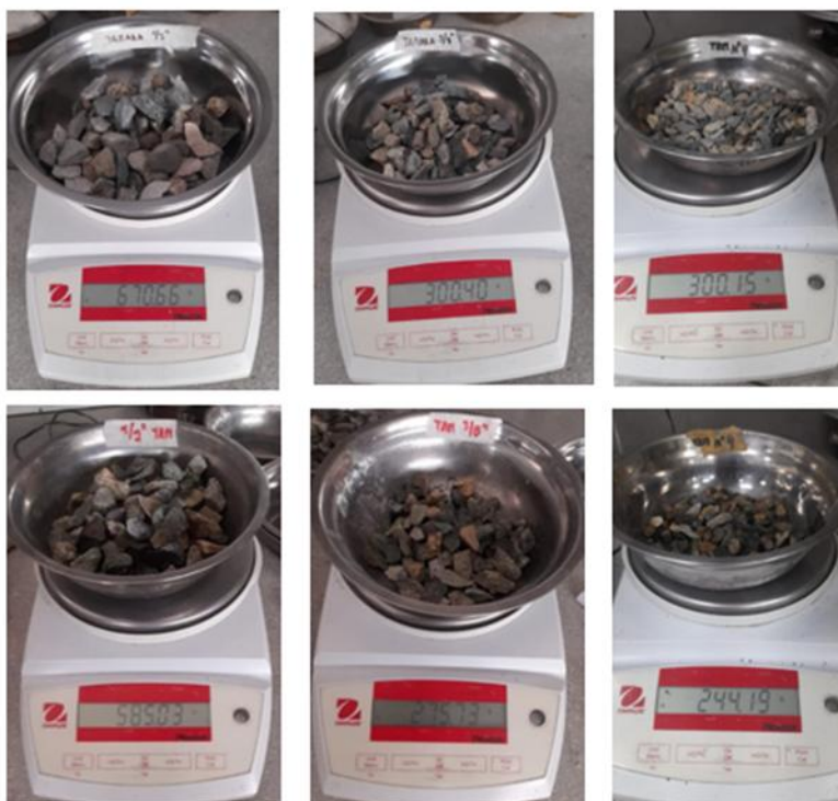
Ilustración 32 Pesaje antes y después del ensayo de durabilidad
