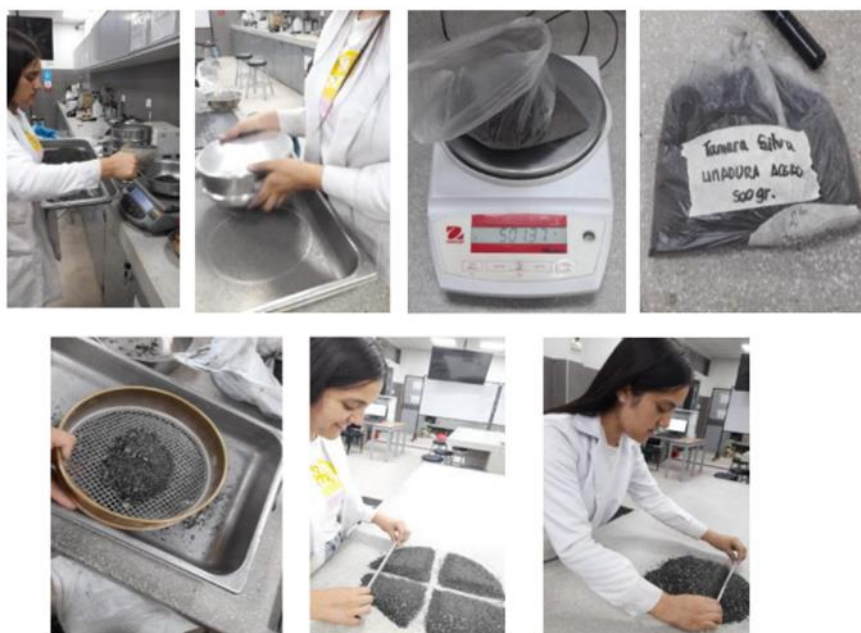
Ilustración 57 Preparación de la muestra de acero para caracterización
