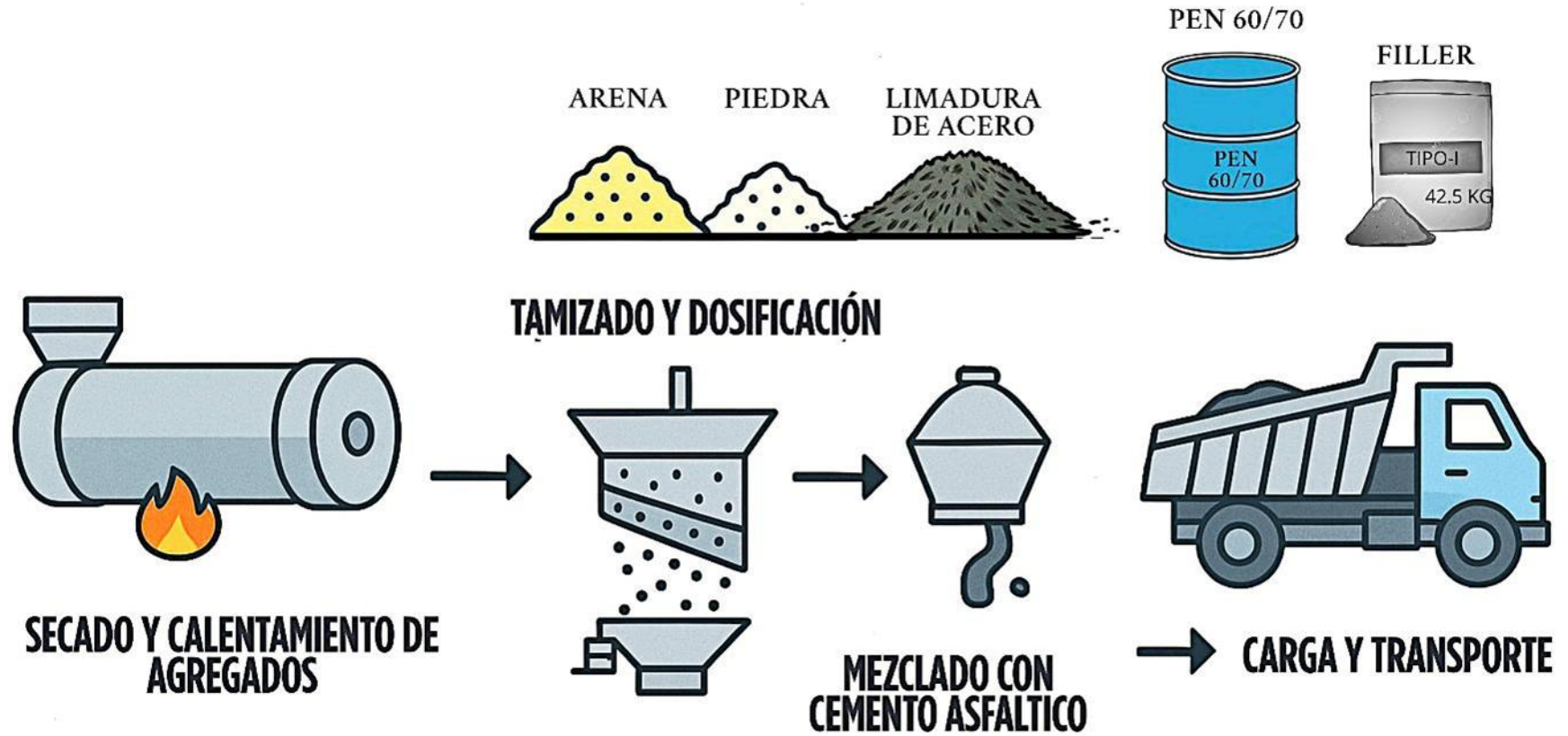
Ilustración 5 Fase inicial del proceso de mezclado de MAC
