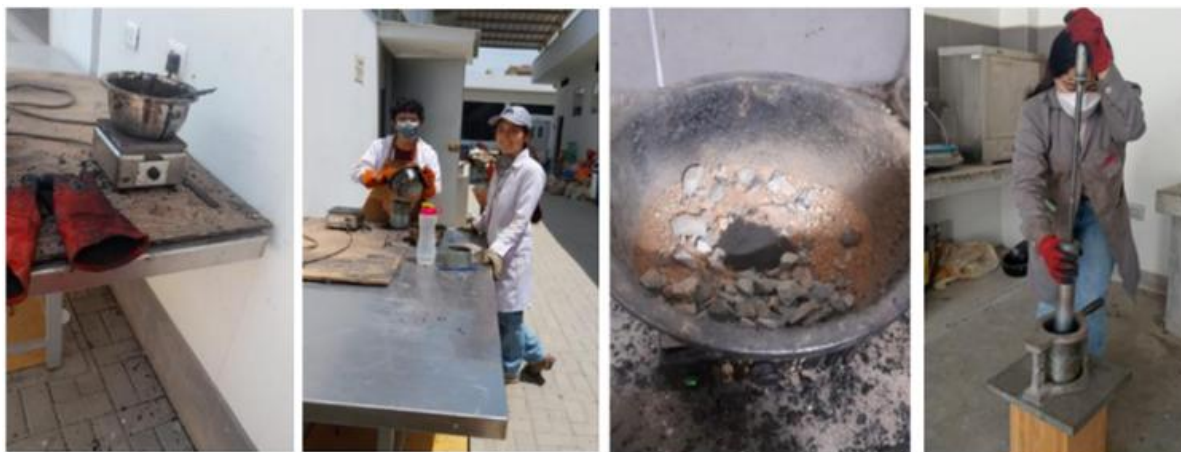
Ilustración 59 Elaboración de briquetas
