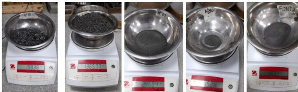
Ilustración 58 Proceso para determinar la granulometría de la limadura de acero
