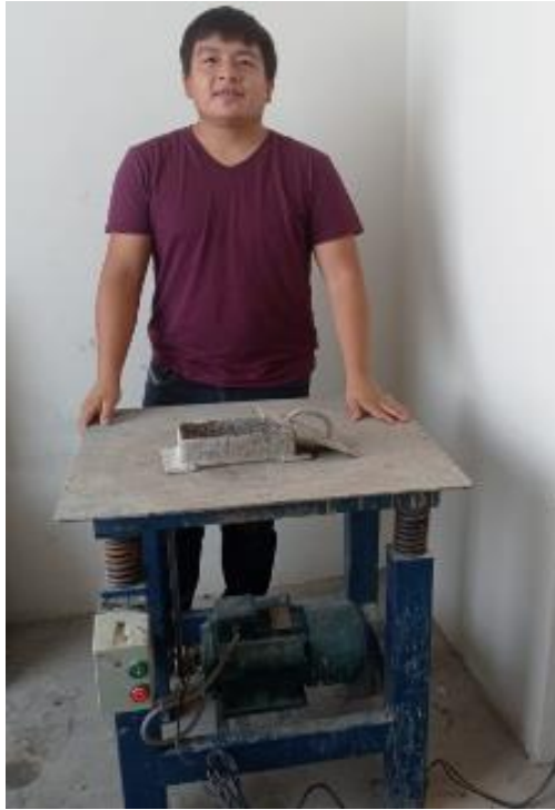
FIGURA N°36: Vibrado de los adoquines de concreto
