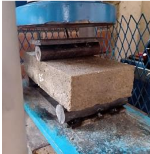
FIGURA N°40: Ensayo de módulo de rotura del adoquín
