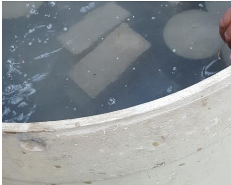
FIGURA N°37: Curado de adoquines de concreto
