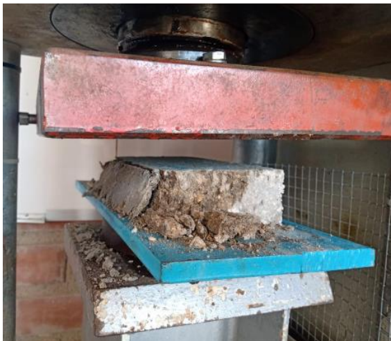
FIGURA N°39: Rotura en el ensayo de resistencia a la compresión
