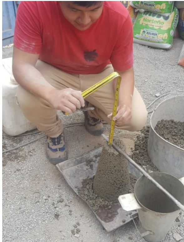
FIGURA N°38: Ensayo de asentamiento
