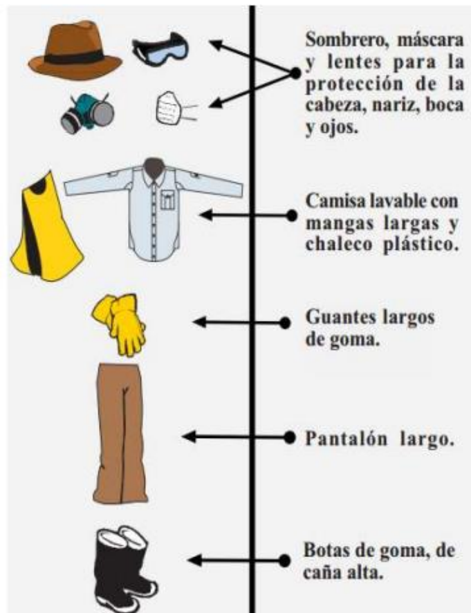
Figura 6: Equipo de protección
