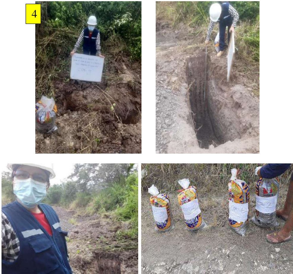
Figura 31 Excavación de las 4 calicatas (C-4)
