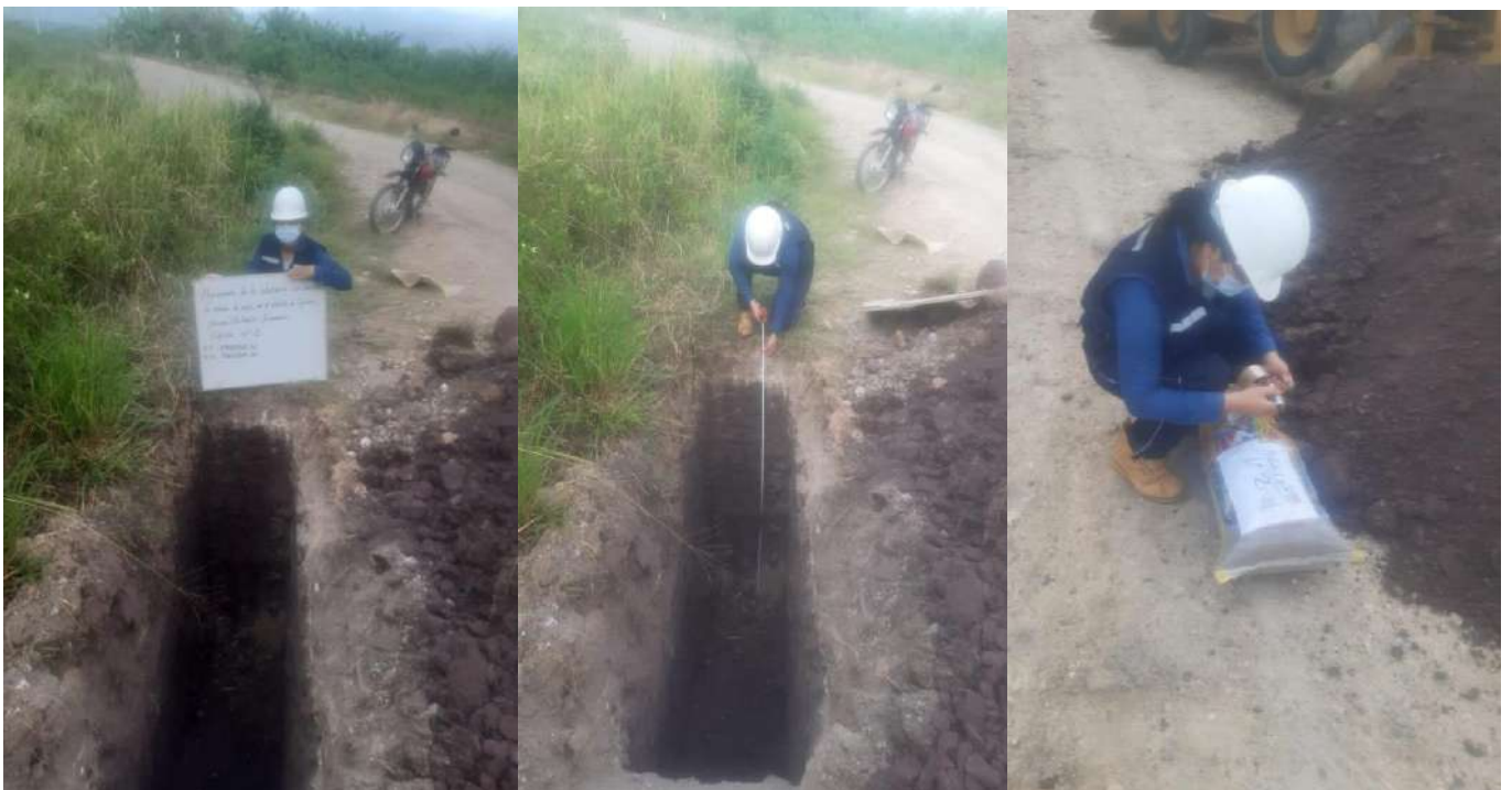
Figura 12 Excavación de la calicata2
