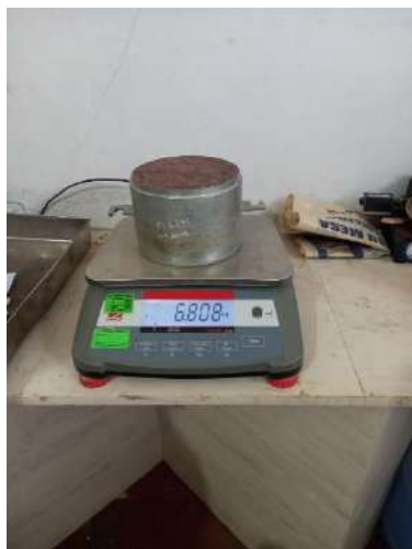
Figura 27 Ensayo de Proctor Modificado
