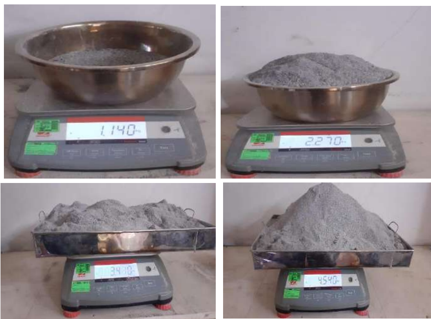
Figura 33 Peso de las CCA para adicionar a las muestras de la calicata N°2
