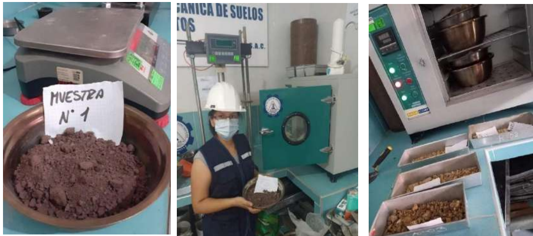
Figura 22 Determinación del contenido de Humedad
