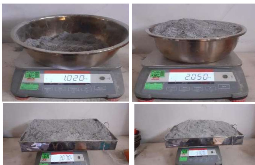
Figura 34 Peso de las CCA para adicionar a las muestras de la calicata N°4
