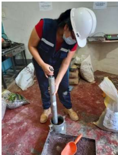
Figura 27 Ensayo de Proctor Modificado
