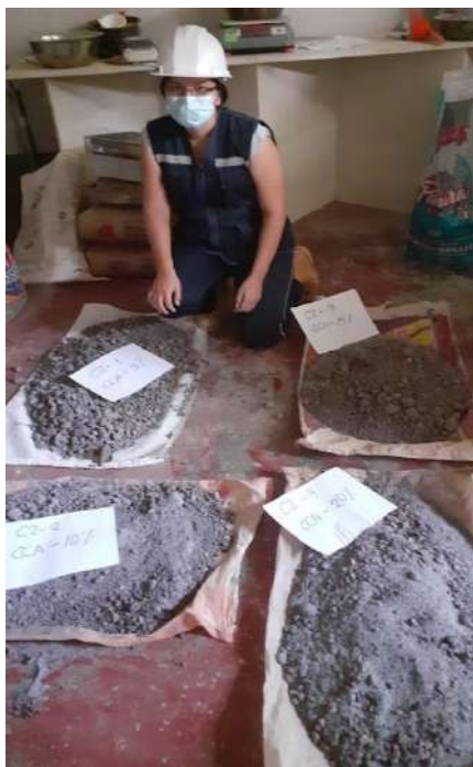
Figura 35 Preparación de las muestras (C-2) con los porcentajes correspondientes
