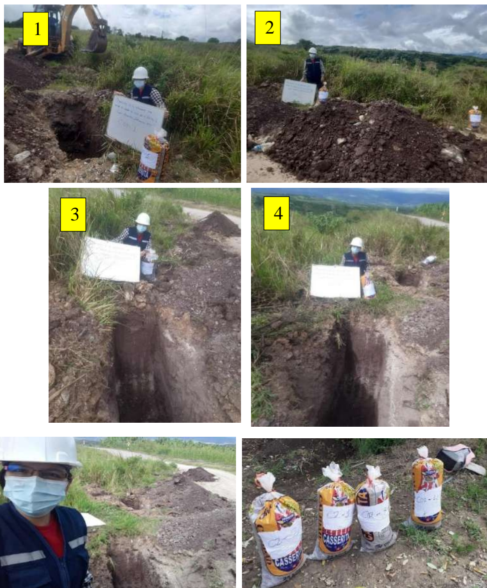
Figura 29 Excavación de las 4 calicatas (C-2)
