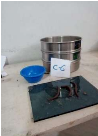
Figura 26 Determinación del Límite Plástico
