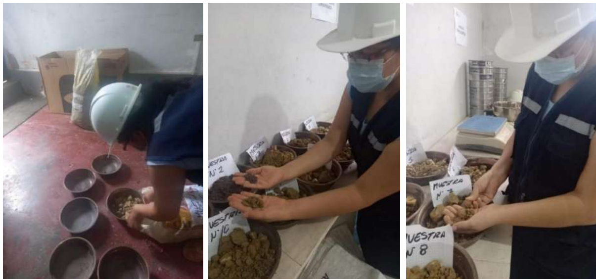
Figura 21 Análisis de las muestras para realizar el perfil estratigráfico
