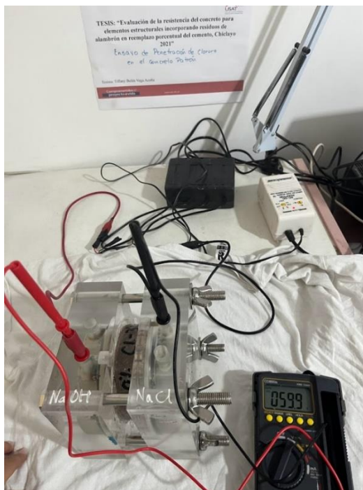
Fotografía 9 Penetración de Cloruros en el concreto
