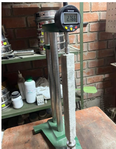
Fotografía 10 Expansión de mortero por ataque por sulfatos
