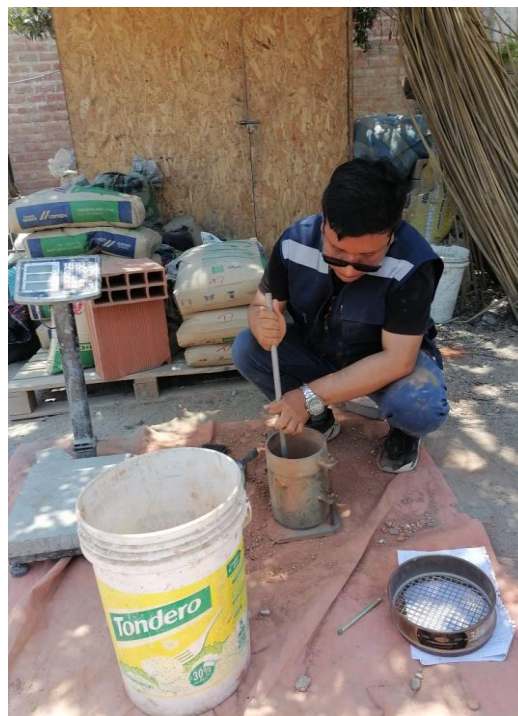
Imagen 14. Varillado del PUC de las baldosas cerámicas
