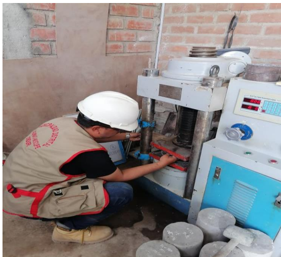
Imagen 21. Rotura de adoquines
