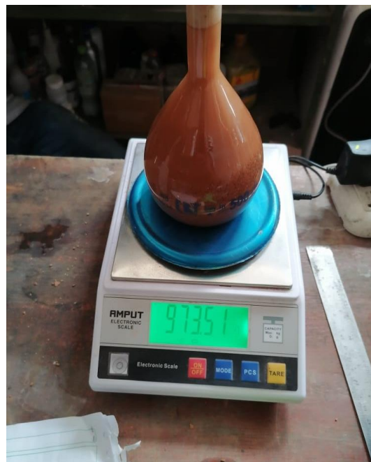
Imagen 16. Peso de las Baldosas cerámicas en la fiola + agua
