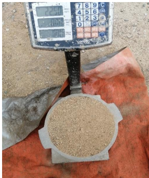
Imagen 10. PUS del Ag.Fino (sin varillar)
