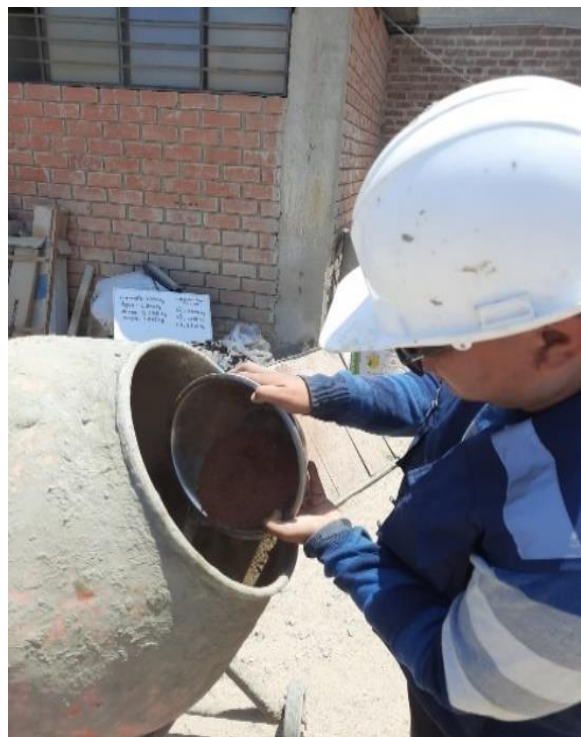
Imagen 18. Adición de las baldosas cerámicas a la mezcla
