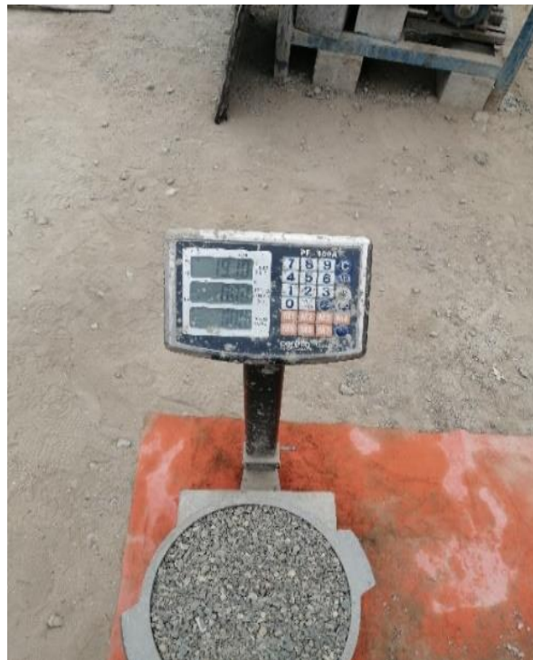
Imagen 12. PUS del agregado grueso ( sin varillar)
