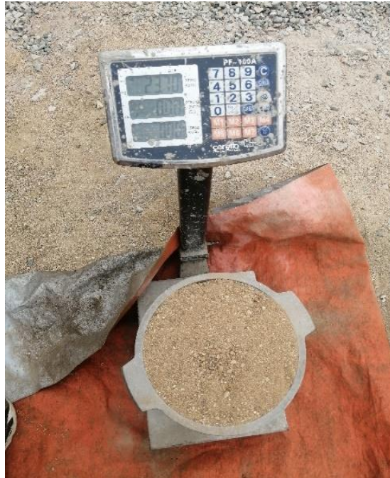
Imagen 11. PUC del Ag.fino (varillado)
