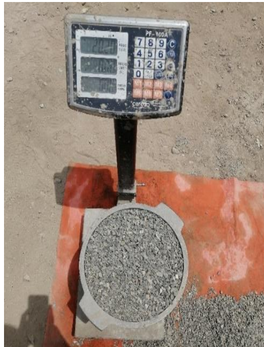
Imagen 13. PUC del Ag.grueso (varillado)
