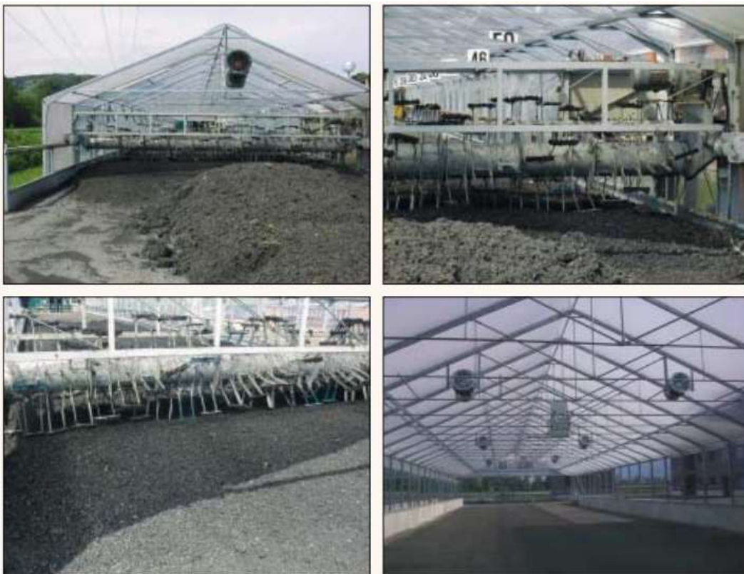
Figura 29: Modelo de secador solar de lodos SRT.
