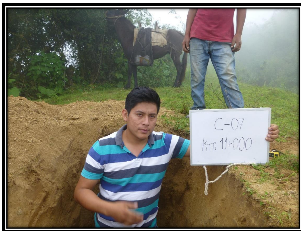
Fotografía N° 54: Excavación de la calicata N° 7
