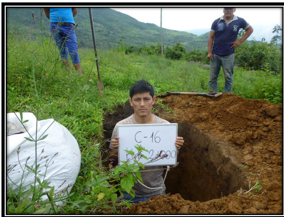
Fotografía N° 56: Excavación de la calicata N° 16
