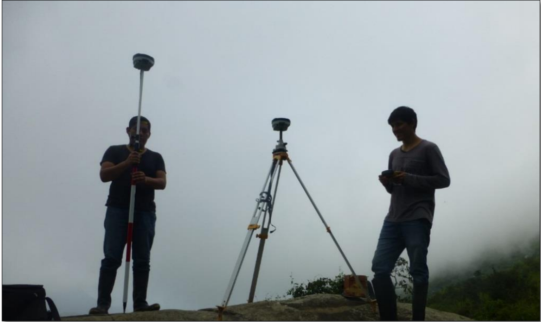
Fotografía N° 15: Paso N°1: Estacionamos el trípode en roca fija, nivelamos la Base
