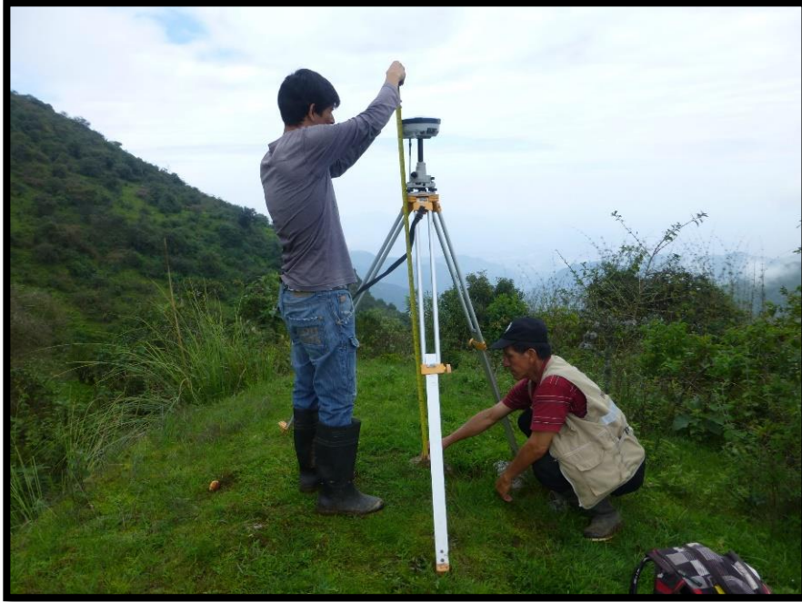
Fotografía N° 11: Paso N°2.- Medimos altura de la base
