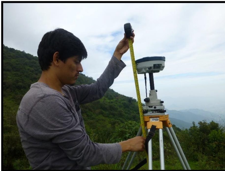
Fotografía N° 16: Paso N°2.- Medimos altura de la base
