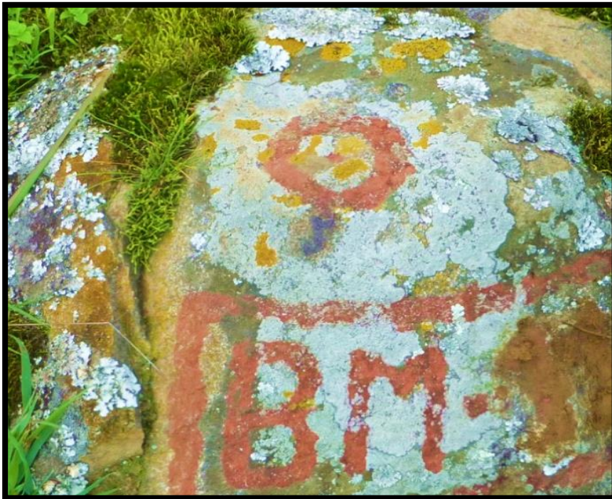
Fotografía N° 12: Paso N°3.- Al nuevo BM de El marco lo enlazamos al BM ya establecido en Shita Alta.
