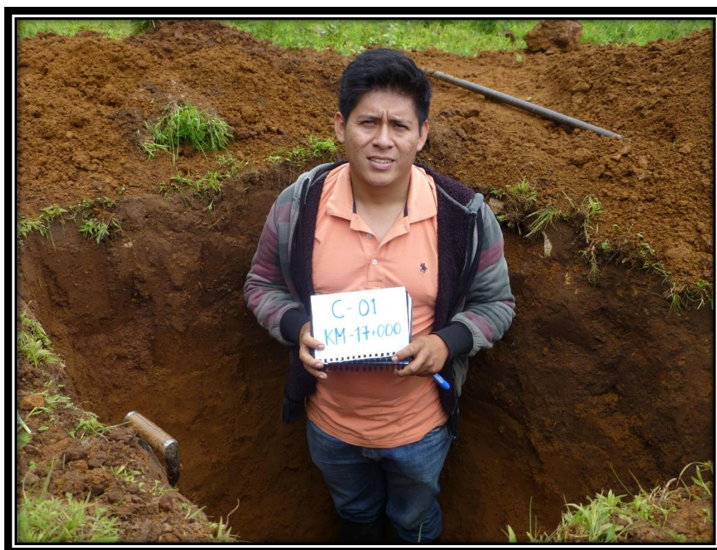
Fotografía N° 52: Excavación de la primera calicata N°1
