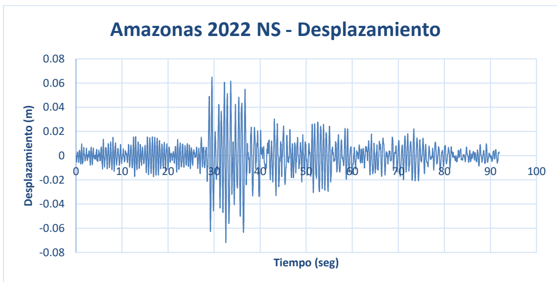
Figura 128 Desplazamiento NS Amazonas 2022
