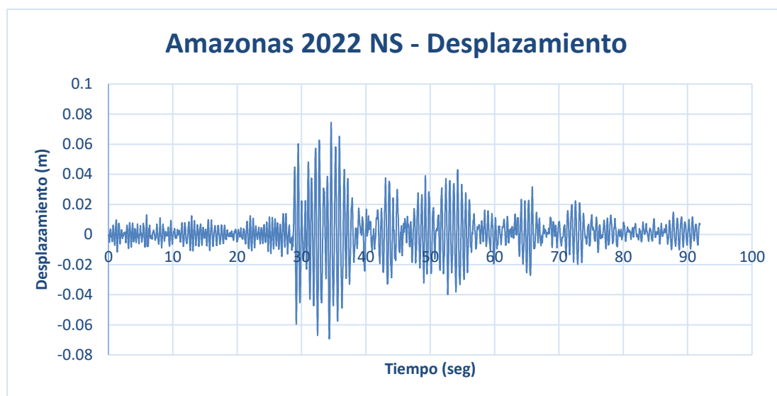
Figura 110 Desplazamiento NS Amazonas 2022
