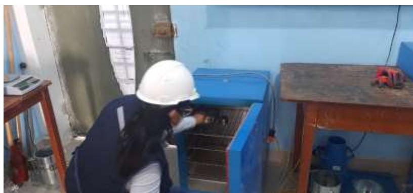
Figura 147 Ensayo de límites de la humedad extraída
