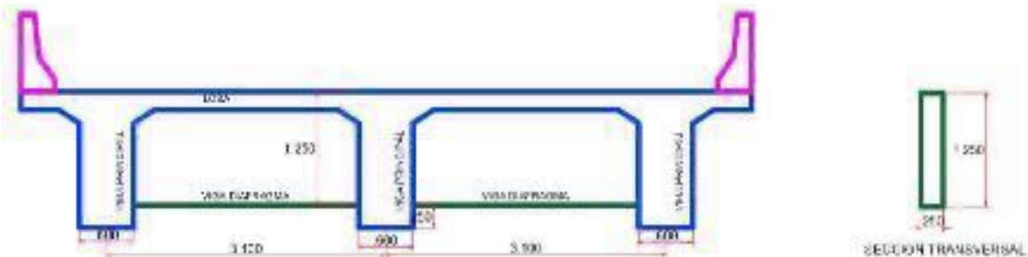
Figura 8.62 Viga diafragma en el puente
