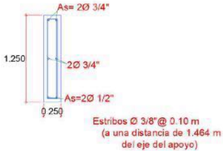
Figura 8.67 Armadura longitudinal y transversal en viga diafragma.
