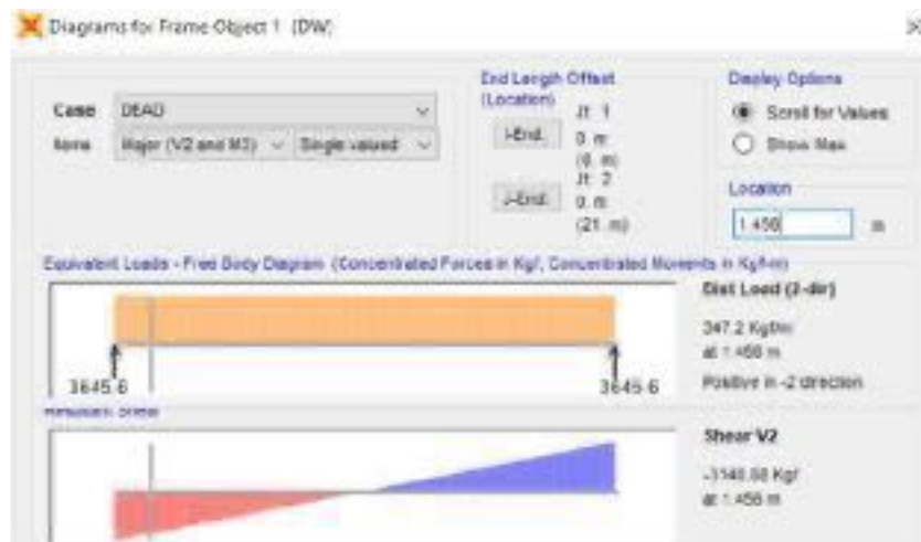
Figura 8.21 Cargas DW para calcular el corte en la sección crítica.
