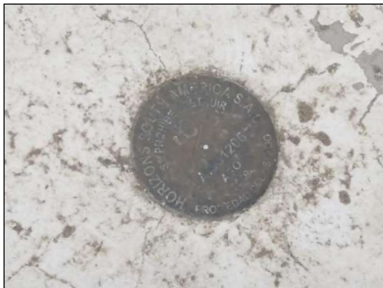
Imagen 5 Punto UTM usada para la georreferenciación del Levantamiento Topográfico.
