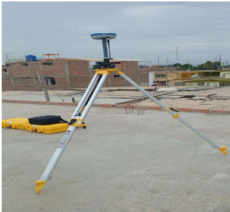
Fotografía 8 Equipo GPS Diferencial Stonex S9
