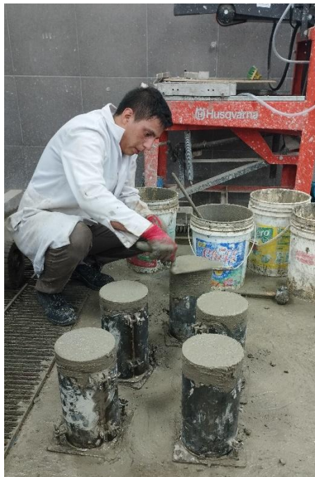
Ilustración 22. Elaboración de testigos de concreto (Adiciones de SDP)
