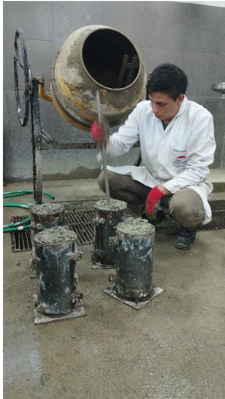
Ilustración 21. Elaboración de probetas cilíndricas (Concreto patrón)
