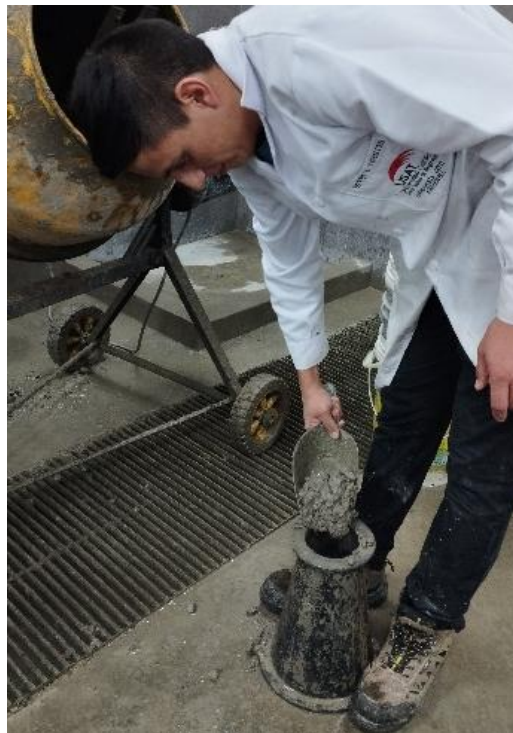
Ilustración 20. Ensayo de asentamiento con el cono de Abrams
