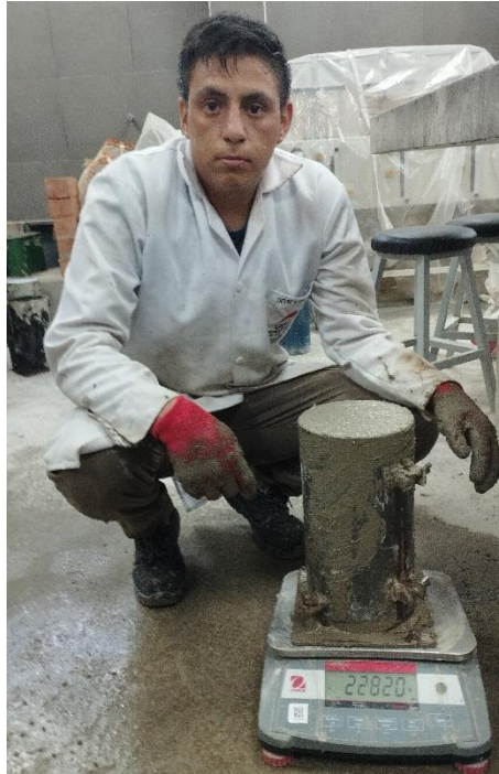
Ilustración 23. Pesado de las probetas de concreto en estado fresco
