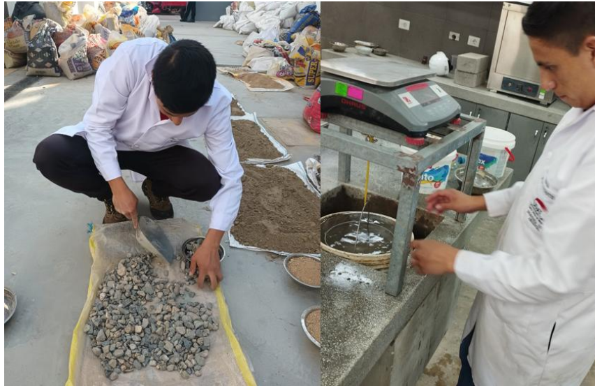
Ilustración 19. Ensayos del agregado grueso
