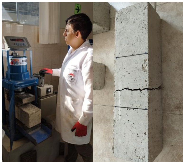
Ilustración 26. Ensayo de resistencia a la flexión del concreto
