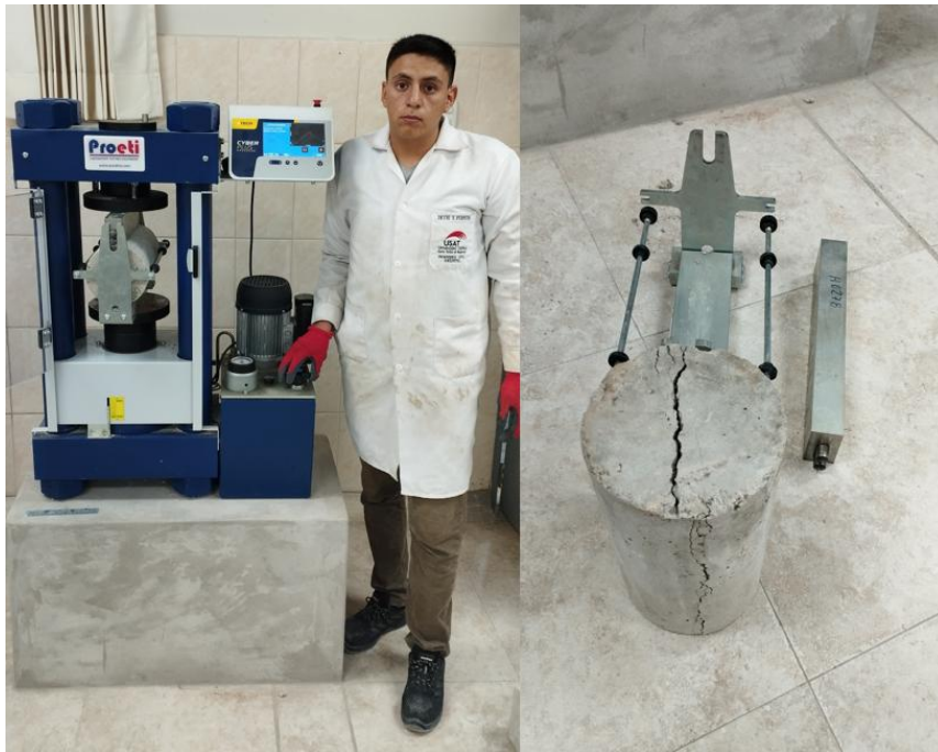
Ilustración 25. Ensayo de resistencia a la tracción directa del concreto
