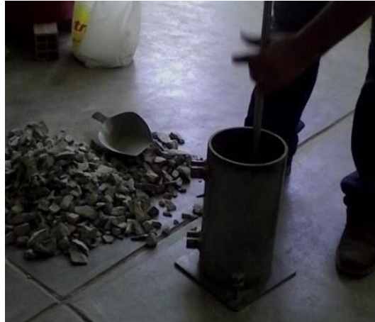
FIGURA 15. Varillado de la muestra
