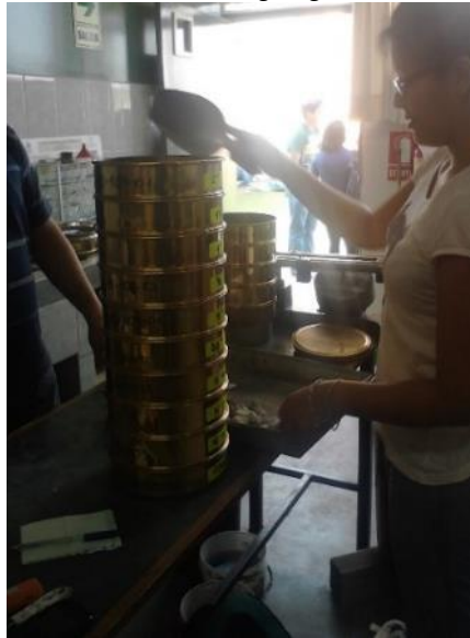
FIGURA 05. Colocación del agregado fino en los tamices
