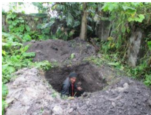
FIGURA 23. Excavación de la calicata N° 03
