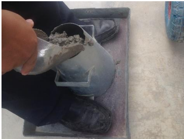
FIGURA 25. Llenado del cono de Abrams
