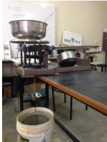
FIGURA 21. Peso de la muestra saturada dentro del agua + canastilla
