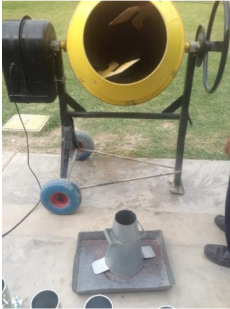
FIGURA 24. Fijación del cono de Abrams para colocación de la mezcla
