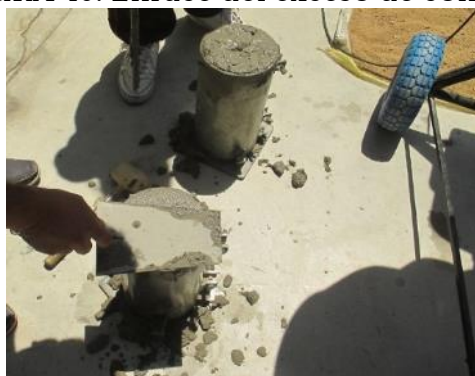
FIGURA 40. Enrase del exceso de concreto
