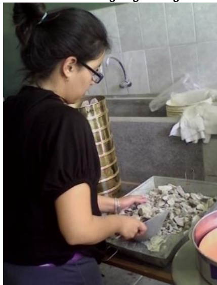
FIGURA 06. Colocación del agregado grueso en los tamices
