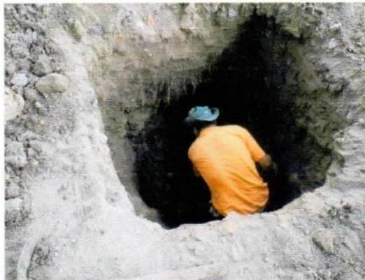
Fig. N° 1.2.- Calicata de exploración. Fuente.- Elaboración propia.
