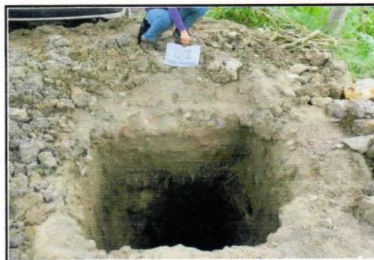
DESCRIPCION FOTO EXCAVACION CULMINADA EN CALICATA 02. 7
