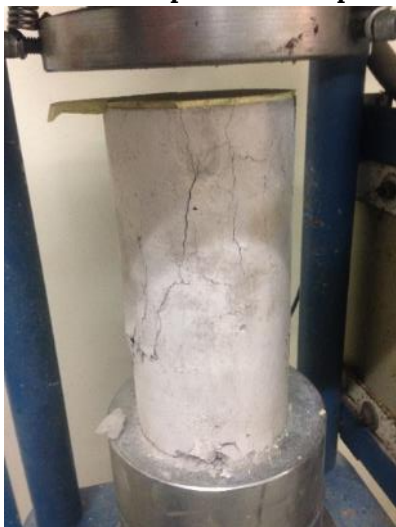
FIGURA 51. Ruptura de la probeta
