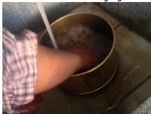
FIGURA 03. Lavado del agregado fino
