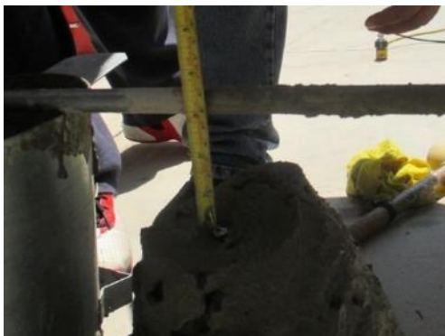
FIGURA 30. Medida del asentamiento
