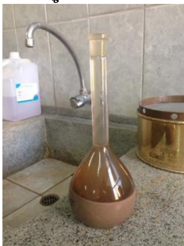
FIGURA 19. Muestra de arena para peso específico en fiola con agua destilada
