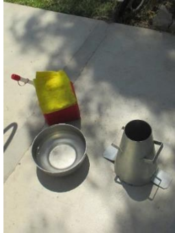
FIGURA 23. Limpieza y humedecimiento del cono de Abrams
