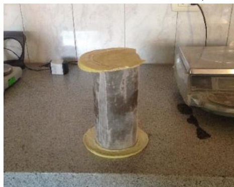
FIGURA 49. Probeta con mortero de azufre y bentonita
