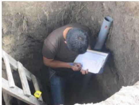
FIGURA 21. Toma de la muestra de la calicata N° 02
