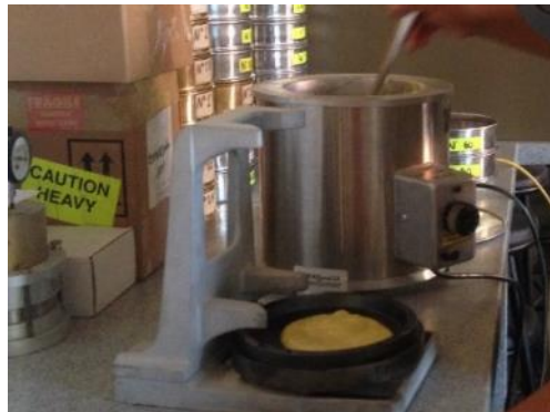
FIGURA 48. Colocación de la mezcla en el molde
