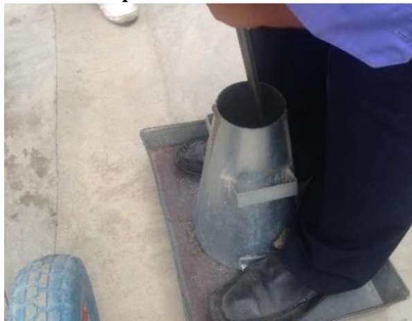
FIGURA 26. Compactación de la mezcla con varilla
