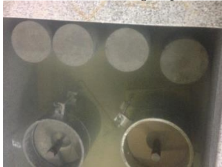
FIGURA 44. Puesta en agua para curado
