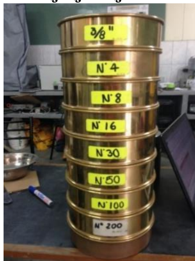
FIGURA 02. Mallas empleadas para el análisis granulométrico del agregado grueso
