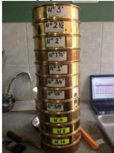
FIGURA 01. Mallas empleadas para el análisis granulométrico del agregado fino
