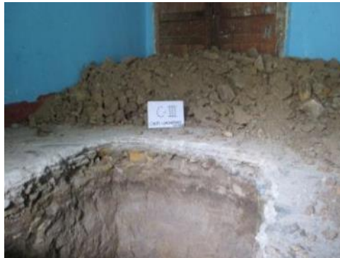
FIGURA 19. Muestreo en la calicata N° 01
