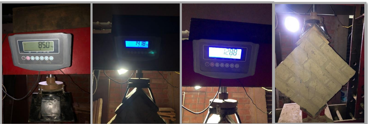
Figure 37 Anexo 7. Resistencia a la tracción en muretes
