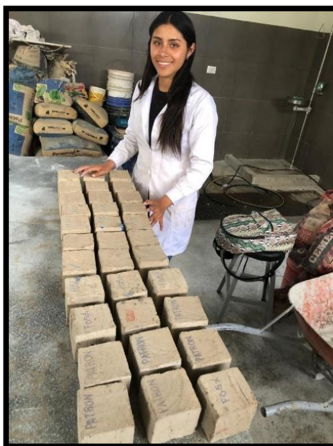
Figure 10 Especímenes cúbicos antes de ser ensayados
