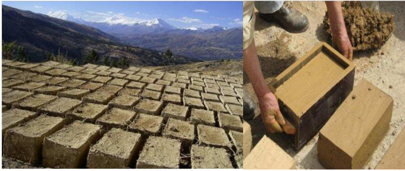
Figure 1 Secado natural y desmolde de adobe
