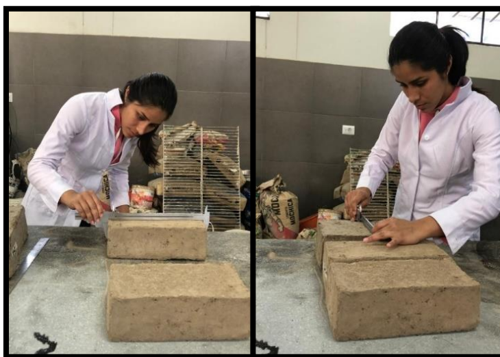
Figure 12 Toma de medida para variación dimensional y alabeo
