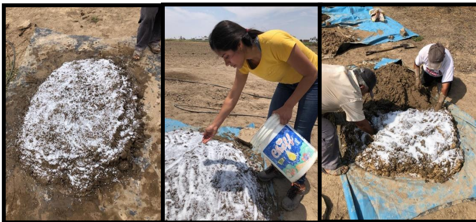
Figure 29 Anexo 6. Adición del 0.5%, 1% y 1.5% de gránulos PEAD
