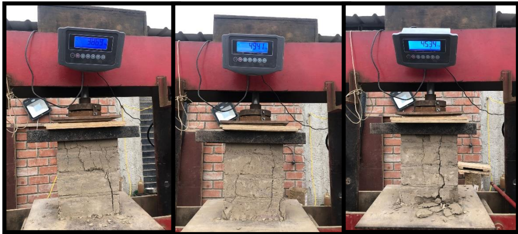
Figure 36 Anexo 7. Ensayo resistencia a la compresión en pilas
