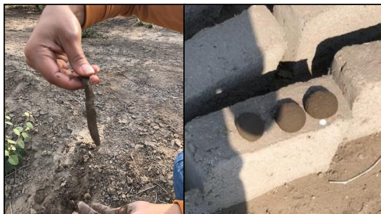
Figure 5 Pruebas para selección del suelo
