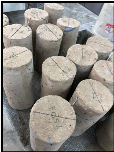
Figure 11 Especímenes de probetas antes de ser ensayadas
