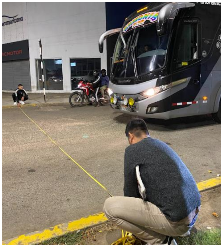
FIG. 16: TOMANDO LA MEDIDA DE CARRIL DE APROXIMACIÓN – AV. LORA Y LORA
