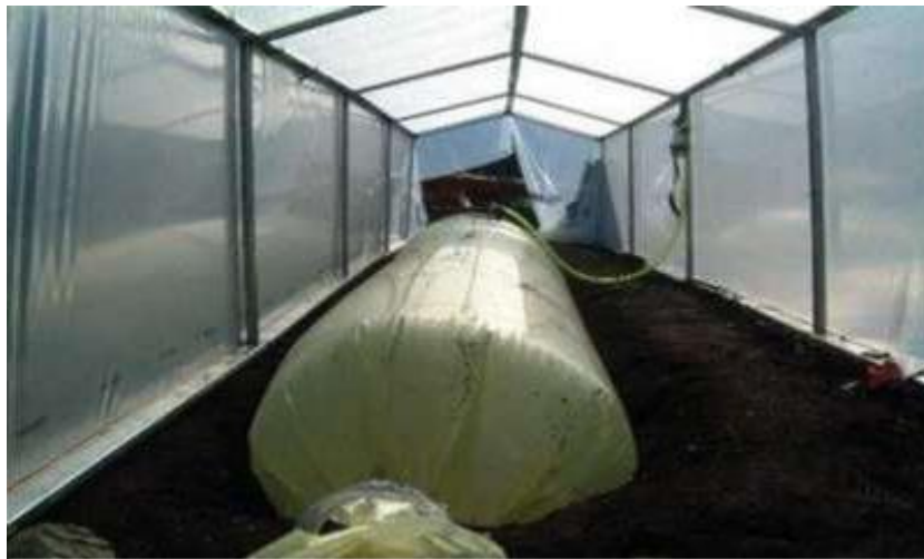
Figura 6: Biodigestor en bolsa doble de polietileno de bajo costo, modelo Taiwán.
