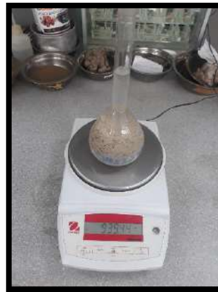
Figura N° 16: Peso de la Fiola + Peso de la Muestra + Agua
