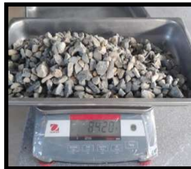
Figura N° 40: Peso de la muestra seca
