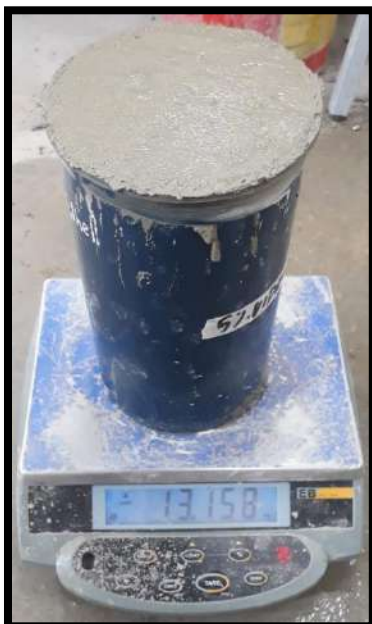
Anexo 17.4: Concreto 5% V y 30% RCD
