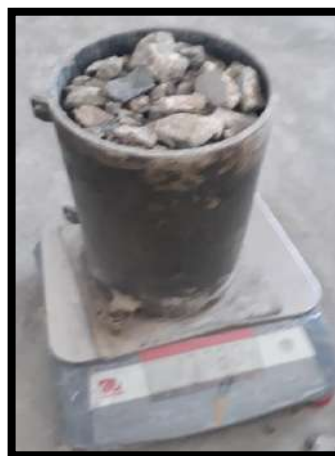
Figura N° 23: Peso unitario compactado húmedo 2 del RCD
