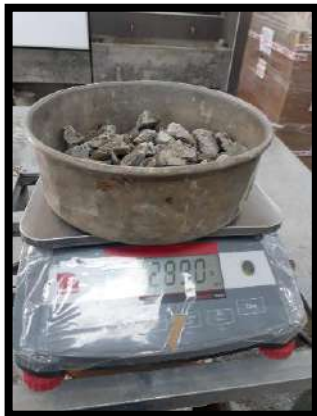
Figura N° 25: Peso de la muestra superficialmente seca
