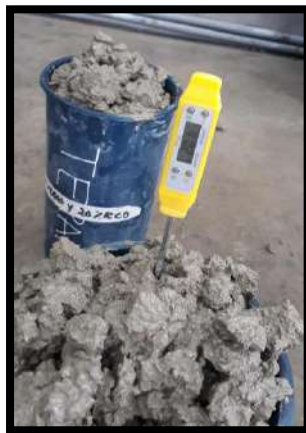
Figura N° 49: Temperatura del concreto
