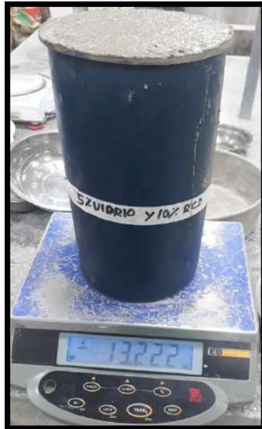
Anexo 17.2: Concreto 5% V y 10% RCD
