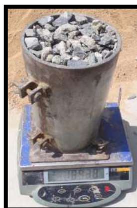
Figura N° 44: Peso unitario compactado húmedo 2 del agregado grueso
