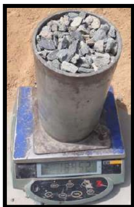
Figura N° 43: Peso unitario compactado húmedo 1 del agregado grueso
