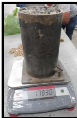
Figura N° 42: Peso unitario suelto húmedo 2 del agregado grueso
