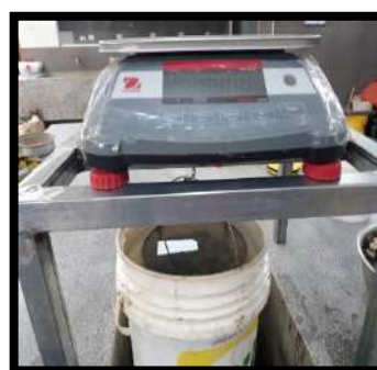
Figura N° 48: Peso de la muestra sumergida
