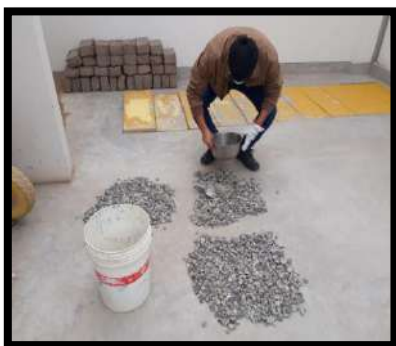
Figura N° 37: Cuarteo del agregado grueso
