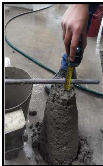
Anexo 16.10: Slump 1.5''- Concreto 15% V y 30%RCD
