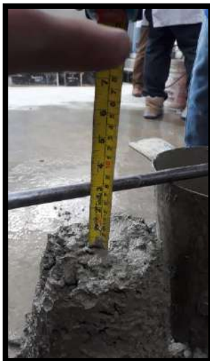
Anexo 16.2: Slump 2.75''- Concreto 5% V y 10% RCD
