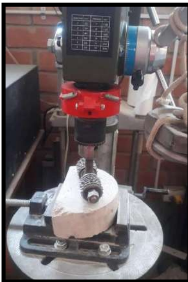
Figura N° 57: Abrasión al concreto
