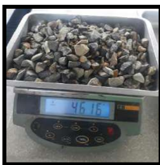
Figura N° 45: Peso de la muestra superficialmente seca
