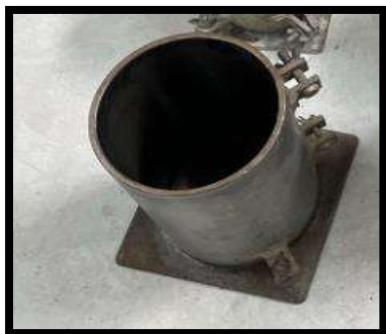
Figura N° 17: Moldes de 15 cm de diámetro y 30 cm de altura.
