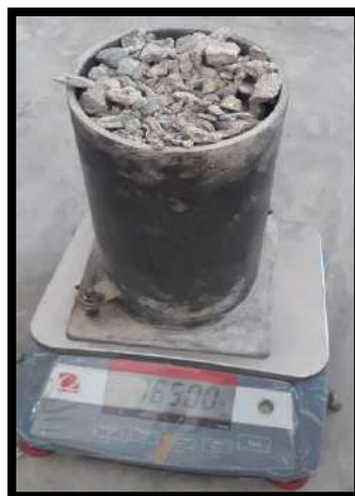
Figura N° 21: Peso unitario suelto húmedo 2 del RCD
