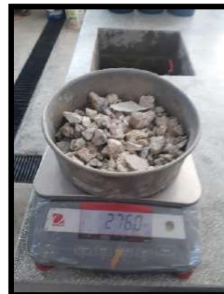
Figura N° 27: Peso de la muestra seca
