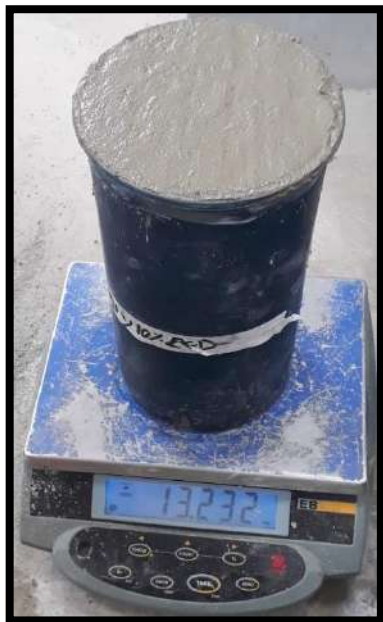
Anexo 17.7: Concreto 10% V y 30%RCD
