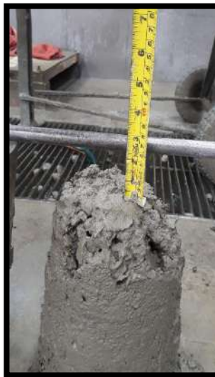
Anexo 16.5: Slump 2.5''- Concreto 10% V y 10% RCD
