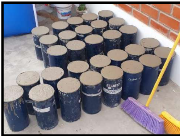
Figura N° 51: Probetas recién vaciadas
