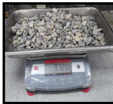
Figura N° 38: Peso de la muestra cuarteada + tara
