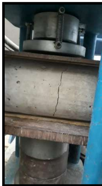
Figura N° 54: Falla a un lado de la probeta por tracción indirecta
