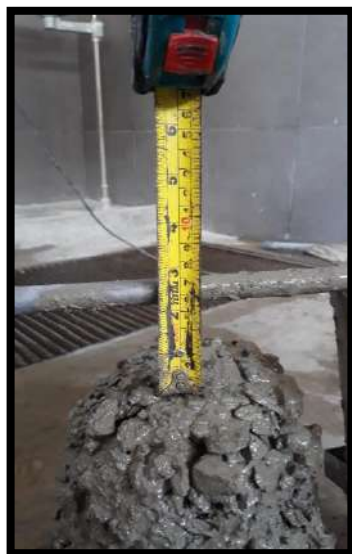
Anexo 16.9: Slump 2.5''- Concreto 15% V y 20%RCD
