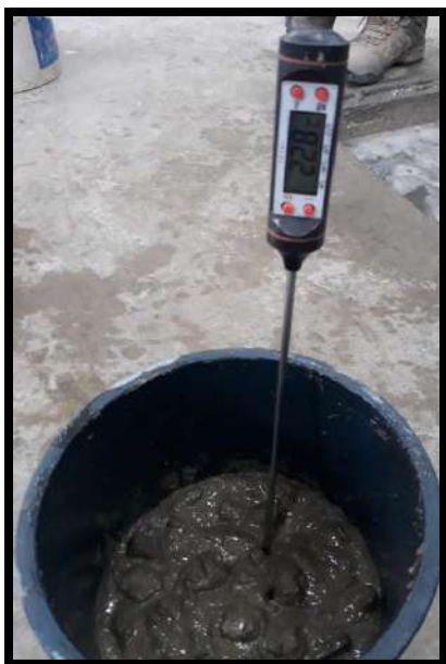
Anexo 18.9: Concreto 15% V y 20%RCD
