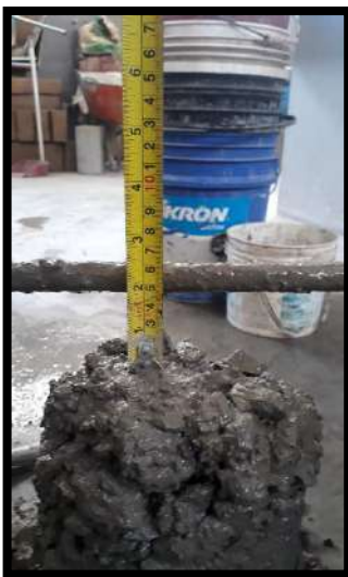
Anexo 16.4: Slump 2''- Concreto 5% V y 30% RCD
