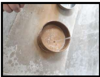
Figura N° 28: Muestra siendo lavada por la malla N°200
