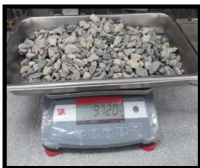
Figura N° 39: Peso de la muestra húmeda + tara
