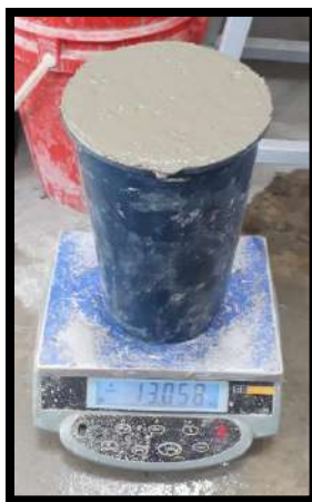
Figura N° 50: Peso unitario del concreto
