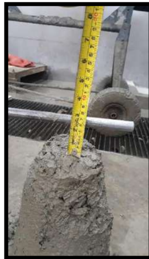
Anexo 16.3: Slump 2.5''- Concreto 5% V y 20% RCD
