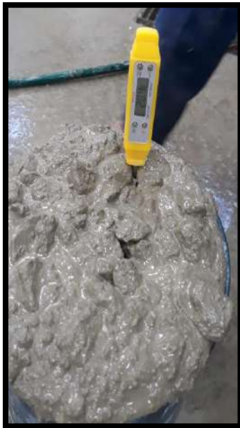
Anexo 18.4: Concreto 5% V y 30% RCD
