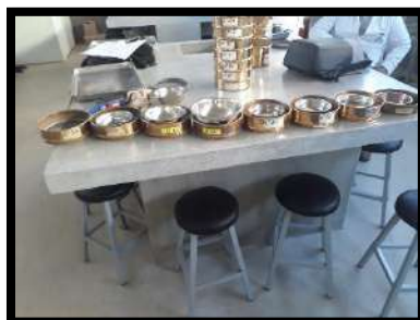
Figura N° 30: Muestra seca junto con los tamices
