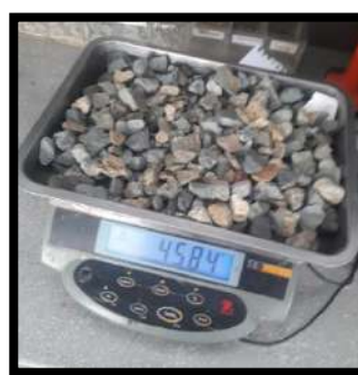
Figura N° 46: Peso de la muestra seca
