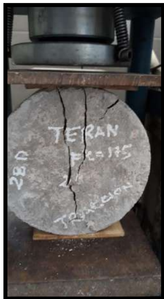
Figura N° 53: Falla por tracción indirecta
