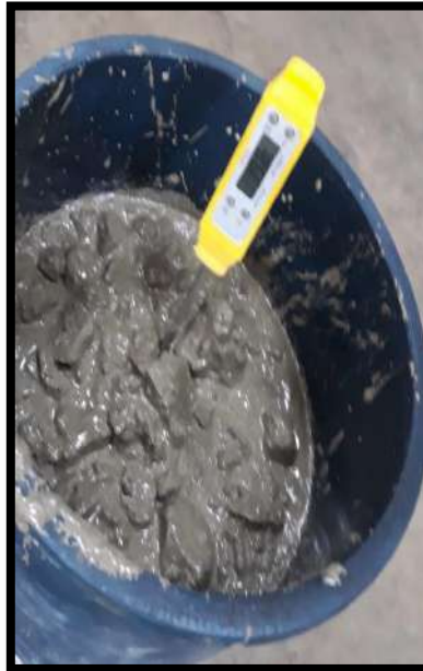
Anexo 18.2: Concreto 5% V y 10% RCD
