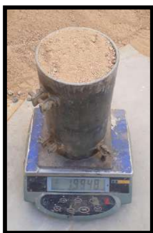
Figura N° 31: Peso unitario suelto húmedo 1 del agregado fino
