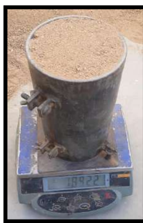
Figura N° 32: Peso unitario suelto húmedo 2 del agregado fino
