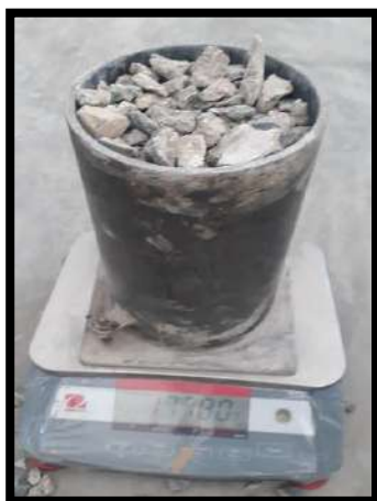
Figura N° 22: Peso unitario compactado húmedo 1 del RCD
