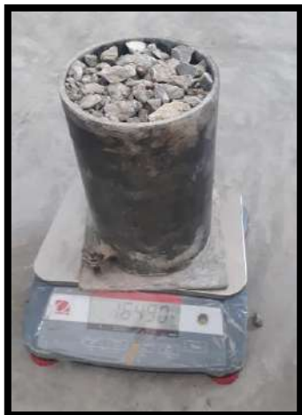
Figura N° 20: Peso unitario suelto húmedo 1 del RCD
