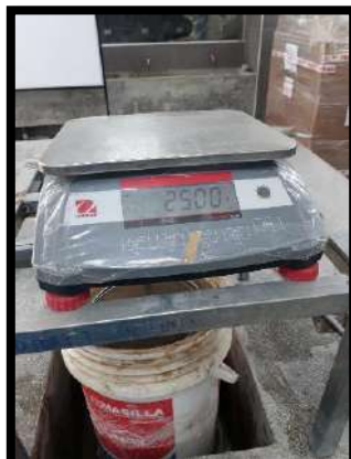
Figura N° 26: Peso de la muestra sumergida al agua
