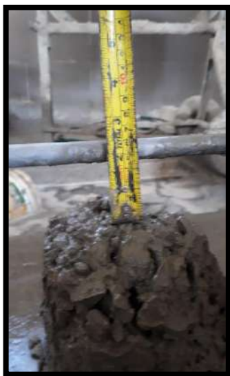
Anexo 16.7: Slump 2''- Concreto 10% V y 30%RCD
