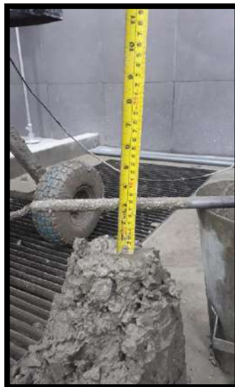
Anexo 16.8: Slump 3''- Concreto 15% V y 10%RCD
