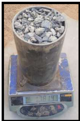
Figura N° 41: Peso unitario suelto húmedo 1 del agregado grueso
