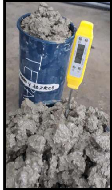
Anexo 18.3: Concreto 5% V y 20% RCD
