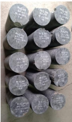
Figura 143: Rotura de probetas con diseño de 100%AR usando cemento GU y MS a los 7 días de curado
