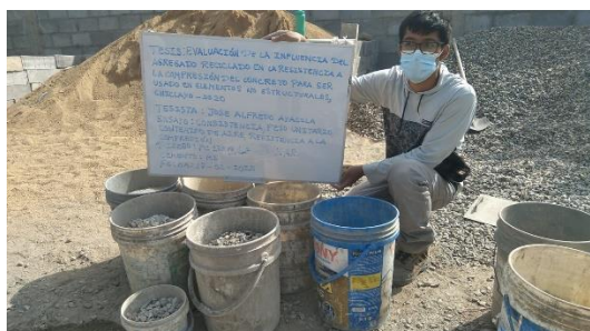
Figura 81: Materiales para tanda de muestra con reemplazo del 100% de AR usando cemento MS
