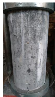
Figura 136: Rotura de una probeta con reemplazo del 75% de AR a los 28 días de curado
