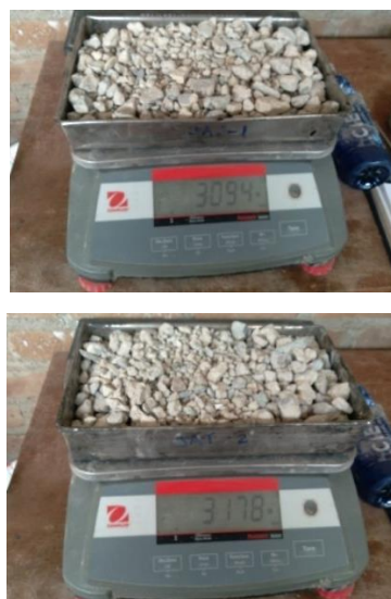
Figura 32: Peso seco del agregado grueso reciclado + recipientes
