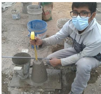
Figura 92: SLUMP de la muestra con reemplazo del 25% de AR usando cemento MS
