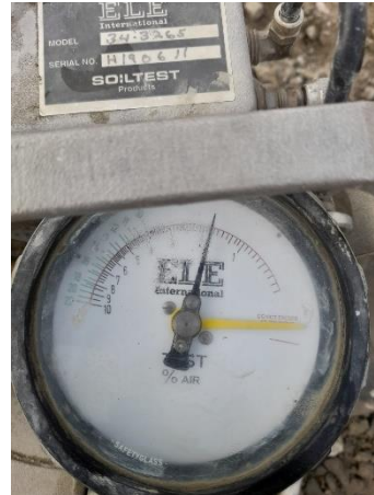
Figura 120: Contenido de aire de la muestra con diseño del 100% de AR usando cemento MS
