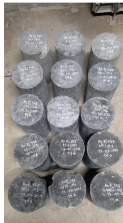
Figura 144: Rotura de probetas con diseño de 100%AR usando cemento GU y MS a los 14 días de curado
