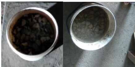
Figura 35: Peso de muestras 1 y 2 saturadas superficialmente secas -agregado grueso natural
