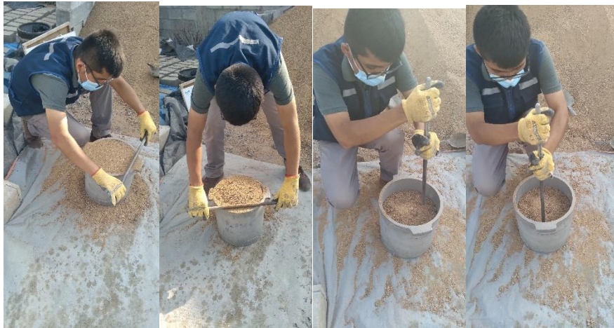
Figura 54: Peso unitario suelto húmedo del agregado grueso natural + recipiente
