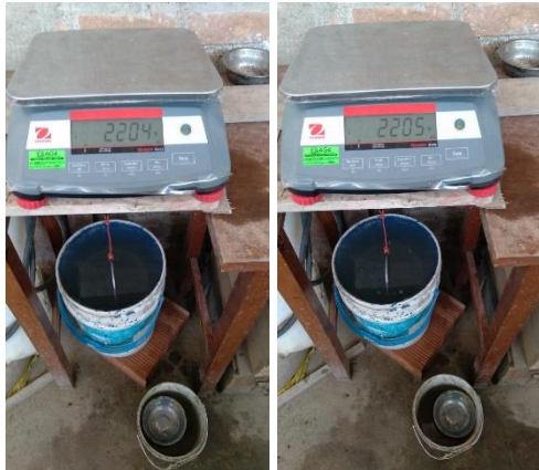
Figura 37: Peso en el agua de las muestras 1 y 2 saturadas + canastilla-agregado grueso natural
