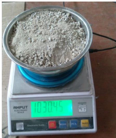
Figura 32: Peso seco del agregado grueso reciclado + recipientes
