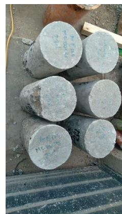
Figura 145: Rotura de probetas con diseño de 100%AR usando cemento GU y MS a los 28 días de curado
