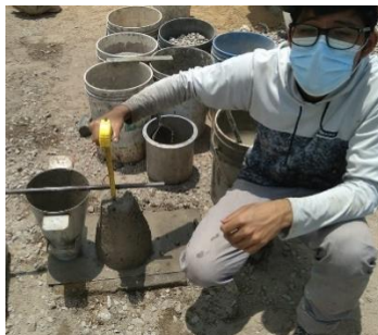
Figura 86: SLUMP de la muestra con reemplazo del 25% de AR usando cemento GU
