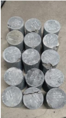
Figura 140: Rotura de probetas con reemplazo de 0%,25%, 50%, 75% y 100%AR usando cemento MS a los 7 días de curado
