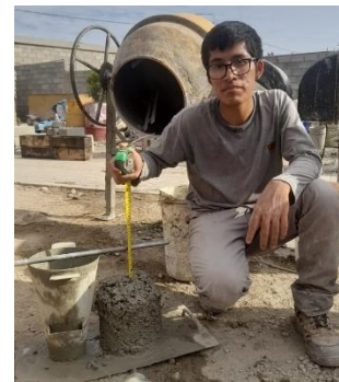
Figura 93: SLUMP de la muestra con reemplazo del 50% de AR usando cemento MS
