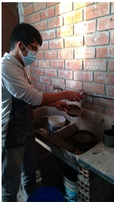
Figura 22: Lavando la muestra de agregado fino reciclado
