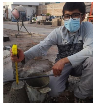
Figura 96: SLUMP de la muestra con diseño del 100% de AR usando cemento MS
