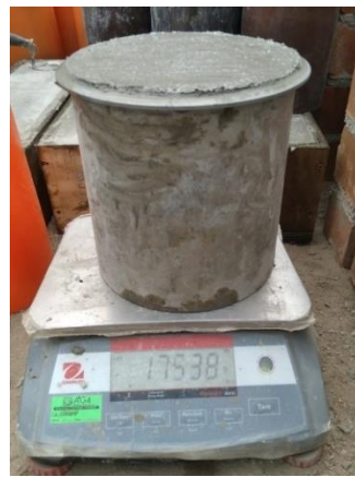
Figura 108: Peso unitario de la muestra con diseño del 100% de AR usando cemento MS
