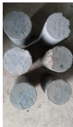
Figura 144: Rotura de probetas con diseño de 100%AR usando cemento GU y MS a los 14 días de curado
