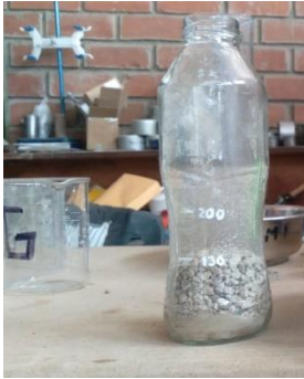
Figura 62: Muestra para el ensayo cualitativo de impurezas orgánicas
