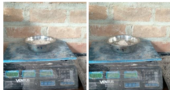
Figura 46: Peso de la muestra saturada superficialmente seca-agregado fino reciclado
