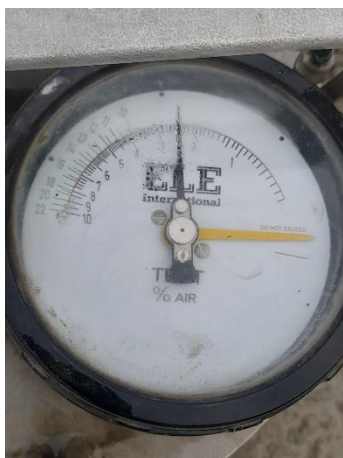
Figura 118: Contenido de aire de la muestra con reemplazo del 75% de AR usando cemento MS
