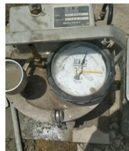
Figura 111: Contenido de aire de la muestra con reemplazo del 50% de AR usando cemento GU
