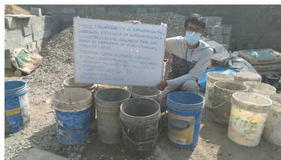
Figura 81: Materiales para tanda de muestra con reemplazo del 100% de AR usando cemento MS
