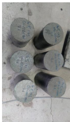
Figura 143: Rotura de probetas con diseño de 100%AR usando cemento GU y MS a los 7 días de curado
