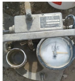
Figura 117: Contenido de aire de la muestra con reemplazo del 50% de AR usando cemento MS
