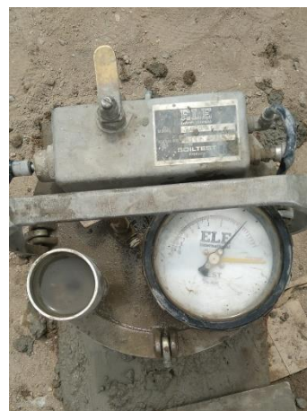
Figura 120: Contenido de aire de la muestra con diseño del 100% de AR usando cemento MS
