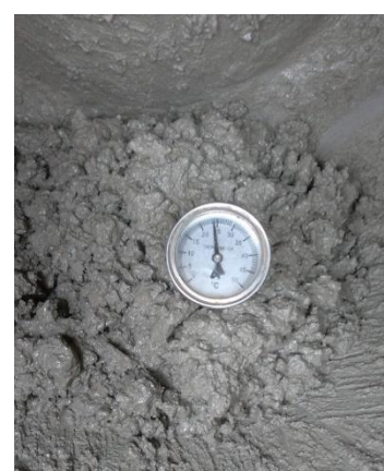
Figura 126: Temperatura de la muestra con diseño del 100% de AR usando cemento GU
