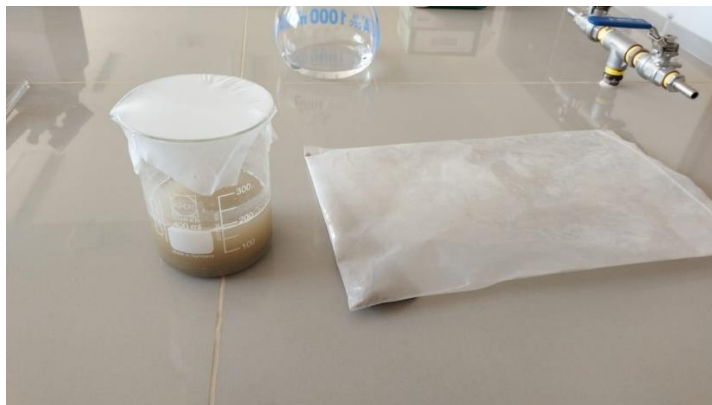
Figura 71: Reposo de la muestra de agregado fino reciclado para el ensayo de cloruros y sulfatos
