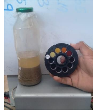
Figura 64: Comparación de la muestra con los vidrios de color Gardner Standard
