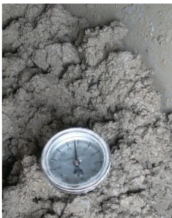
Figura 124: Temperatura de la muestra con reemplazo del 75% de AR usando cemento GU
