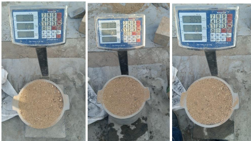
Figura 57: Peso unitario suelto húmedo del agregado fino reciclado + recipiente
