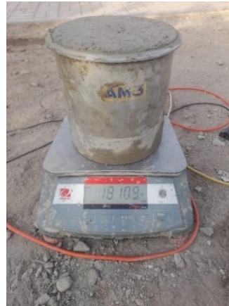
Figura 108: Peso unitario de la muestra con diseño del 100% de AR usando cemento MS
