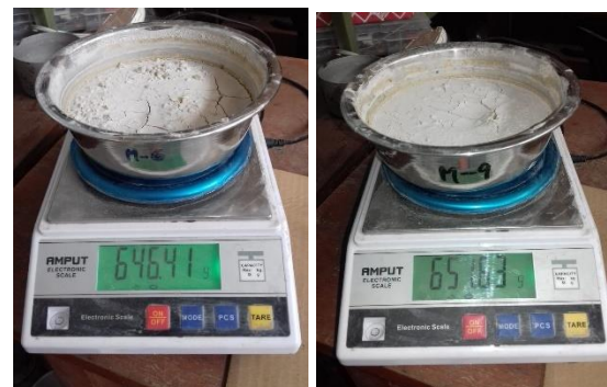
Figura 52: Peso de la muestra seca + recipiente-agregado fino reciclado
