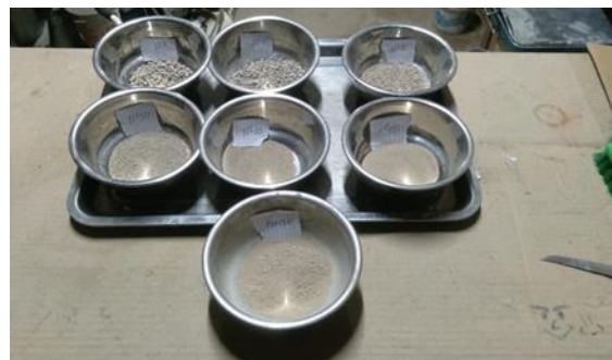
Figura 19: Resultado del tamizado del agregado fino reciclado
