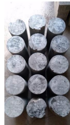
Figura 145: Rotura de probetas con diseño de 100%AR usando cemento GU y MS a los 28 días de curado
