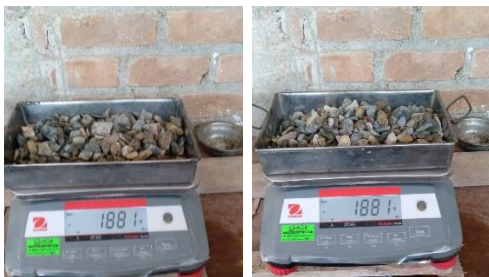
Figura 35: Peso de muestras 1 y 2 saturadas superficialmente secas -agregado grueso natural
