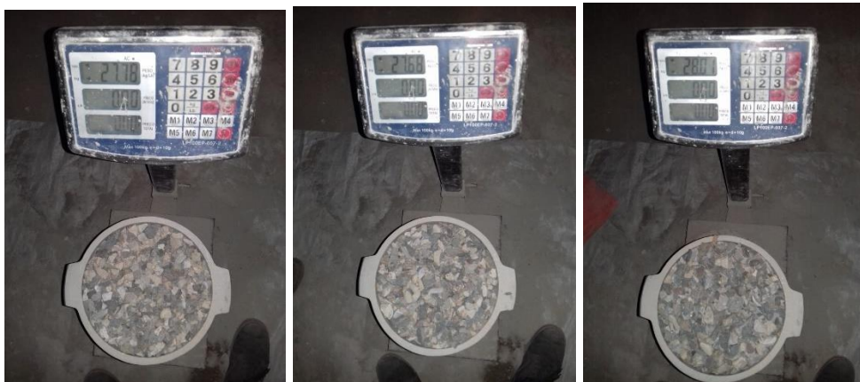
Figura 55: Peso unitario suelto húmedo del agregado grueso reciclado + recipiente
