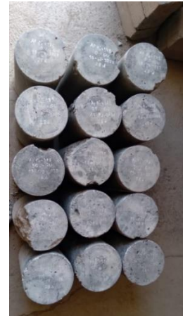
Figura 142: Rotura de probetas con reemplazo de 0%,25%, 50%, 75% y 100%AR usando cemento MS a los 28 días de curado
