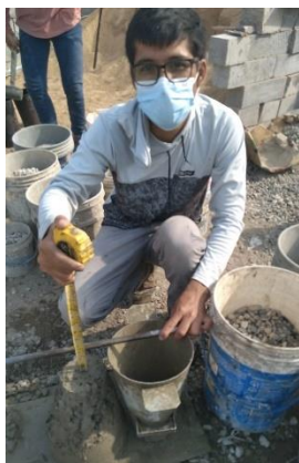
Figura 94: SLUMP de la muestra con reemplazo del 75% de AR usando cemento MS
