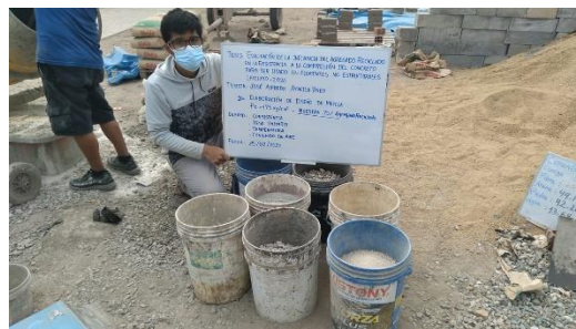
Figura 76: Materiales para tanda de muestra con reemplazo del 100% de AR usando cemento GU
