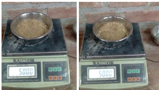
Figura 45: Peso de la muestra saturada superficialmente seca-agregado fino natural
