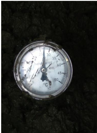
Figura 124: Temperatura de la muestra con reemplazo del 75% de AR usando cemento GU
