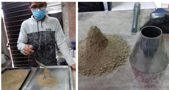
Figura 45: Peso de la muestra saturada superficialmente seca-agregado fino natural
