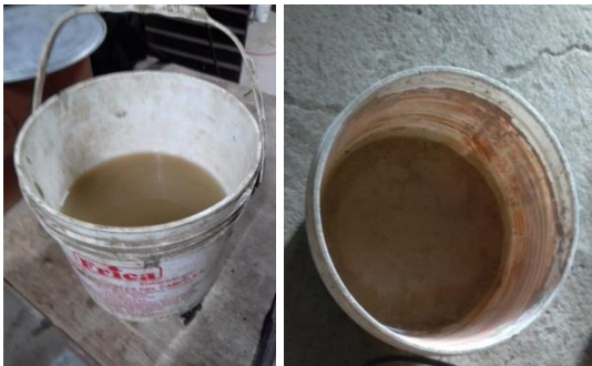
Figura 43: Verificación del estado saturado superficialmente seco de la muestra-agregado fino natural
