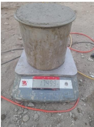
Figura 106: Peso unitario de la muestra con reemplazo del 75% de AR usando cemento MS
