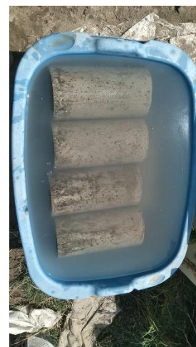
Figura 84: Curado de probetas
