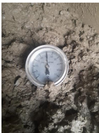
Figura 130: Temperatura de la muestra con reemplazo del 75% de AR usando cemento MS
