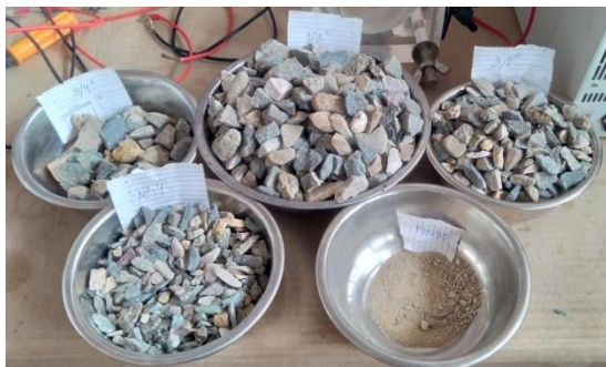
Figura 20: Resultado del tamizado del agregado grueso natural
