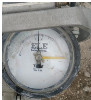
Figura 116: Contenido de aire de la muestra con reemplazo del 25% de AR usando cemento MS
