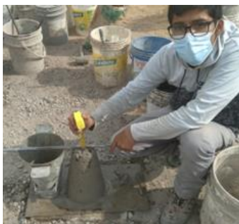
Figura 91: SLUMP de la muestra patrón usando cemento MS
