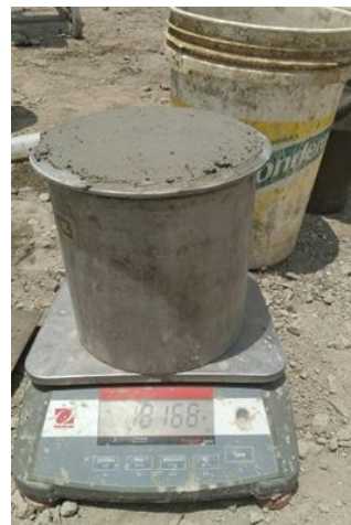
Figura 99: Peso unitario de la muestra con reemplazo del 50% de AR usando cemento GU
