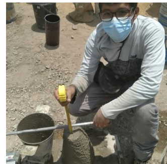
Figura 87: SLUMP de la muestra con reemplazo del 50% de AR usando cemento GU
