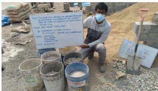
Figura 76: Materiales para tanda de muestra con reemplazo del 100% de AR usando cemento GU
