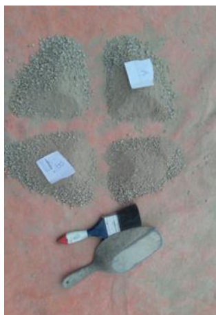
Figura 16: Cuarteo para elección de la muestra a tamizar-agregado fino reciclado
