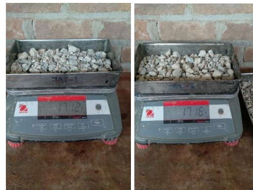
Figura 40: Peso en el agua de las muestras 1 y 2 secas + recipiente-agregado grueso reciclado
