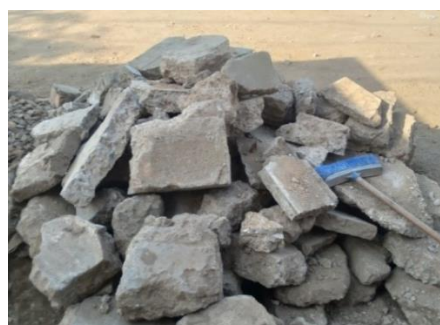
Figura 7: Trituración del concreto reciclado almacenado
