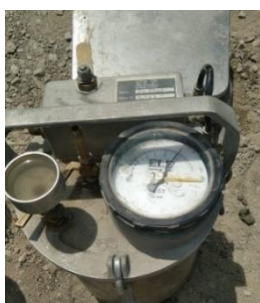
Figura 109: Contenido de aire de la muestra patrón usando cemento GU
