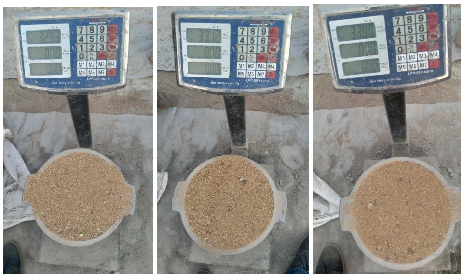
Figura 61: Peso unitario compactado húmedo del agregado fino reciclado + recipiente
