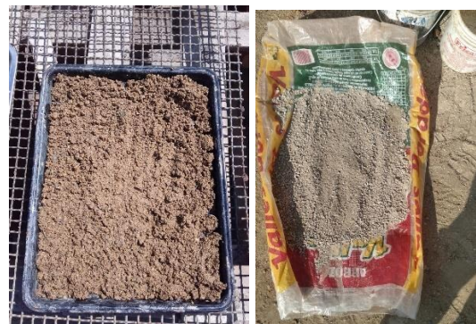
Figura 44: Verificación del estado saturado superficialmente seco de la muestra-agregado fino reciclado
