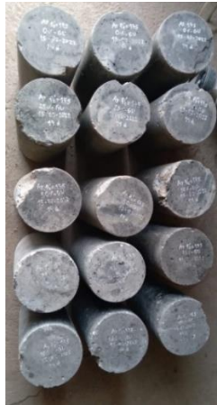
Figura 141: Rotura de probetas con reemplazo de 0%,25%, 50%, 75% y 100%AR usando cemento MS a los 14 días de curado
