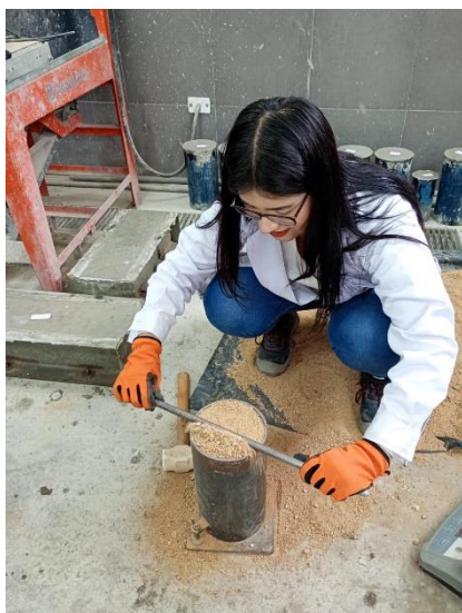
Ilustración 18: Enrasado del espécimen de agregado fino
