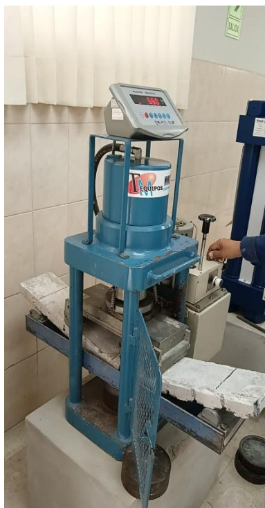
Ilustración 66: Fractura de espécimen 2 para ensayo a flexión a 7 días de DG
