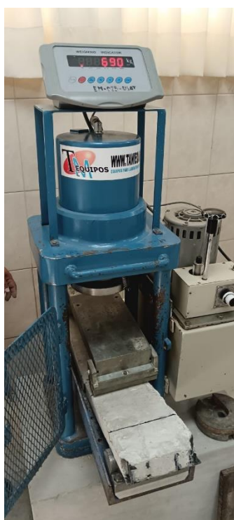
Ilustración 70: Fractura de espécimen 1 para ensayo a flexión a 14 días de DG
