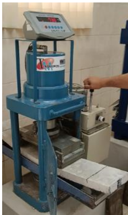
Ilustración 79 Fractura de espécimen 2 para ensayo a flexión a 28 días de TPU
