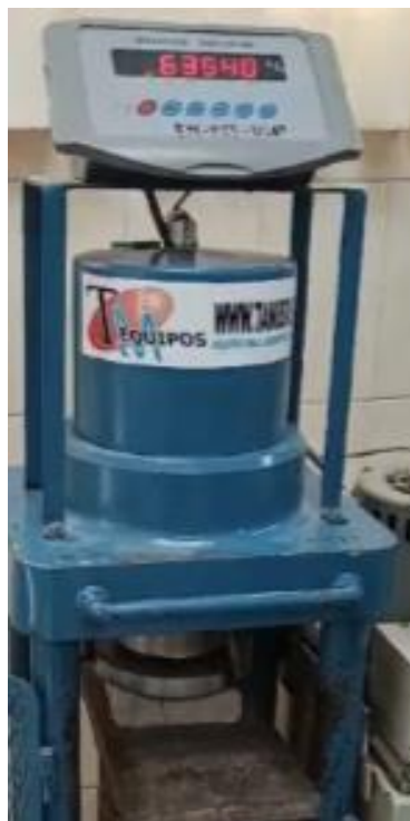
Ilustración 55: Rotura de probeta 1 para ensayo a compresión a 28 días de TPU
