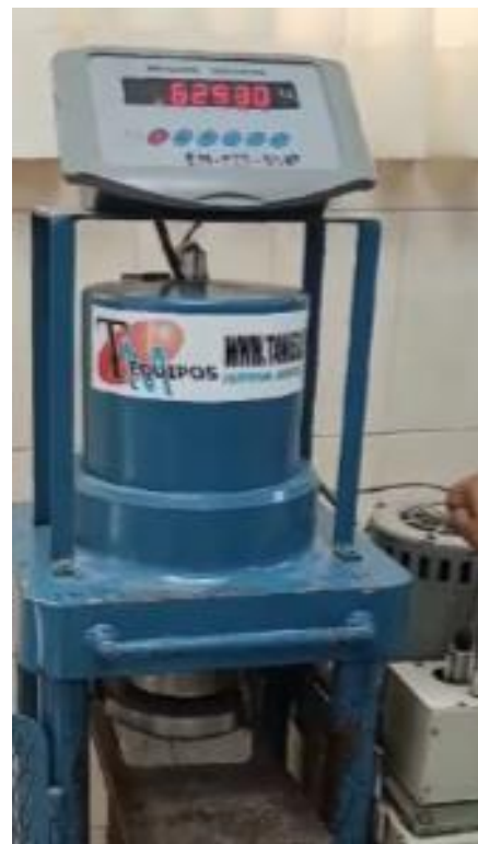
Ilustración 51: Rotura de probeta 2 para ensayo a compresión a 14 días de TPU
