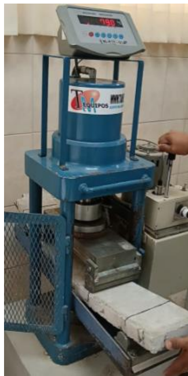
Ilustración 81: Fractura de espécimen 3 para ensayo a flexión a 28 días de TPU
