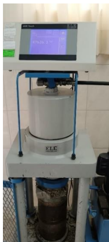
Ilustración 42: Rotura de probeta 1 para ensayo a compresión a 7 días de DG
