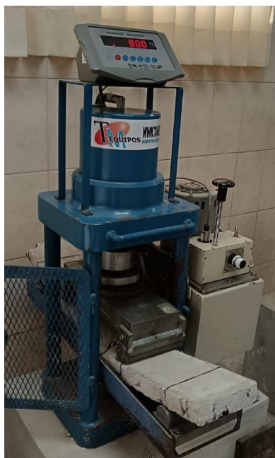
Ilustración 74: Fractura de espécimen 3 para ensayo a flexión a 14 días de DG
