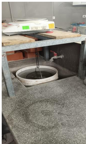
Ilustración 23: Muestra de confitillo en canastilla sumergida en agua
