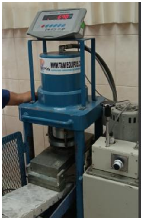
Ilustración 78: Fractura de espécimen 2 para ensayo a flexión a 28 días de DG
