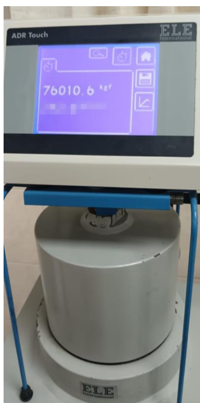
Ilustración 50: Rotura de probeta 2 para ensayo a compresión a 14 días de DG
