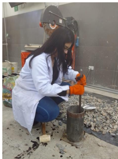
Ilustración 19: Varillado del espécimen de confitillo
