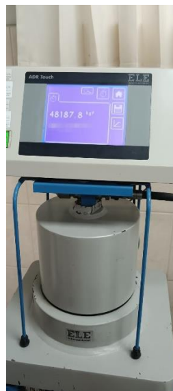
Ilustración 47: Rotura de probeta 3 para ensayo a compresión a 7 días de TPU
