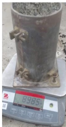
Ilustración 18: Enrasado del espécimen de agregado fino
