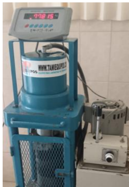
Ilustración 55: Rotura de probeta 1 para ensayo a compresión a 28 días de TPU
