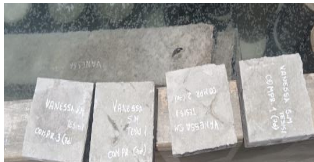
Ilustración 43: Rotura de probeta 1 para ensayo a compresión a 7 días de TPU
