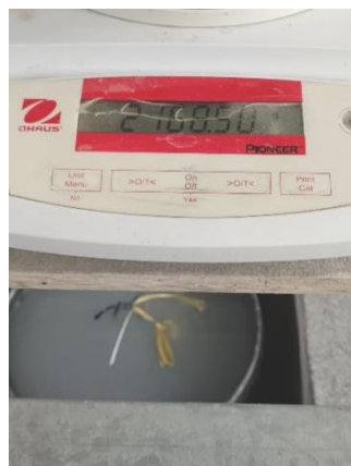
Ilustración 25: Peso de canastilla más confitillo sumergido en agua
