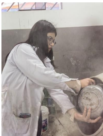
Ilustración 38: Realización de la mezcla de concreto en trompo
