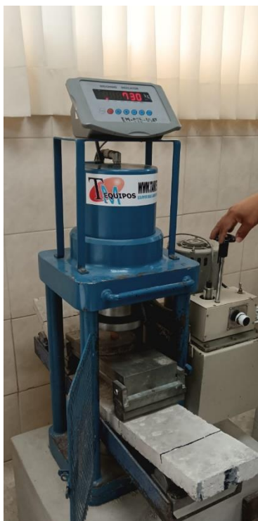
Ilustración 74: Fractura de espécimen 3 para ensayo a flexión a 14 días de DG
