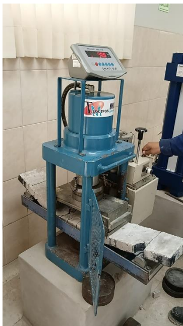
Ilustración 70: Fractura de espécimen 1 para ensayo a flexión a 14 días de DG
