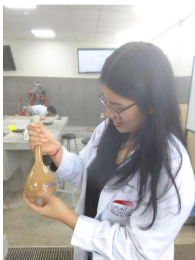
Ilustración 24: Muestra sin burbujas a reposar por 24h
