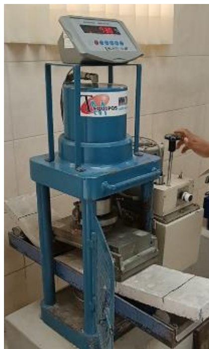
Ilustración 71: Fractura de espécimen 1 para ensayo a flexión a 14 días de TPU
