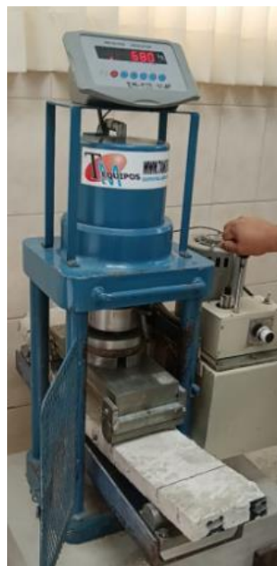
Ilustración 65: Fractura de espécimen 1 para ensayo a flexión a 7 días de TPU
