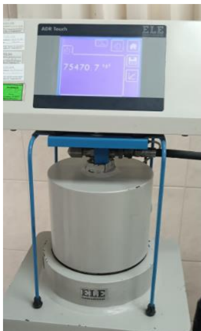
Ilustración 50: Rotura de probeta 2 para ensayo a compresión a 14 días de DG
