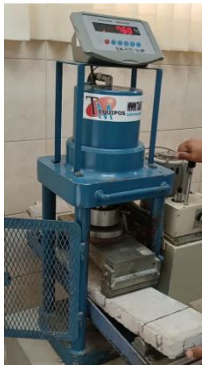
Ilustración 73: Fractura de espécimen 2 para ensayo a flexión a 14 días de TPU
