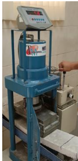
Ilustración 71: Fractura de espécimen 1 para ensayo a flexión a 14 días de TPU
