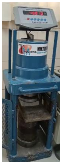
Ilustración 44: Rotura de probeta 2 para ensayo a compresión a 7 días de DG
