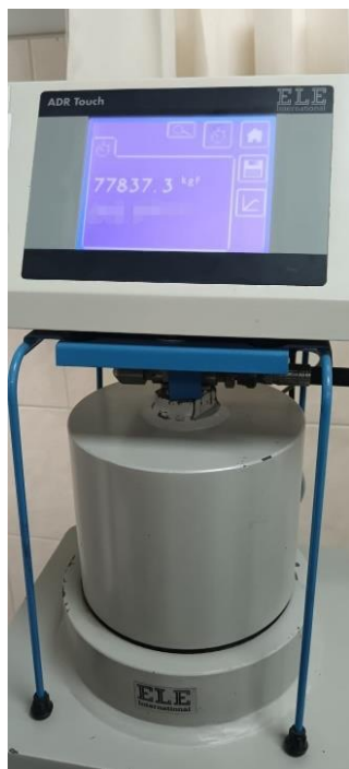
Ilustración 54: Rotura de probeta 1 para ensayo a compresión a 28 días de DG
