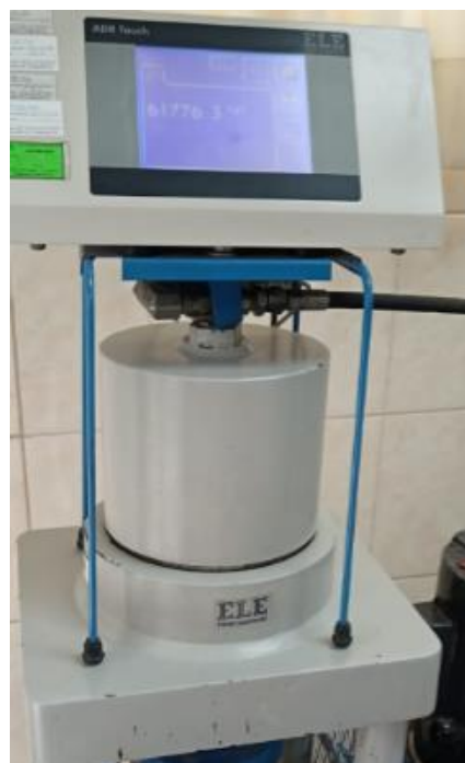
Ilustración 51: Rotura de probeta 2 para ensayo a compresión a 14 días de TPU
