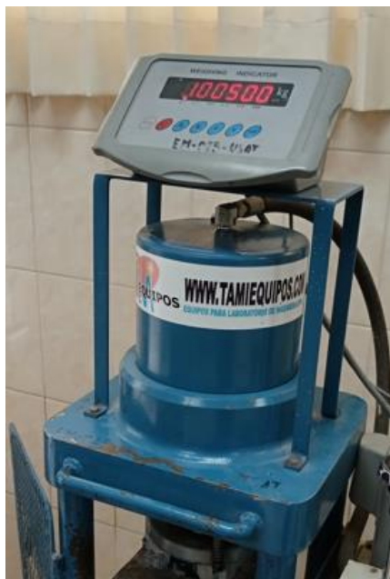
Ilustración 58: Rotura de probeta 3 para ensayo a compresión a 28 días de DG
