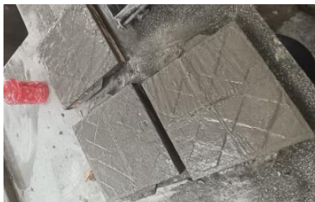
Ilustración 40: Llenado de especímenes para prueba a compresión
