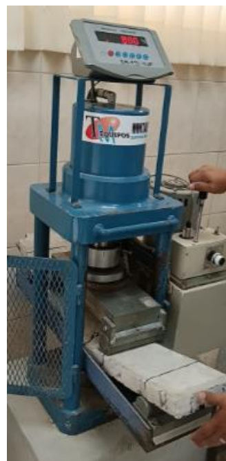
Ilustración 75: Fractura de espécimen 3 para ensayo a flexión a 14 días de TPU
