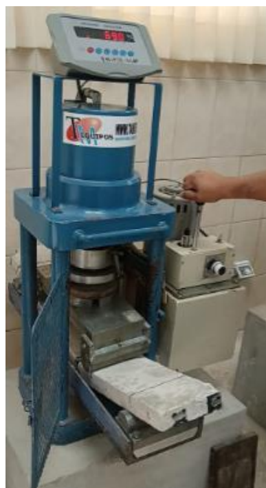
Ilustración 67: Fractura de espécimen 2 para ensayo a flexión a 7 días de TPU
