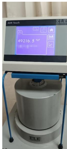
Ilustración 45: Rotura de probeta 2 para ensayo a compresión a 7 días de TPU
