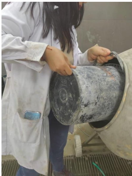
Ilustración 60: Elaboración del concreto utilizando una mezcladora rotatoria
