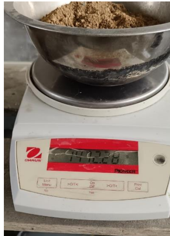
Ilustración 31: Muestra al horno de confitillo en estado seco
