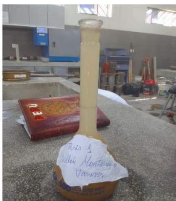
Ilustración 24: Muestra sin burbujas a reposar por 24h
