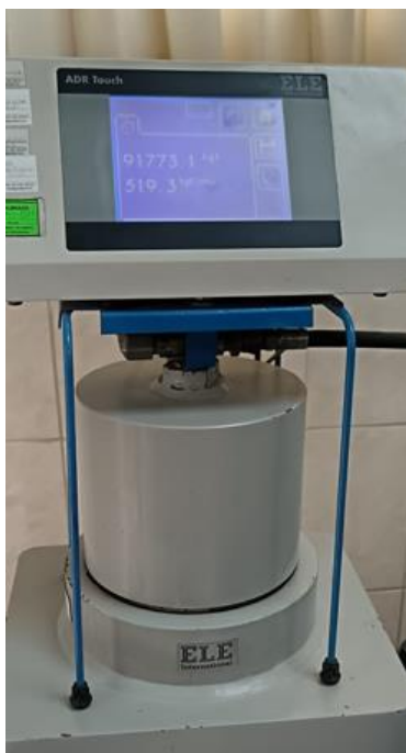
Ilustración 54: Rotura de probeta 1 para ensayo a compresión a 28 días de DG
