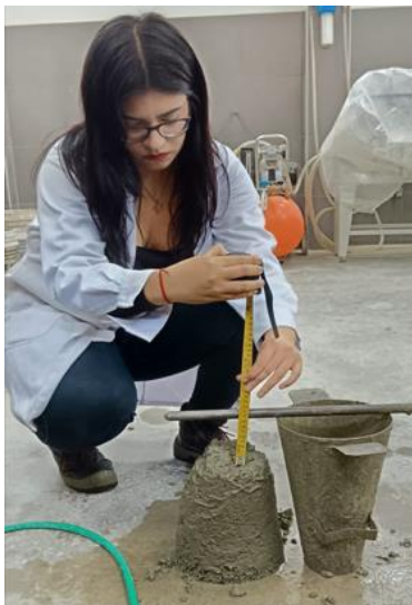
Ilustración 32: Prueba de trabajabilidad con el dispositivo de Abrams
