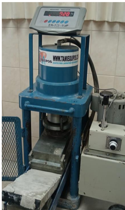
Ilustración 78: Fractura de espécimen 2 para ensayo a flexión a 28 días de DG
