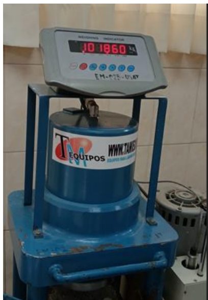
Ilustración 58: Rotura de probeta 3 para ensayo a compresión a 28 días de DG
