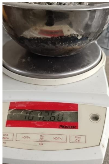
Ilustración 31: Muestra al horno de confitillo en estado seco
