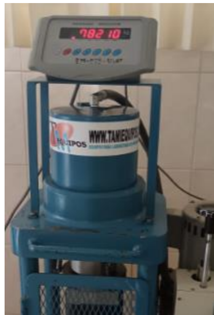
Ilustración 57: Rotura de probeta 2 para ensayo a compresión a 28 días de TPU
