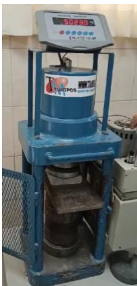
Ilustración 46: Rotura de probeta 3 para ensayo a compresión a 7 días de DG
