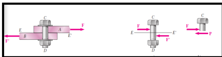
Ilustración 27: Perno sometido a cortante simple Fuente: Mecánica de materiales, Beer, F. et al., McGraw-Hill, 2013
