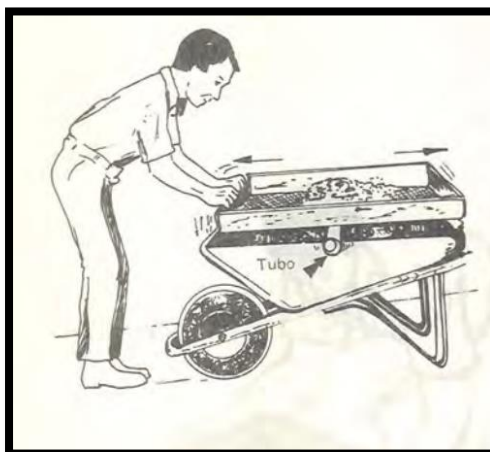
Ilustración 4: Personal de obra cerniendo arena sobre un rodillo
