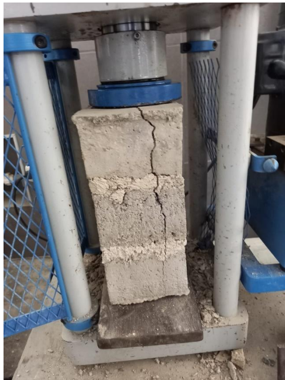
Ilustración 32 Grieta vertical en la muestra de 10% cca + 4% prt.
