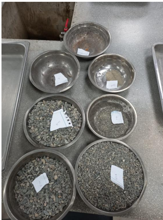
Ilustración 12 Después de tamizar, el confitillo clasificado según por donde pasa el tamiz.
