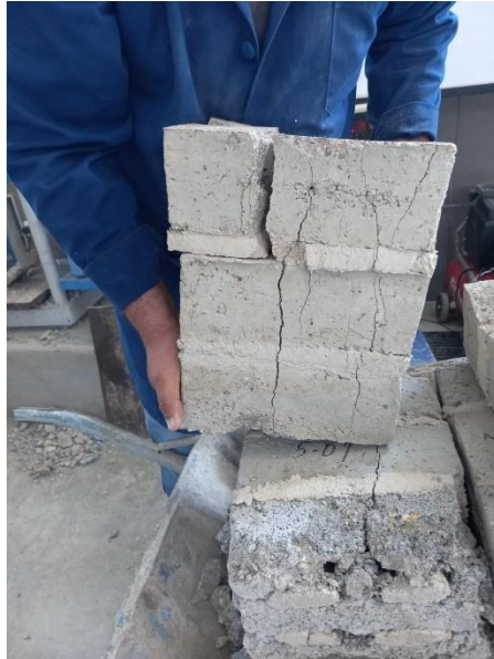
Ilustración 31 Grieta vertical en la muestra de 5% cca + 0% prt.
