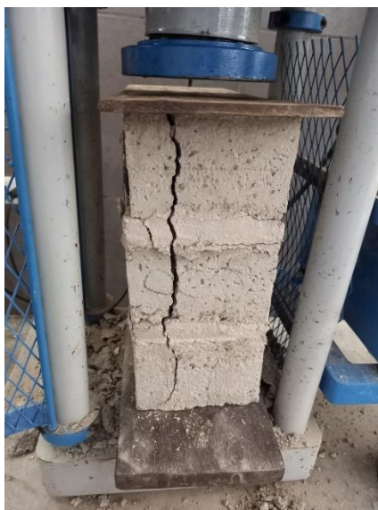
Ilustración 30 Grieta vertical en la muestra de 10% cca + 0% prt.
