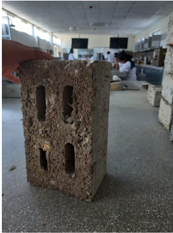
Ilustración 36 Ladrillo con 10% de cca y 7% plástico triturado.
