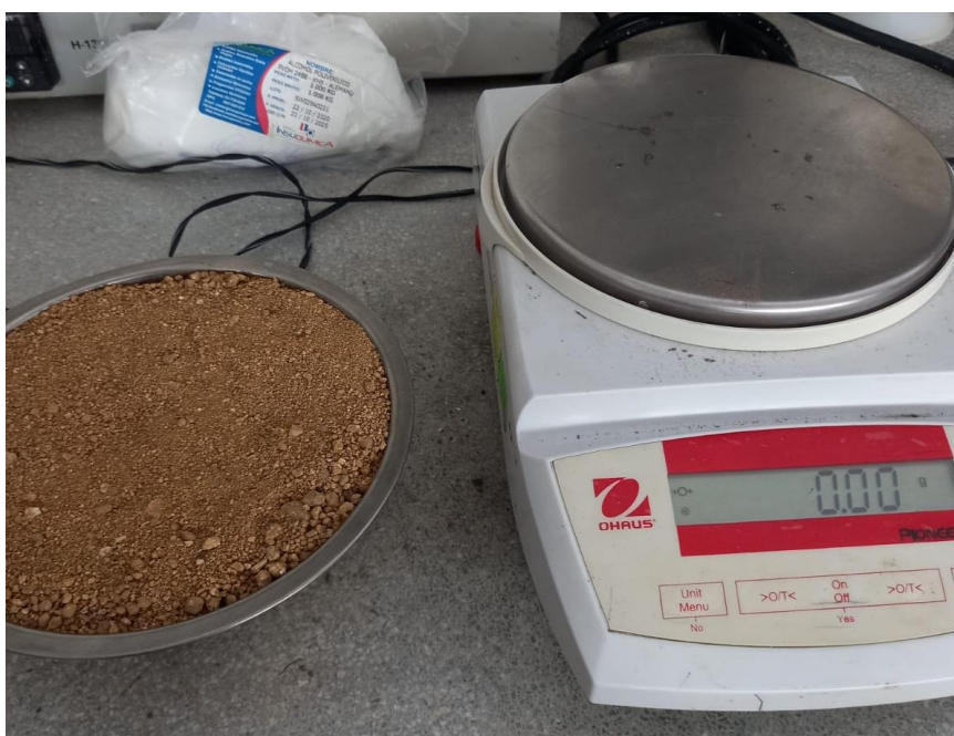
Ilustración 11 Arena para el ensayo del análisis granulométrico.
