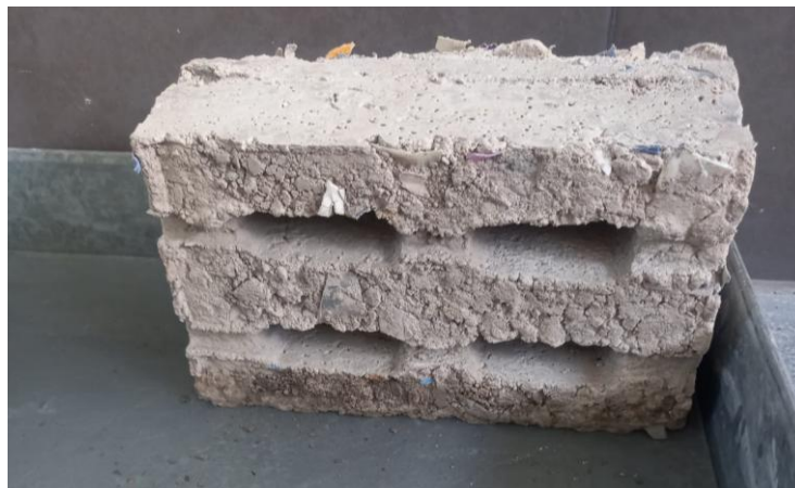
Ilustración 25 Un ladrillo propuesto en el ensayo de succión, ubicada en una bandeja con agua a un nivel de 3 mm.
