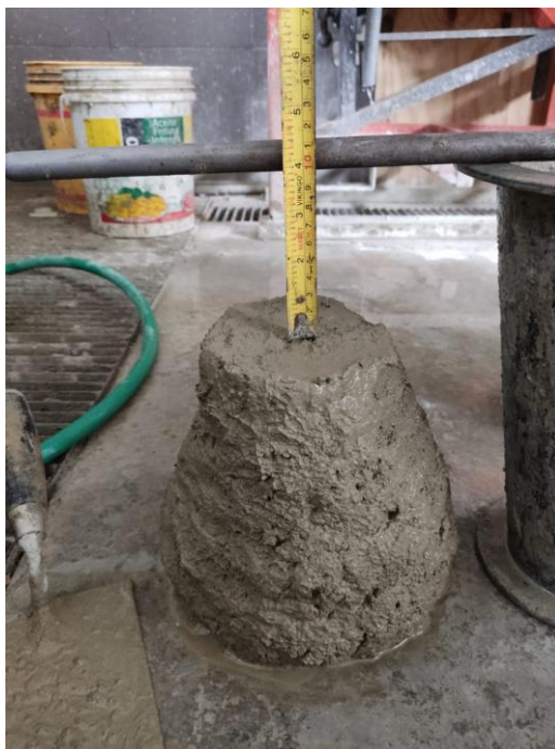
Ilustración 17 Asentamiento del concreto, 4" pulgadas.
