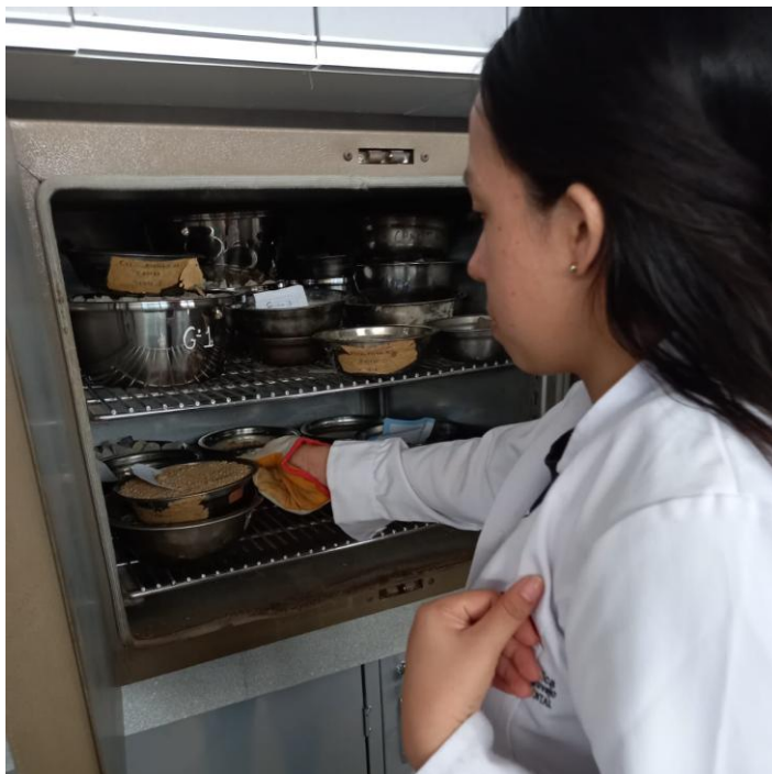
Ilustración 15 Ensayo de contenido de humedad, la muestra es llevada al horno.
