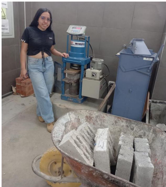
Ilustración 22 Ensayo de resistencia de compresión para cada ladrillo.
