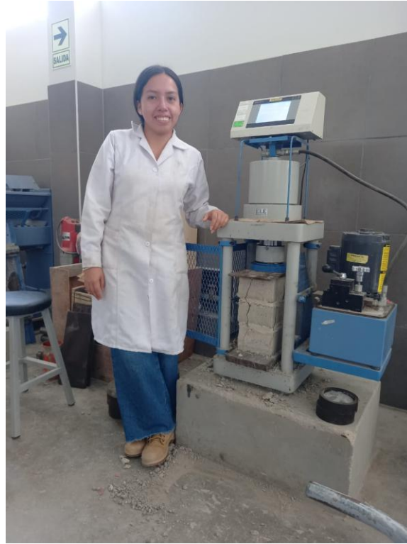
Ilustración 38 Ensayo de pilas.
