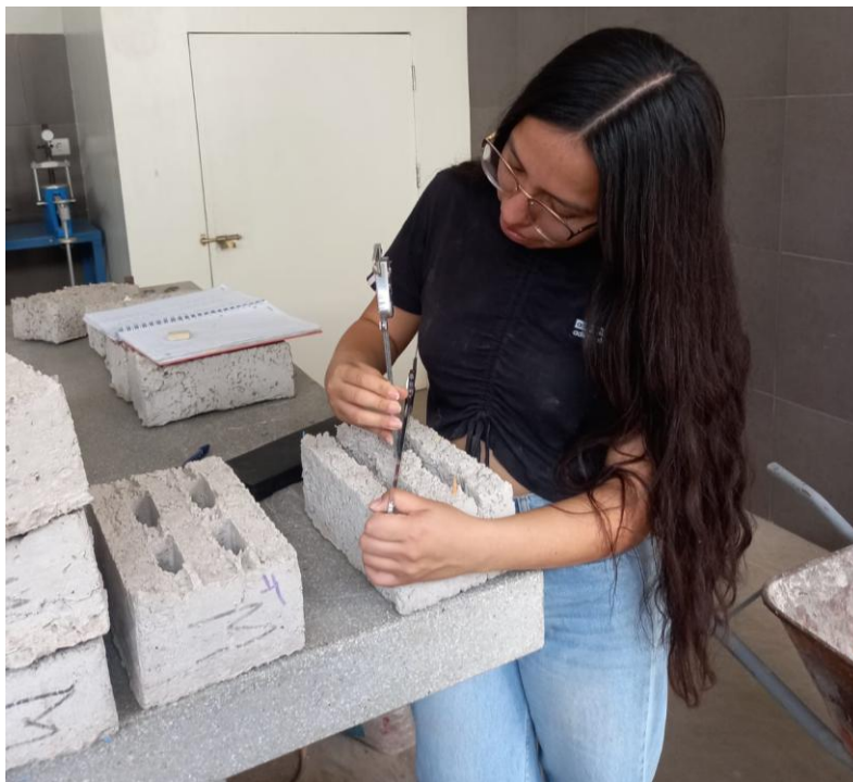
Ilustración 24 Ensayo de alabeo para cada ladrillo.
