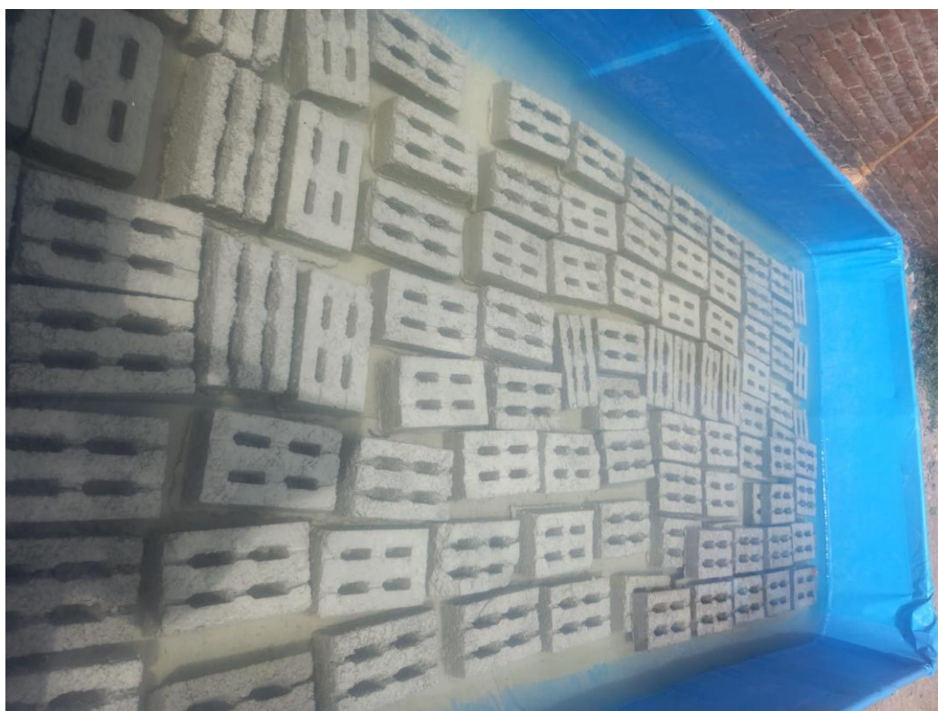
Ilustración 10 Piscina adaptada para el curado de ladrillos.
