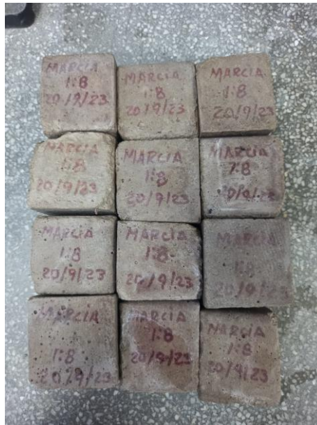
Ilustración 26 Los 12 cubitos de mortero para el ensayo de resistencia de compresión del mismo.
