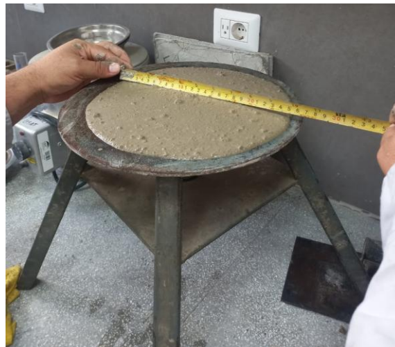
Ilustración 27 Medición del diámetro para la fluidez del mortero.
