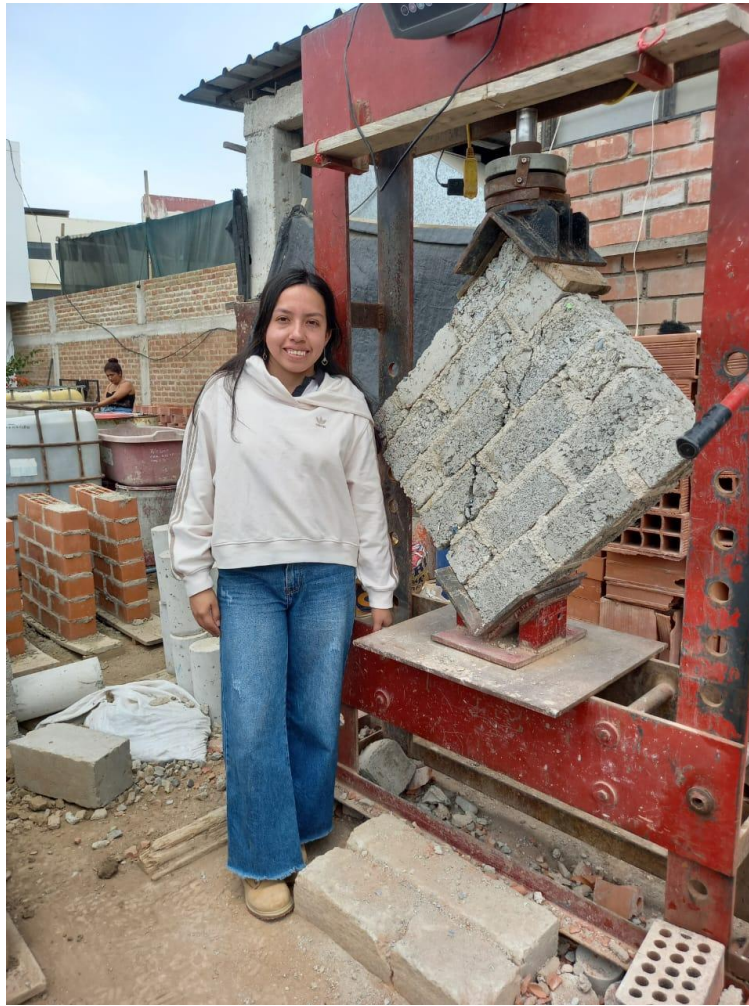
Ilustración 40 Ensayo para el murete.
