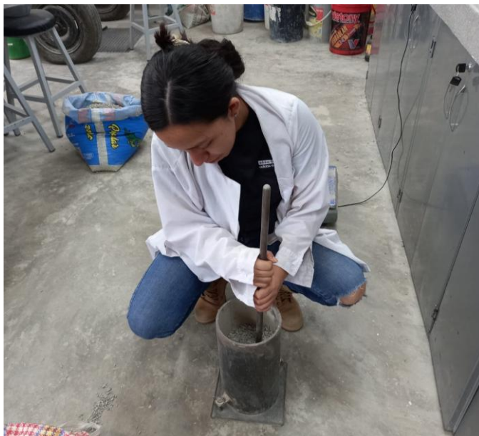
Ilustración 13 Ensayo del peso unitario.
