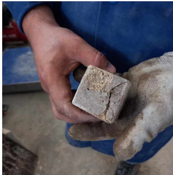
Ilustración 37 Resistencia de compresión para el mortero.
