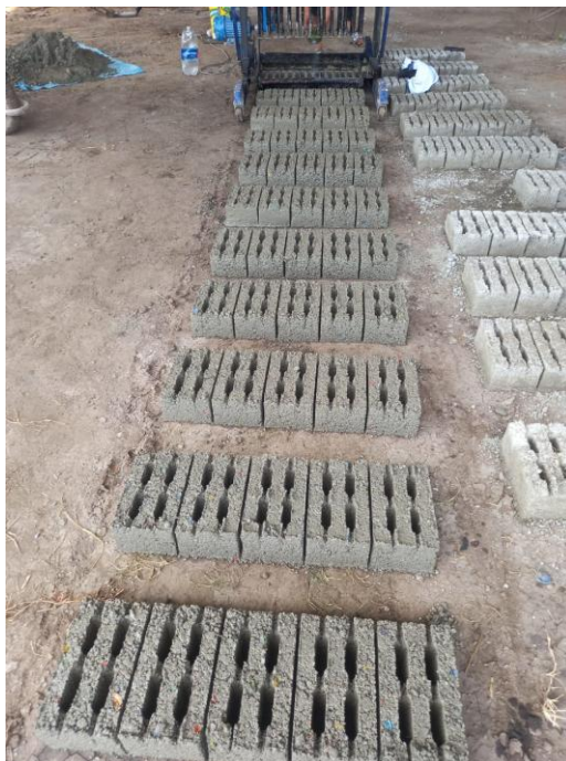
Ilustración 33 Elaboración de ladrillos de concreto, el cual contiene 5% de ceniza de cascarilla de arroz y 7% de plástico triturado reciclado.
