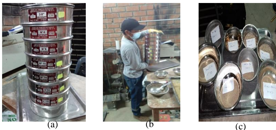
Figura 12: Ensayo Análisis Granulométrico por Tamizado del Agregado Fino: a) Tamices; b) Zarandeo en los tamices; c) Partículas finas de arena retenidos en los tamices
