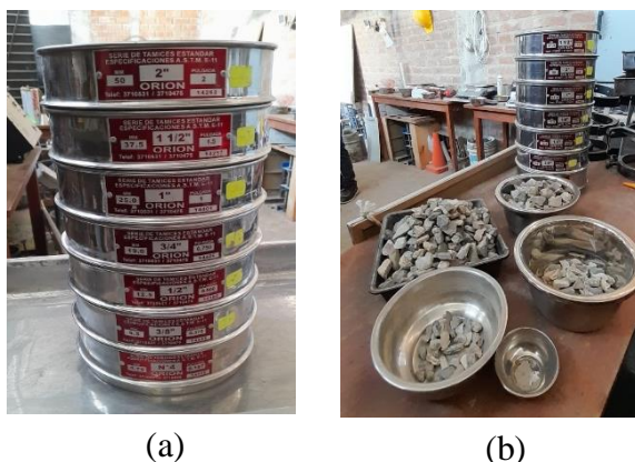
Figura 16: Análisis Granulométrico por tamizado del agregado grueso: a) Tamices; y b) Partículas de piedra que queden retenidos en los tamices
