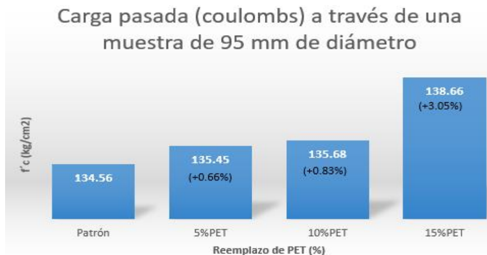
Figura 34: Gráfico de barras comparativo de la carga eléctrica pasada (C) en las muestras de 28 días de curado de los testigos de concreto con y sin sustitución de arena
