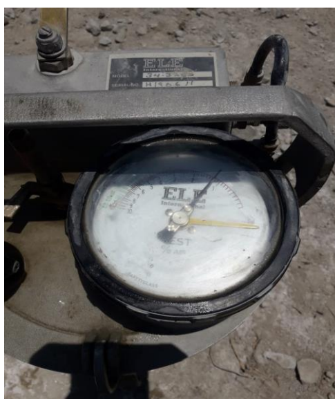
Figura 20: Determinación del Contenido de Aire en Mezclas Frescas
