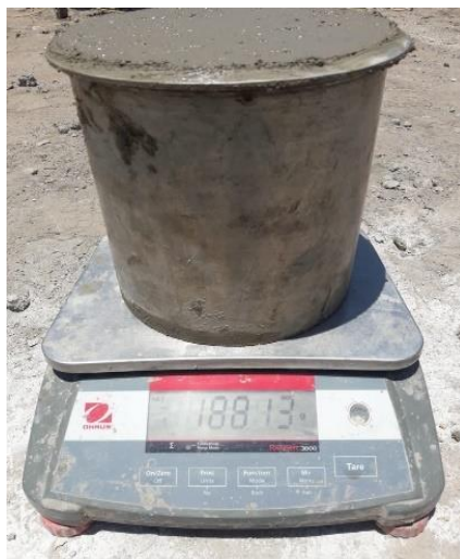
Figura 19: Ensayo para Determinar la Densidad: Registro del Peso Unitario
