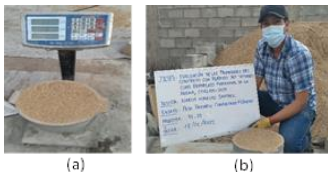
Figura 10: Ensayo Peso Unitario Compactado Húmedo: a) Registro del peso de la muestra; b) Culminación del ensayo
