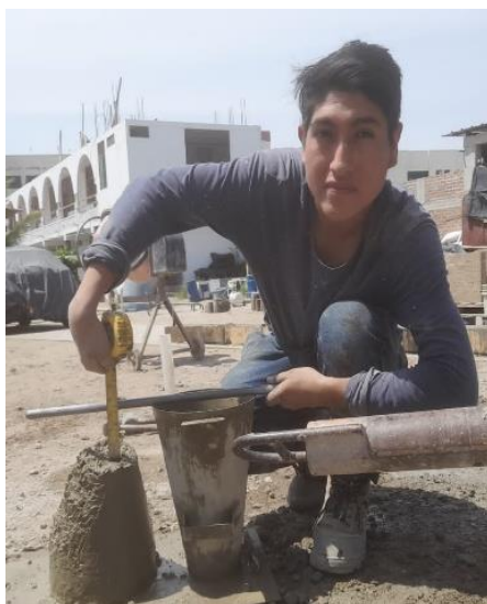
Figura 21: Medición del Asentamiento del Concreto de Cemento Portland
