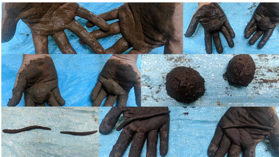
Figura 5: Realización de ensayos de campo para la identificación de suelos
