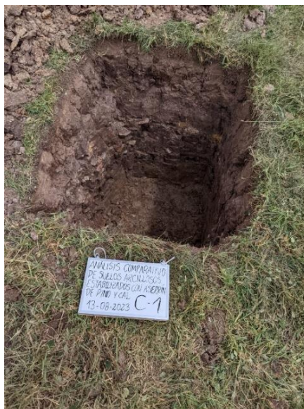
Figura 6: Método de la Calicata.
