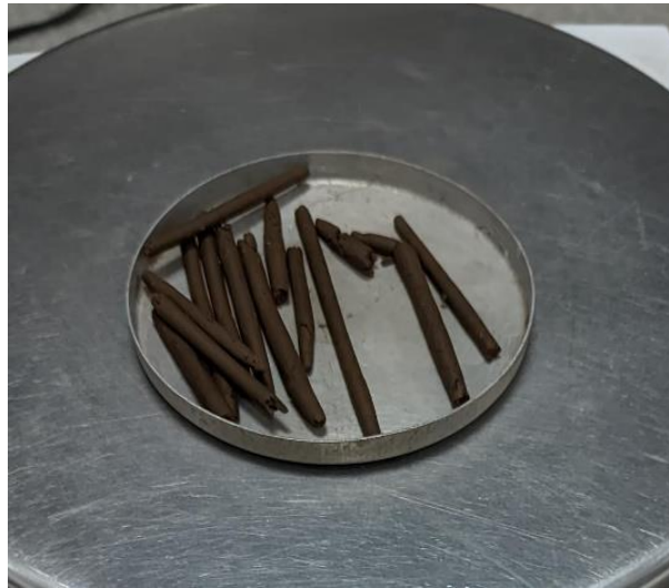
Figura 18: Rollos de 3.2 mm para el límite plástico
