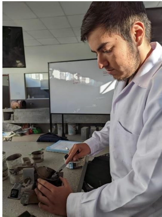
Figura 17: Uso de la Copa Casagrande para límites de Atterberg
