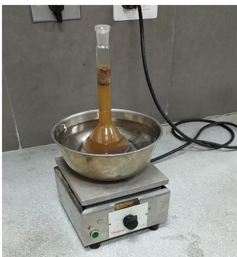
Figura 14: Ebullición para liberar aire
