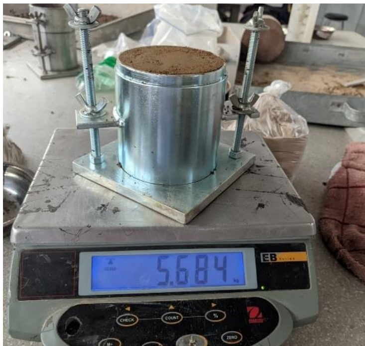
Figura 22: Enrazado y pesado del molde con la muestra compactada
