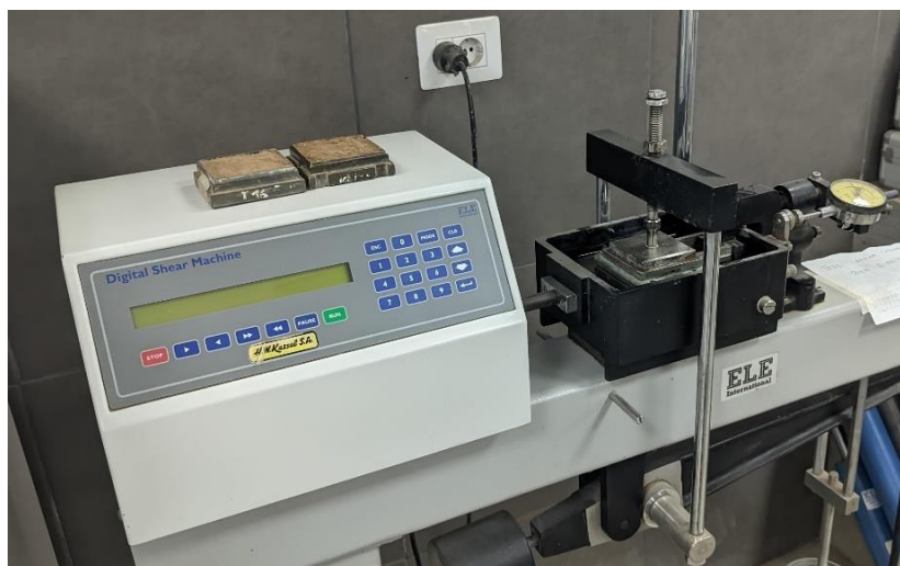
Figura 26: Muestras de suelo consolidada para corte
