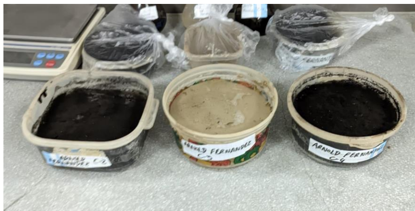
Figura 16: Muestras saturadas para límites de Atterberg
