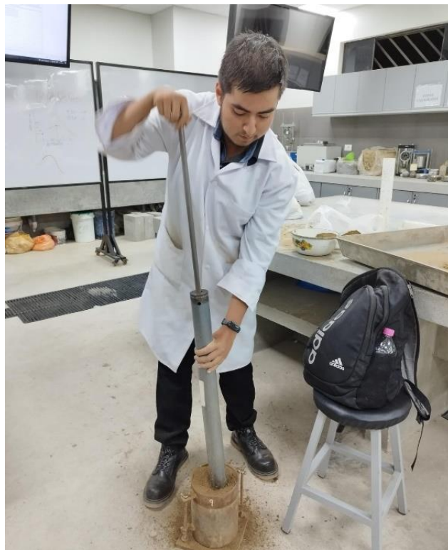
Figura 24: Compactación de suelo para CBR
