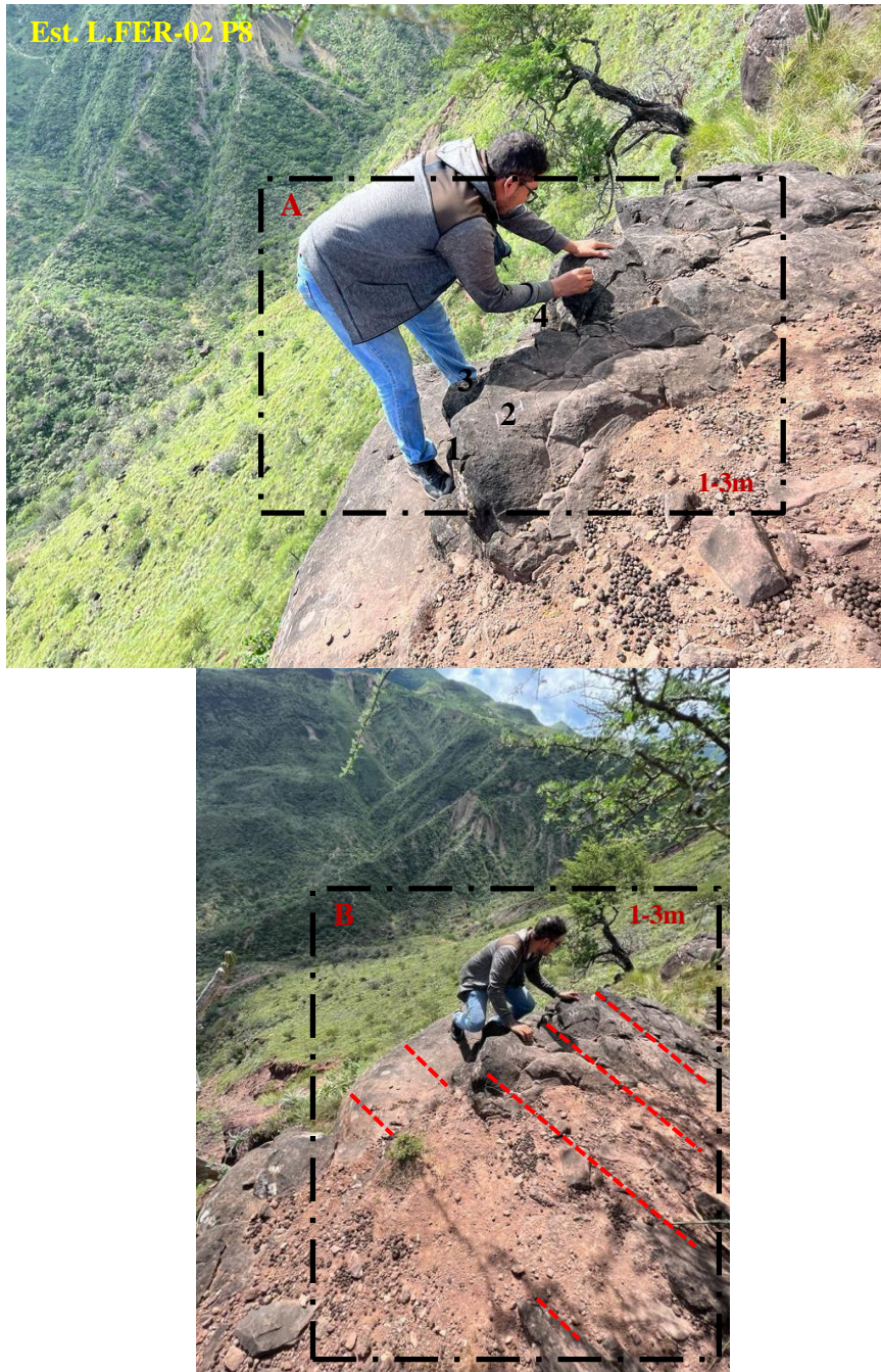
Ilustración 26. Mapeo en celdas y altitud de la estación geomecánica para la toma de datos estructurales, Est. L.FER-02. P8
