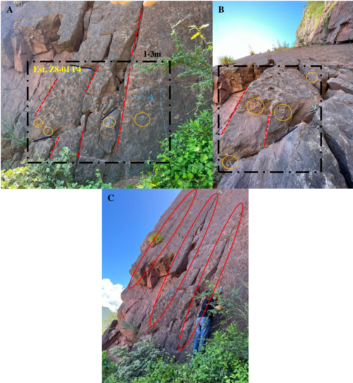
Ilustración 22 Mapeo en celdas, para la toma de datos estructurales, Est. Z8-01 P4
