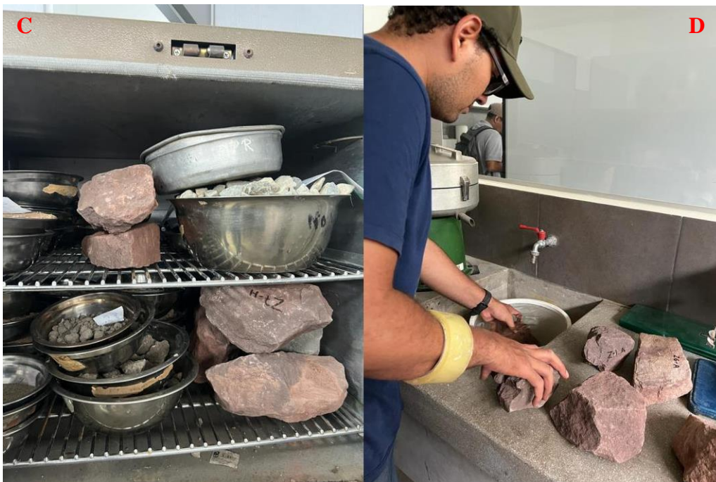
Ilustración 36.. muestra puesta en horno y sumergida.
