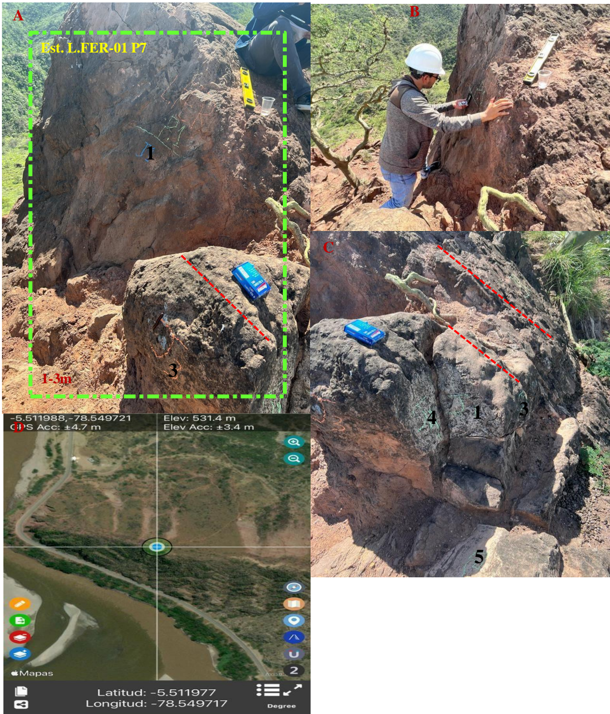
Ilustración 25 Mapeo en celdas y altitud de la estación geomecánica para la toma de datos estructurales, Est. L.FER-01.P7
