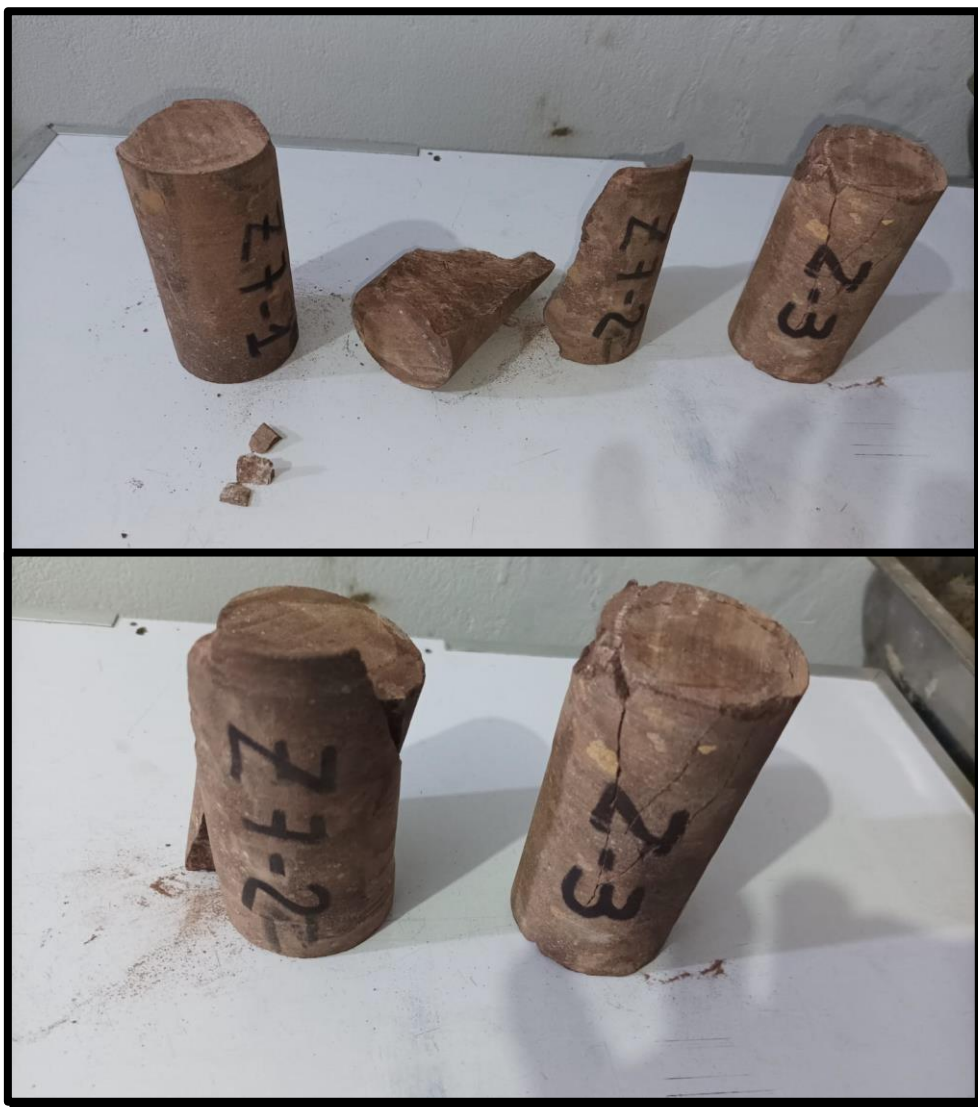
ANEXO 11. núcleos codificados ensayados (ensayo triaxial).
