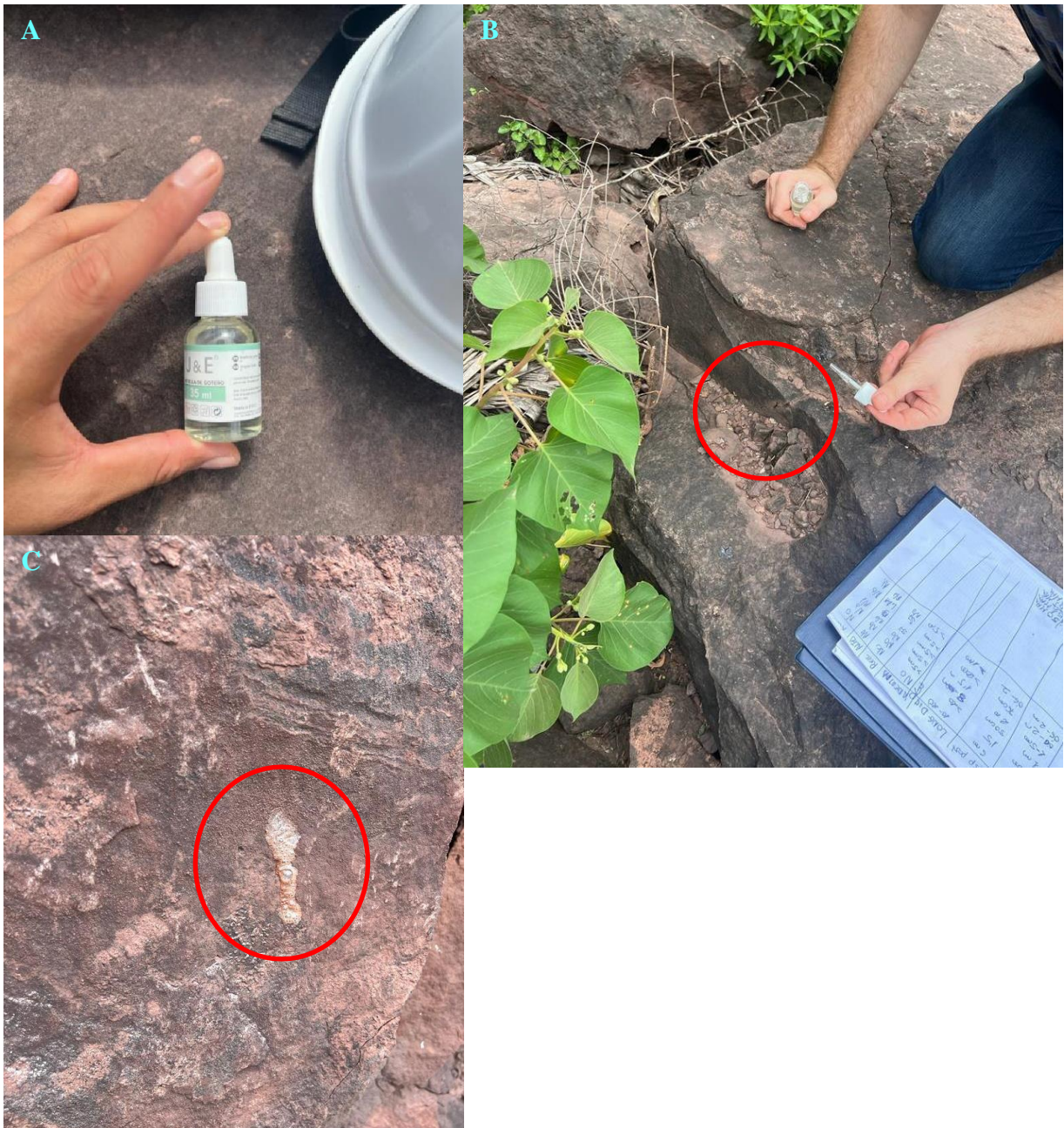
Ilustración 30. Prueba de ácido clorhídrico.
