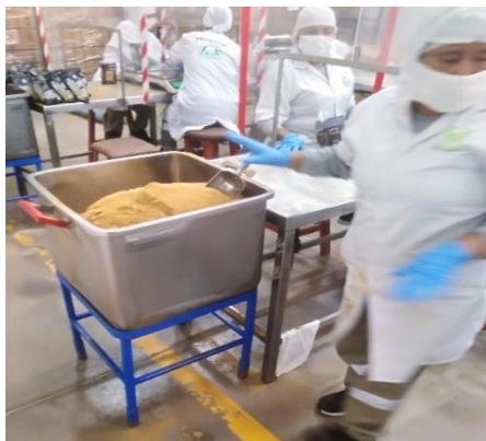
Figura 28. Tolva de recepción de panela
