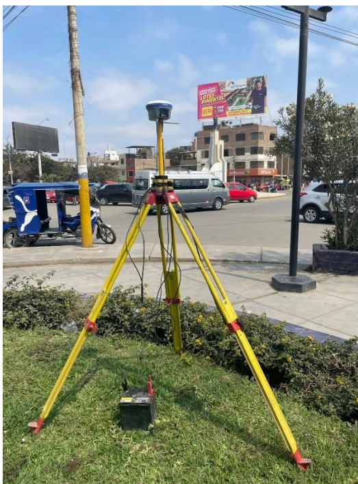
Ilustración 59: GPS Diferencial Trimble R8S
